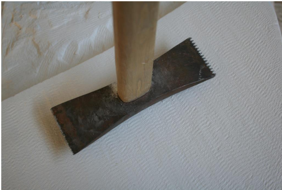
Slika 163. Martelina i tragovi marteline, fotografija: Josipa Krolo
