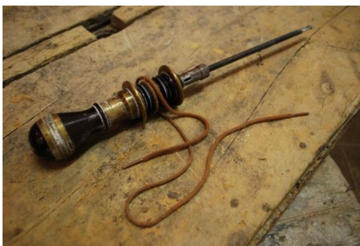
Sl. 71. Ručna bušilica s užadi
