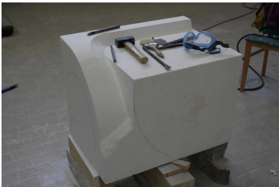
Slika 157. Nastavak klesanja zupčastim dlijetom, fotografija: Josipa Krolo
