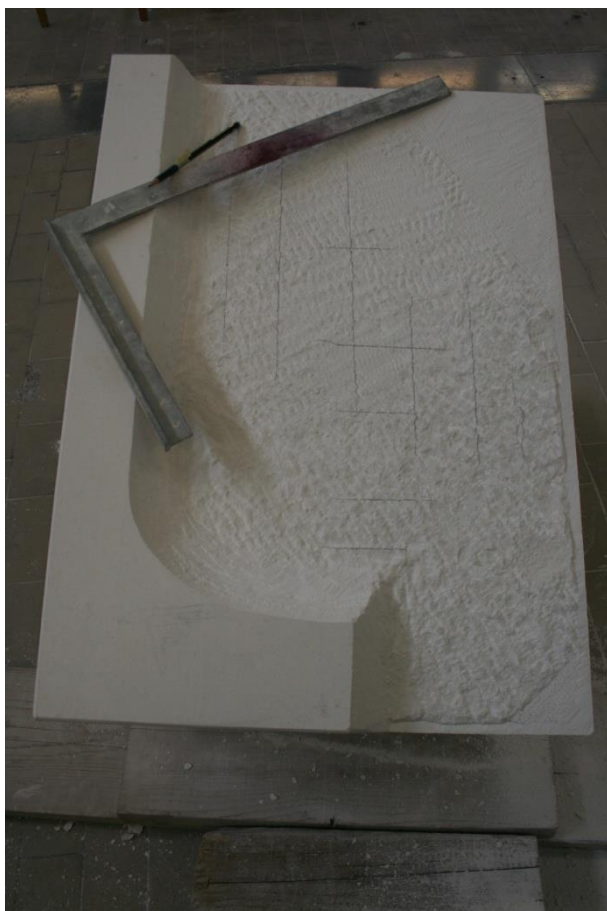
Slika 149. Označavanje viškova mase, fotografija: Josipa Krolo
