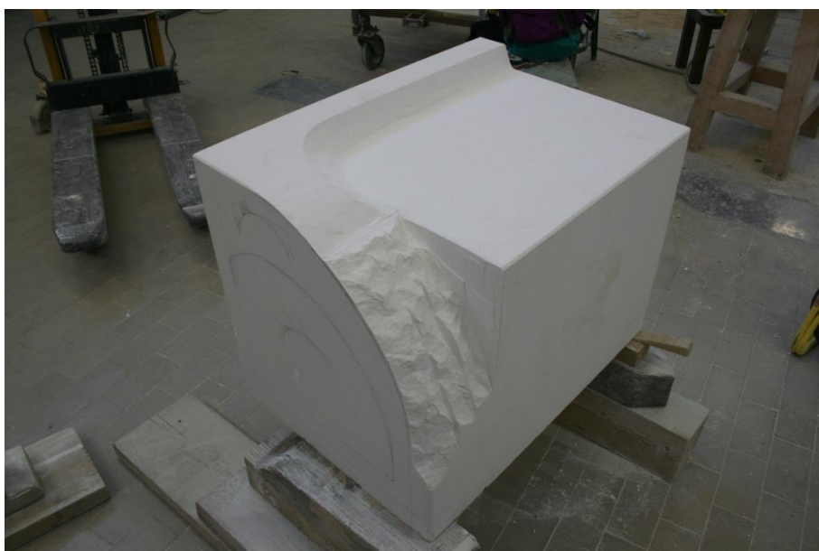
Slika 156. Zapilana kamena masa odlomljena odbijačem, fotografija: Josipa Krolo
