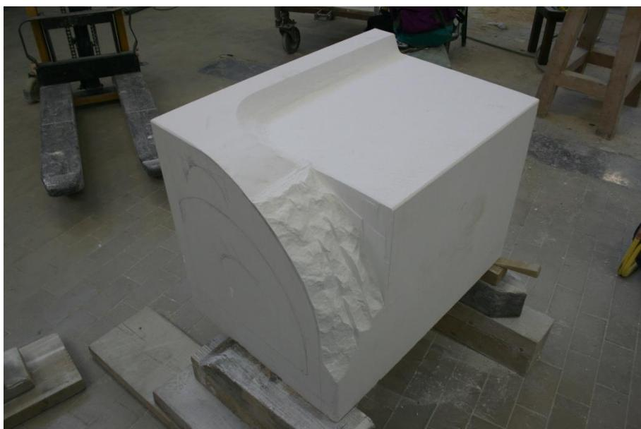
Slika 156. Zapilana kamera masa odlomljena odbijačem, fotografija: Josipa Krolo
