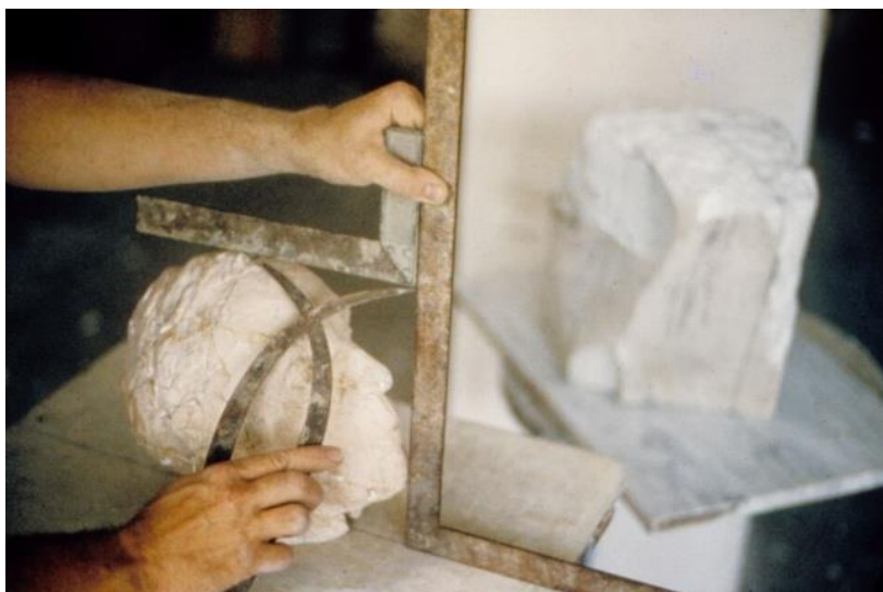
Sl. 83. Šestar za razmjerno povećavanje
