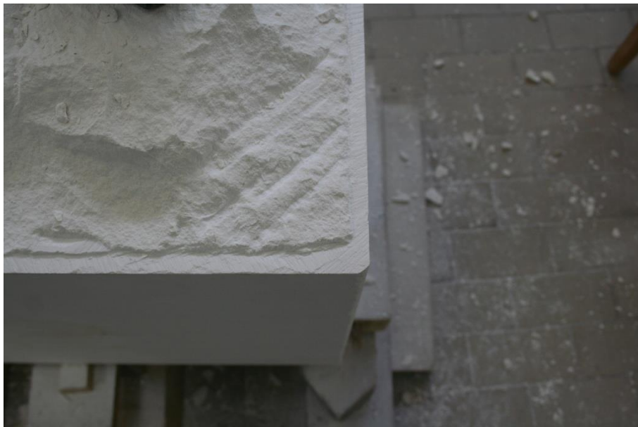
Slika 142. Obrub ravnim dlijetom, trag šiljastog dlijeta, fotografija: Josipa Krolo
