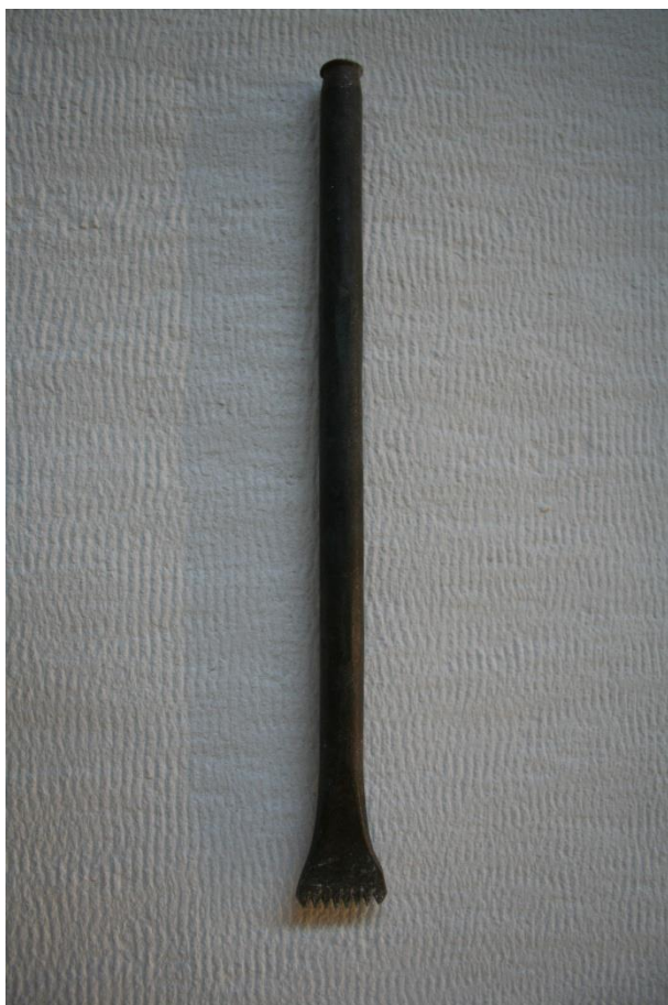
Slika 162. Zupčasto dlijeto i tragovi zupčastog dlijeta, fotografija: Josipa Krolo
