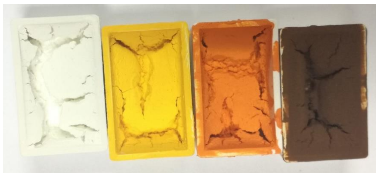
Slika 8 Raspucavanje boje nakon sušenja, Cink bijela, Kadmij žuta, Kadmij narančasta, Prirodna sienna
