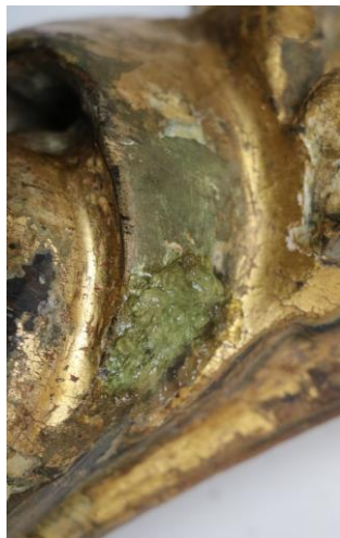
Slika 207 Detalj nanesenog acetonskog gela na površinu zlatnog preslika
