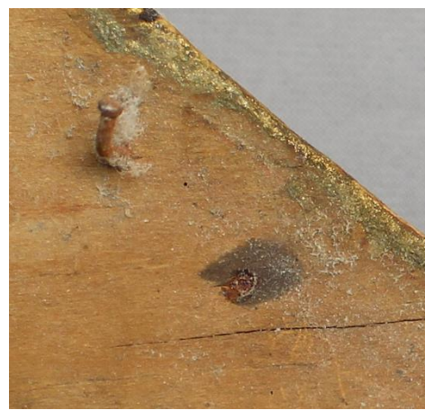
Slika 61 Korodirani čavao te diskoloracija i oštećenje nastali zbog djelovanja korozije na okolno drvo, detalj
