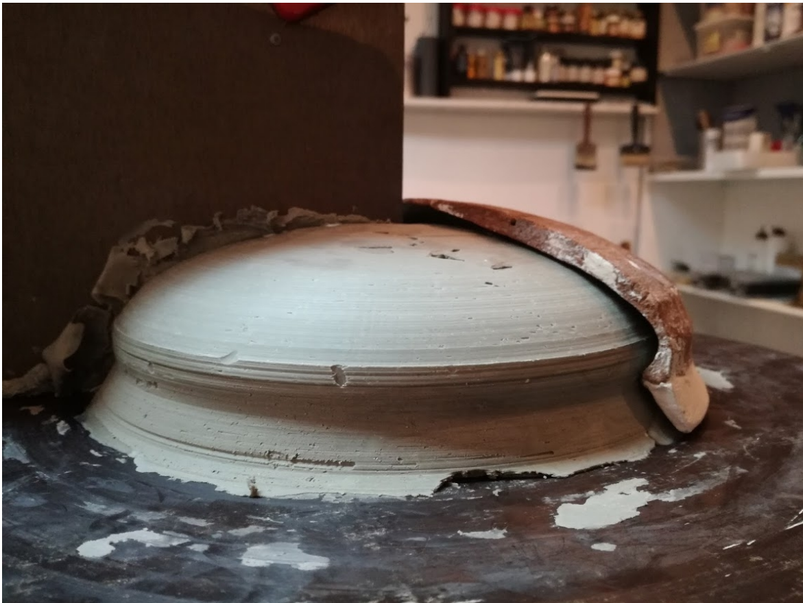
Slika 54. Oblikovanje unutarnjeg profila posude u glini na sporom lončarskom kolu (foto: Tamara Kaličanin, 2020.)
