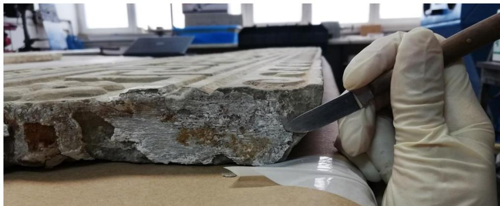
Slika 22: Mehaničko čišćenje ostataka gipsa i lijepila (foto: A. M. Lučić)
