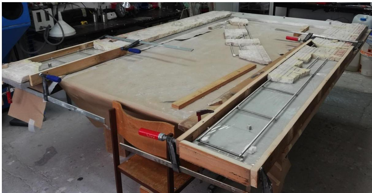
**Slika 60:** Priprema za lijevanje umjetnoga kamenja (foto:A. M. Lučić)
