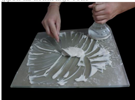
Slika 64: Sakupljanje gašenog gipsa špatulicom
