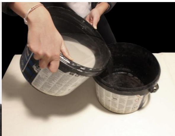
Slika 57: Dekantiranje viška vode iz nataloženog gipsa
