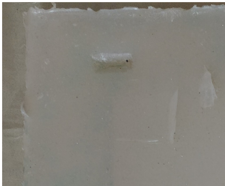
Slika 90 Detalj silikona s probe A na kojem se vidi jedan od četiri utora s ruba za koji se trebala pričvrstiti gipsana kapa
