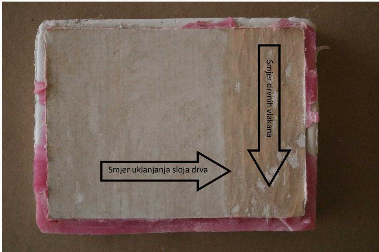
Slika 104 Uklanjanje posljednjeg sloja drvenog nositelja okomito na smjer vlasti ( proba B)
