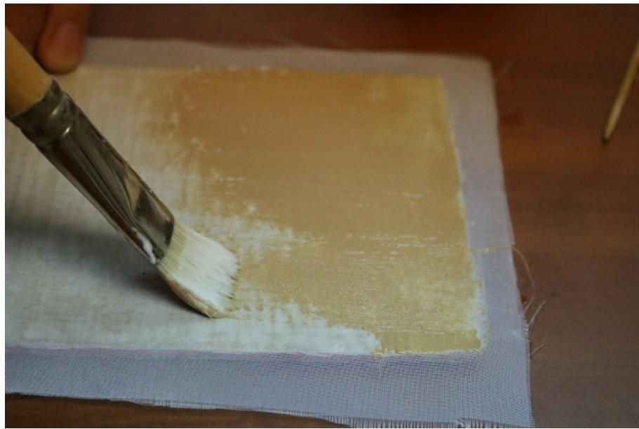
*Slika 117 Nanošenje PVA ljeplila razrijeđenog vodom i s dodatkom mikrobalona (utvrđeni dobri omjeri) na poleđinu probe C*
