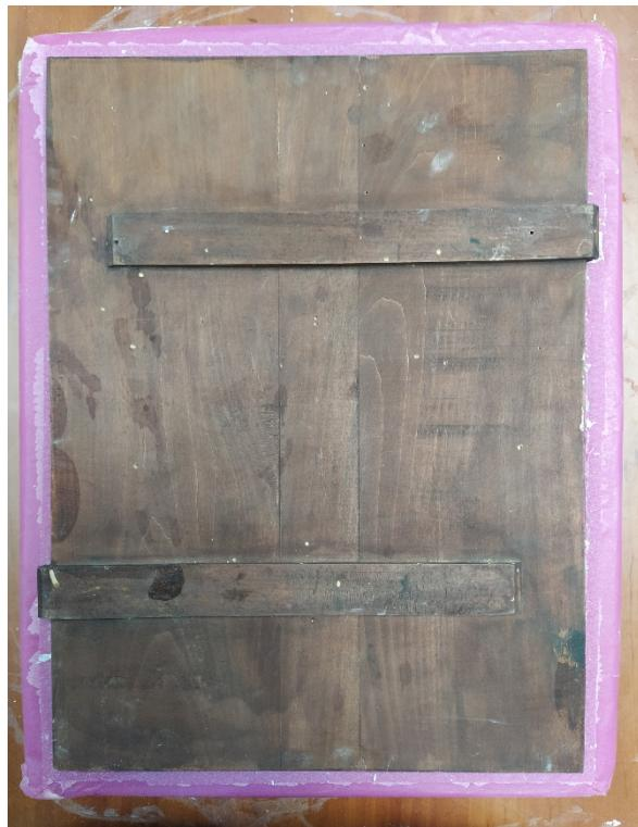
*Slika 15 Slika leži na silikonskom kalupu i gipsanoj kapi, a poleđina slike je dostupna za uklanjanje s dlijetom*
