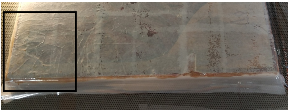
Slika 67 Potklobučenje nakon sušenja
