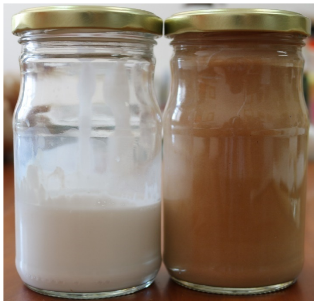
Slika 58 PVA ljepilo koje se nanosi na novi nositelj (lijevo) i PVA ljepilo s dodatkom mikrobalona koje se nanosi na poledinu slikanog sloja (desno)
