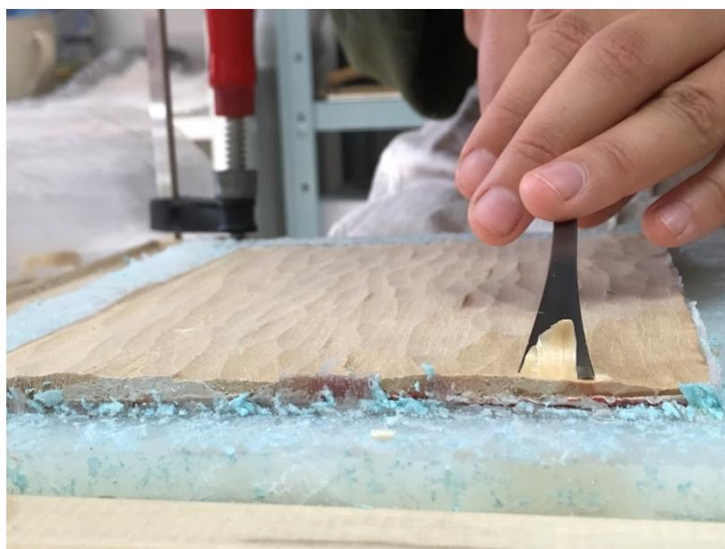
Slika 92 Uklanjanje drva dljetom s probne dašćice A
