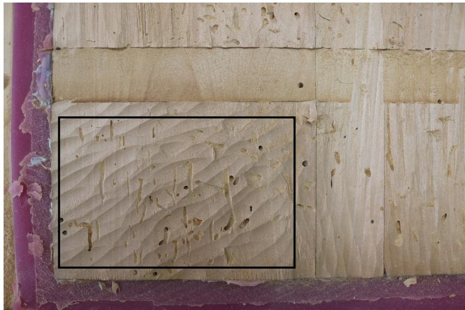
Slika 20 Dio nositelja na kojem se drvo uklanjalo pod kutom od  $45^\circ$  u odnosu na smjer vlakana
