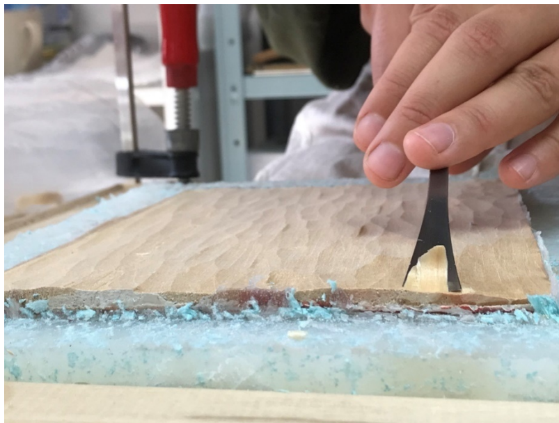
Slika 92 Uklanjanje drva dlijetom s probne daščice A
