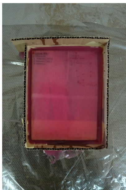
Slika 89 Probna daščica B nakon izlivanja silikona, silikon prelazi preko rubova slikanog sloja
