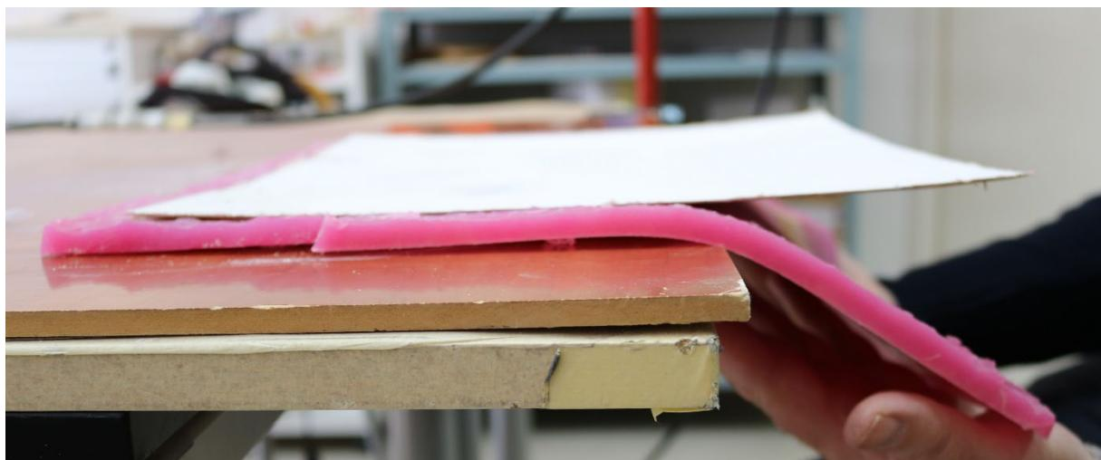
Slika 44 Odvajanje slikanog sloja od silikonskog kalupa
