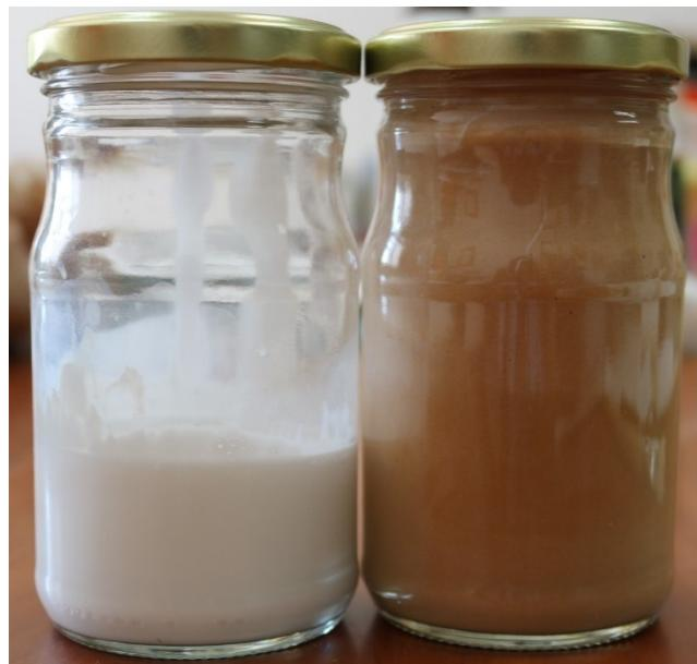
Slika 58 PVA ljepilo koje se nanosi na novi nositelj (lijevo) i PVA ljepilo s dodatkom mikrobalona koje se nanosi na poleđinu slikanog sloja (desno)
