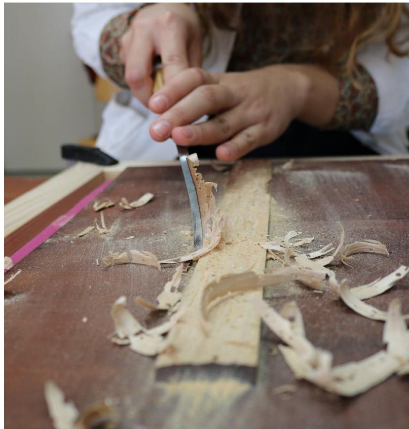
Slika 17 Uklanjanje poprečnih letvi s dlijetom
