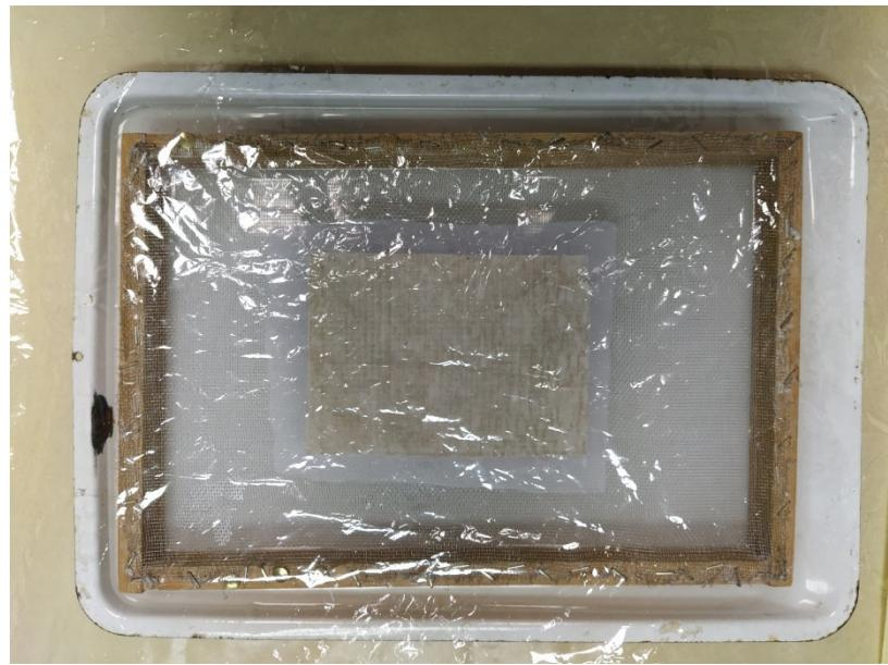
Slika 118 Vlaženje probe C u improviziranoj mikroklimatskoj komori
