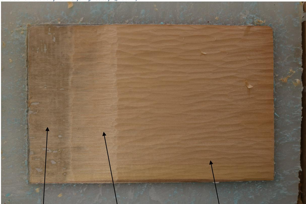
Nositelj stanjen na debljinu od pola milimetara(i manje), ovaj sloj drva prožet je tutkalom iz impregnacije, te stoga ima sivkasti ton.
