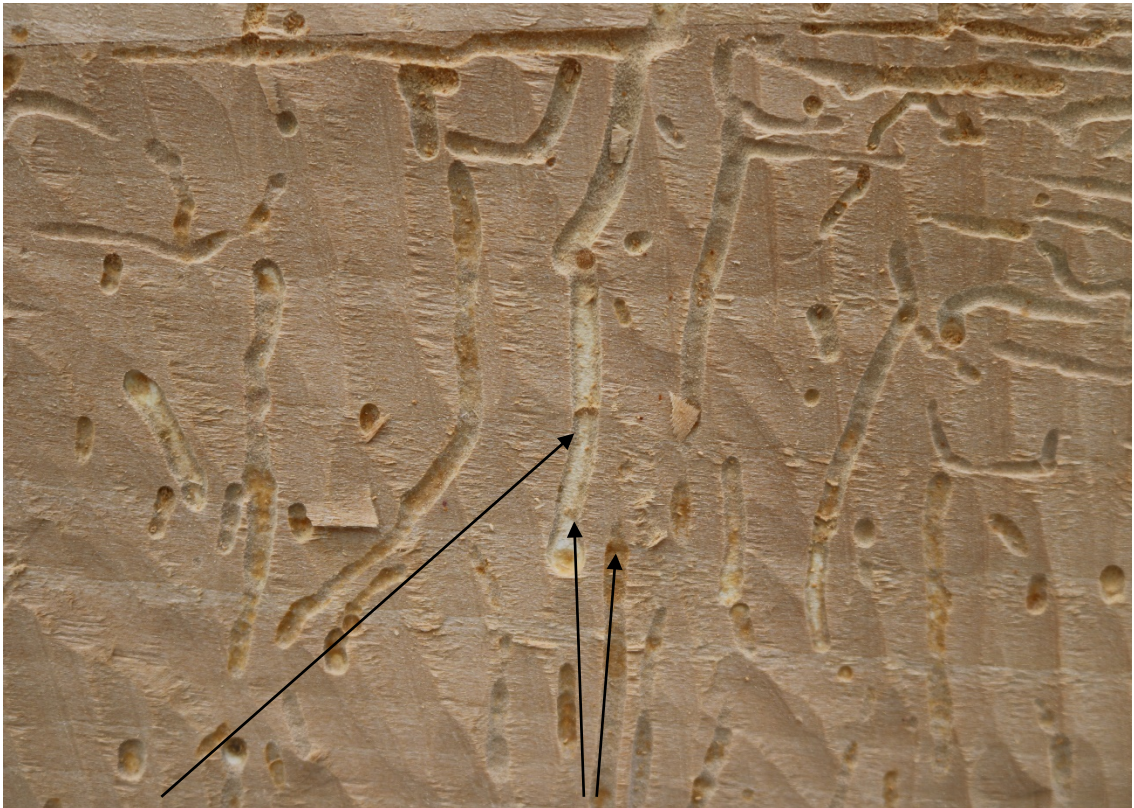
Slika 36 Detalj kanalića crvotočine
