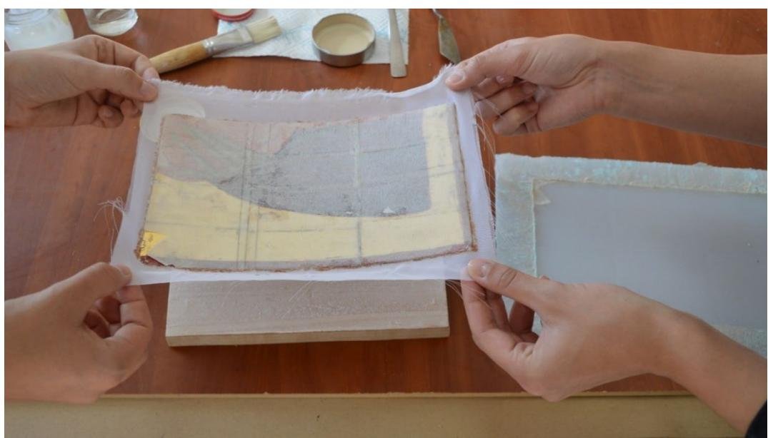
Slika 110 Postavljanje probe A na novi nositelj
