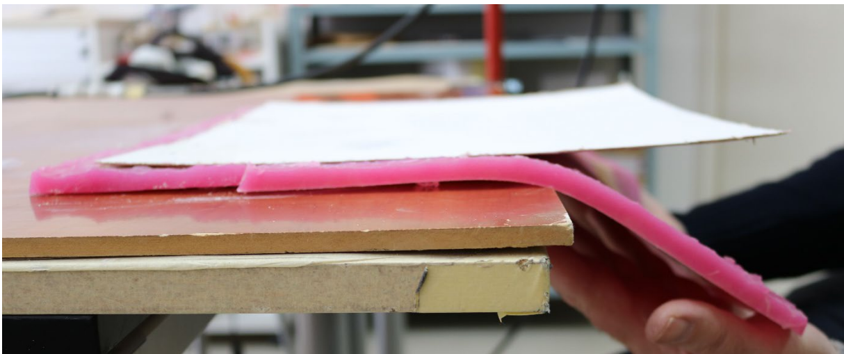
Slika 44 Odvajanje slikanog sloja od silikonskog kalupa
