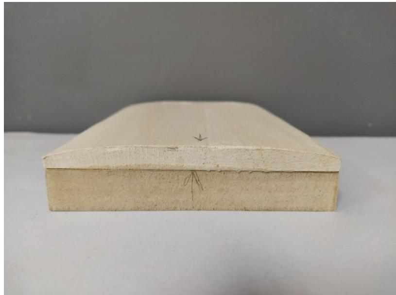
Slika 106 Novi nositelj za probu A izrađen od medijskog balze koja je potom izbrušena kako bi se dobila zakrivljeno karakteristična za slike na drvu
