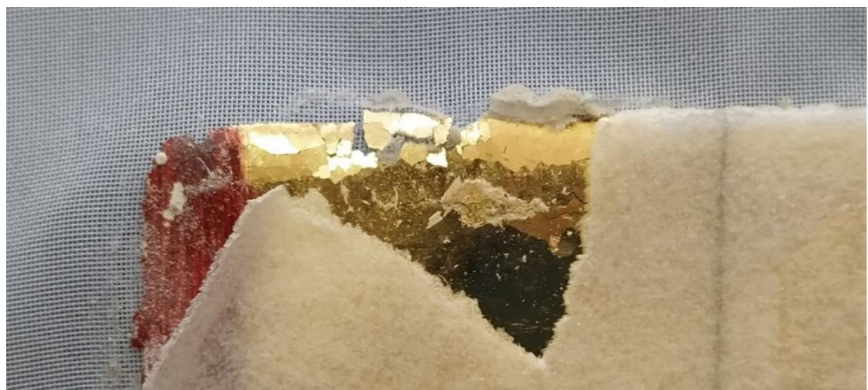
Slika 97 Oštećenje na licu probe A koje je prouzrokovalo uklanjanje drva s pneumatskom brusilicom sa stožastim nastavkom
