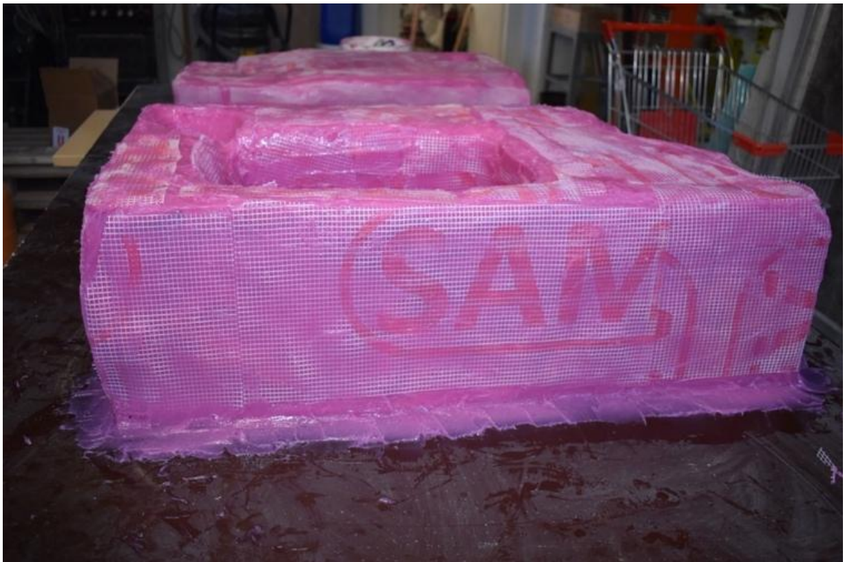
Slika 112. Armatura mrežica po površini, fotografija: Martin Zohil
