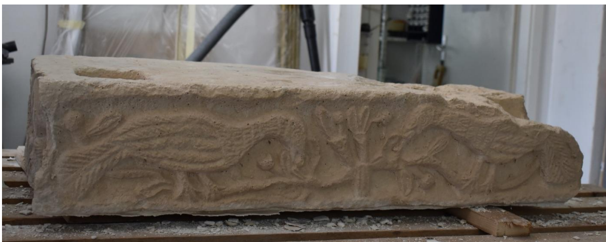
Slika 119. Replika imposta s prikazom sirene nakon vađenja iz kalupa, fotografija: Martin Zohil
