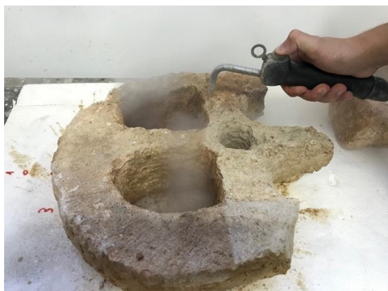
Slika 22. Čišćenje poledine vodenom parom, fotografija: Martin Zohil
