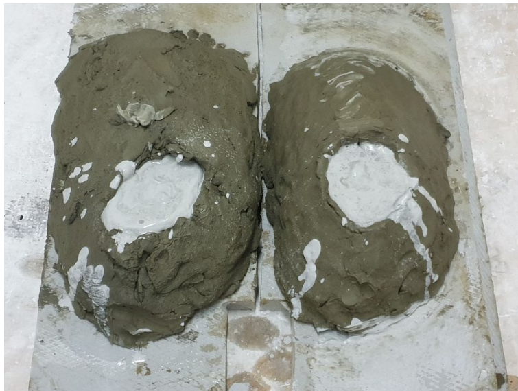
Slika 22. Gips u glinenom kalupu
