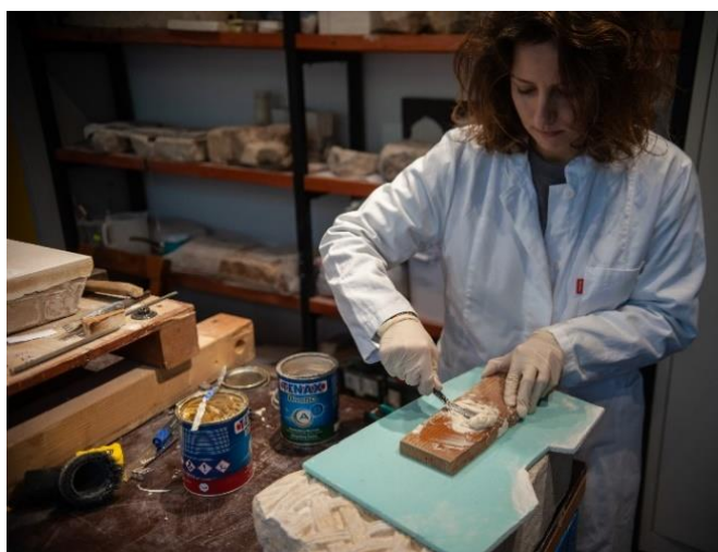
Slika 41 Miješanje komponenata ljepila (autor: Mladen Matijaca)
