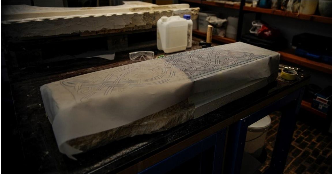
Slika 67 Prenošnje crteža ornamentike na novu rekonstrukciju (autor: Rina Dubravec)
