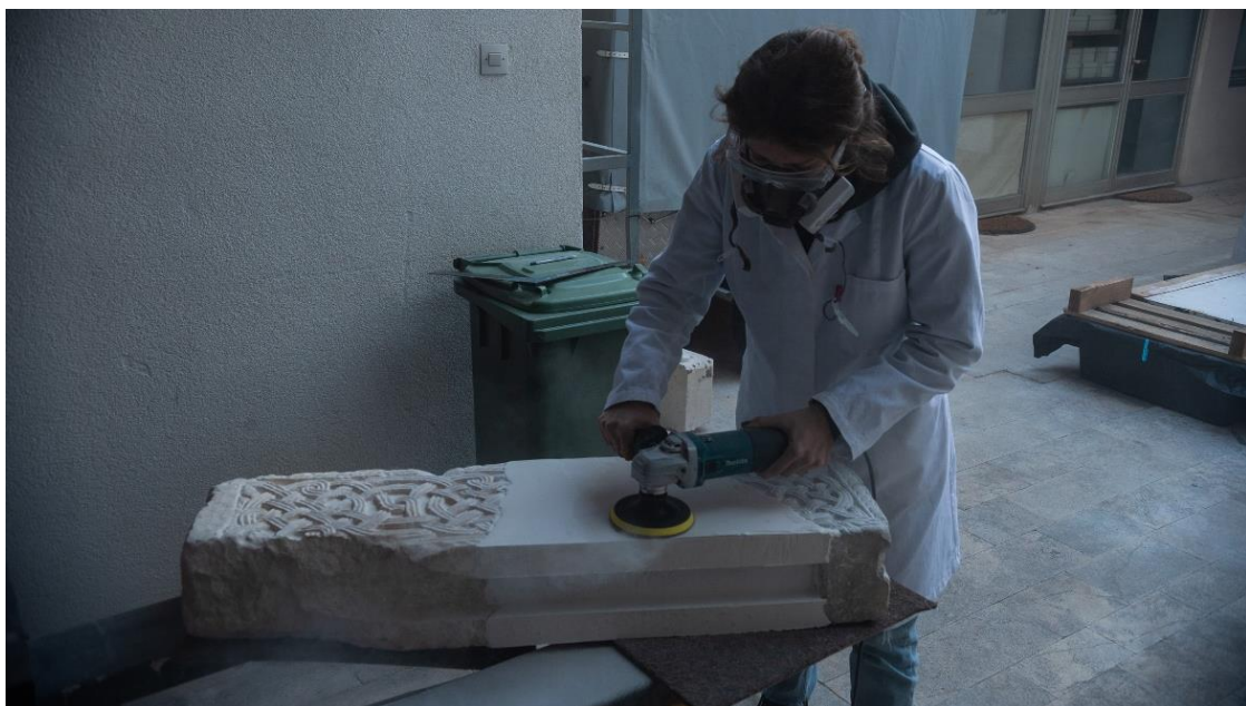
Slika 66 Ravnanje površine Acrystala brusilicom (autor: Zoran Boban)
