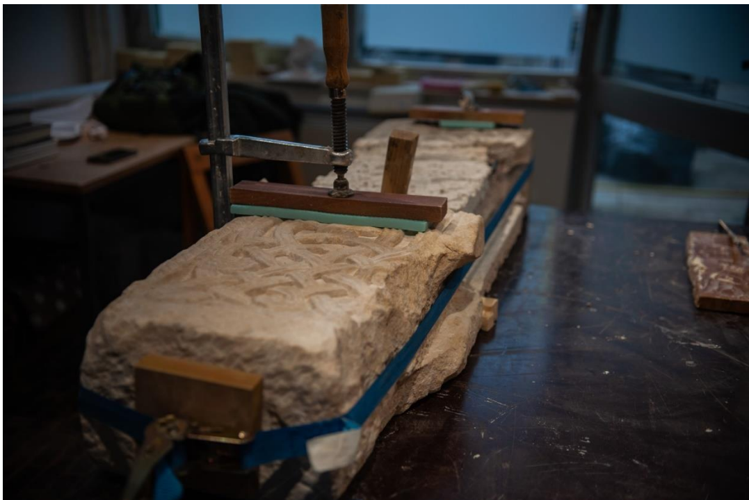
Slika 43 i Slika 44., Fiksiranje pilastra s stegama i trakom s natezačem (autor: Rina Dubravec)
