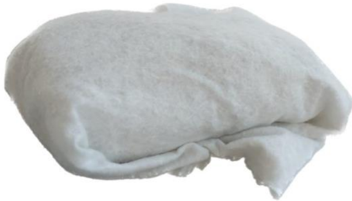
Slika 21. Kameni primjerak umotan u polipropilenski flis
