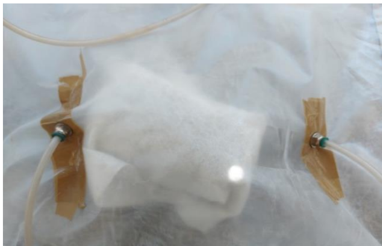
Slika 22. Kameni primjerak u plastičnoj foliji s dva crijeva
