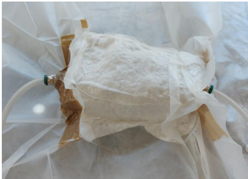
Slika 24. Prikaz kamenog primjerka u procesu vakuumiranja
