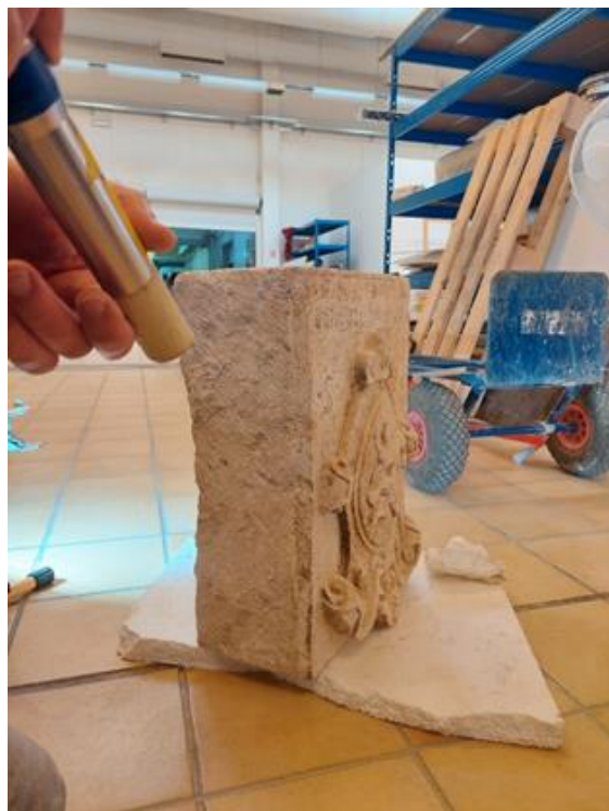
Slika 32, Lasersko čišćenje grba u Hrvatskom restauratorskom zaboru
