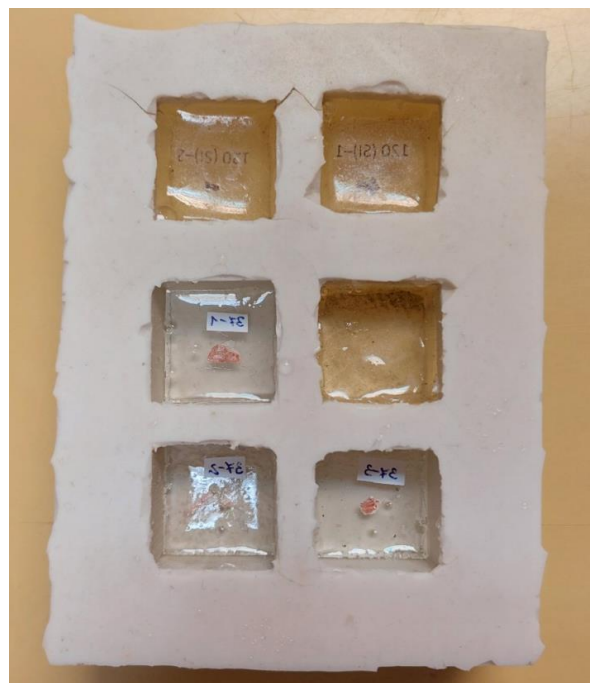
Slika 14, Uzorci u poliesterskoj smoli
