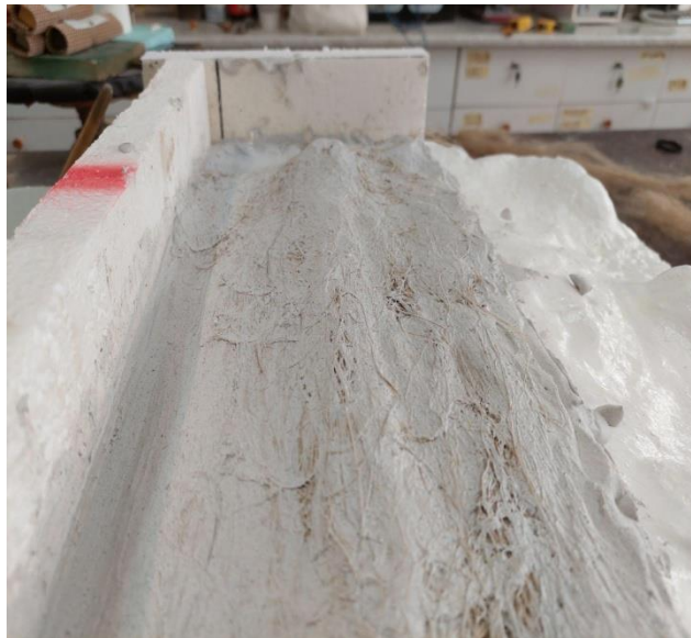
Slika 38, Nanošenje gipsa sa dodatkom kudelje i drvene letve kao armatura
