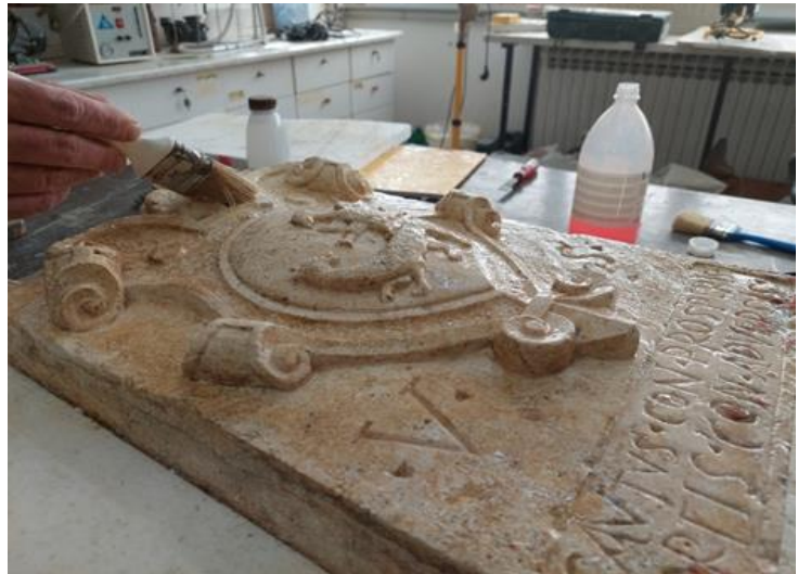
Slika 33, Nanošenje konsolidanta na kameni grb
