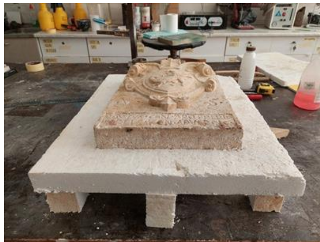
Slika 34, Kameni grb zaštićen okvirom od stiropora
