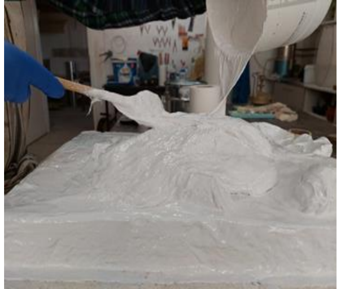
Slika 36, Nanošenje drugog sloja gume
