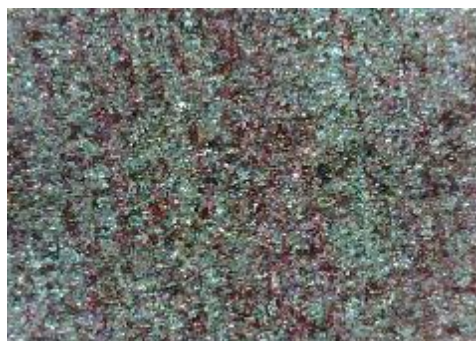
e) uzorak korodiran u otopini HCl, sredina
