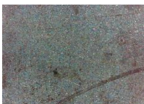
f) uzorak korodiran u otopini HCl, prijelaz
