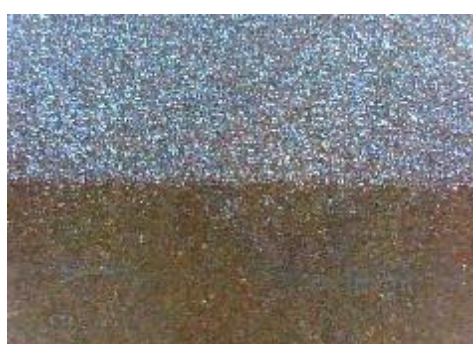
f) uzorak korodiran u otopini HCl, prijelaz
