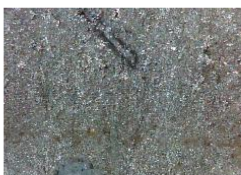
f) uzorak korodiran u otopini HCl, prijelaz
