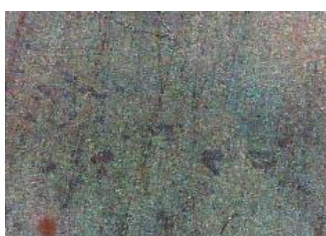
f) uzorak korodiran u otopini HCl, prijelaz
