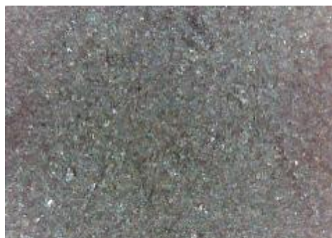
e) uzorak korodiran u otopini HCl, sredina
