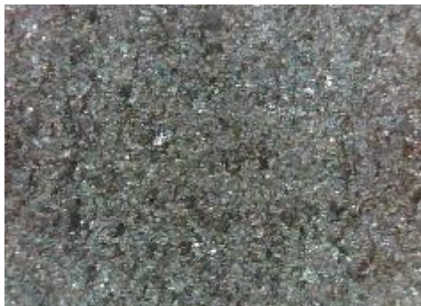
e) uzorak korodiran u otopini HCl, sredina
