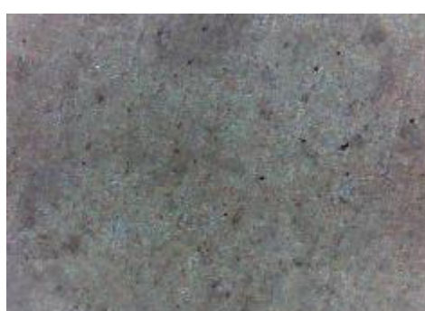
f) uzorak korodiran u otopini HCl, prijelaz
