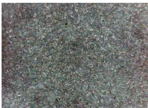
c) uzorak korodiran u otopini NaCl sredina
