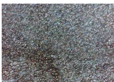
f) uzorak korodiran u otopini HCl, prijelaz
