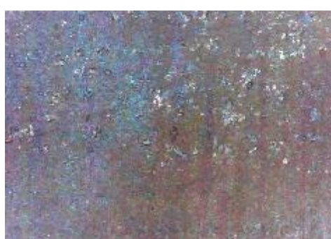
f) uzorak korodiran u otopini HCl, prijelaz
