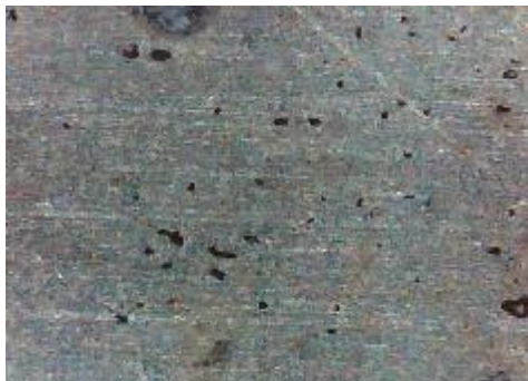
c) uzorak korodiran u otopini NaCl sredina
