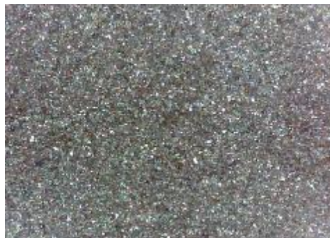
e) uzorak korodiran u otopini HCl, sredina
