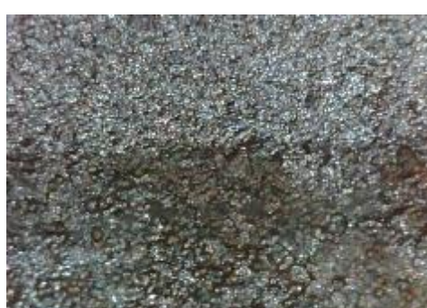
f) uzorak korodiran u otopini HCl, prijelaz
