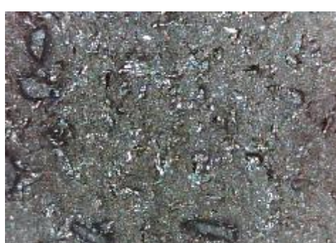
f) uzorak korodiran u otopini HCl, prijelaz
