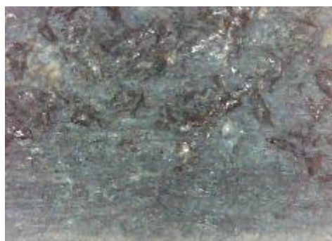
d) uzorak korodiran u otopini NaCl, prijelaz
