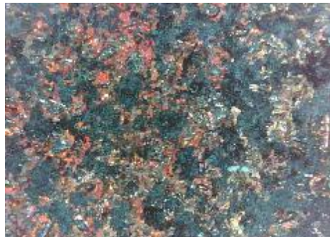
c) uzorak korodiran u otopini NaCl sredina
