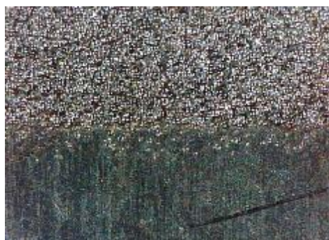
d) uzorak korodiran u otopini NaCl, prijelaz
