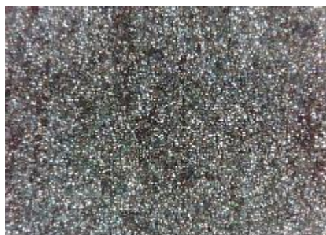
c) uzorak korodiran u otopini NaCl sredina
