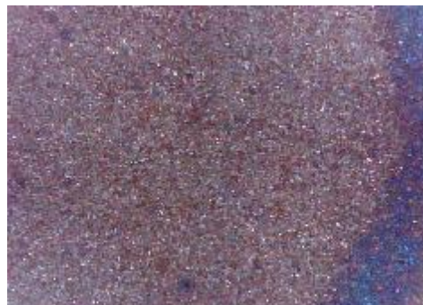
e) uzorak korodiran u otopini HCl, sredina
