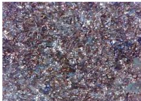
e) uzorak korodiran u otopini HCl, sredina
