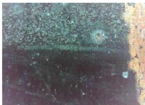
d) uzorak korodiran u otopini NaCl, prijelaz
