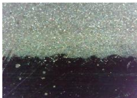
b) nekorodirani uzorak, prijelaz
