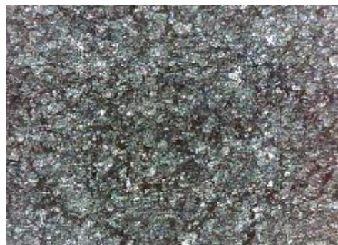
e) uzorak korodiran u otopini HCl, sredina
