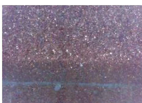
f) uzorak korodiran u otopini HCl, prijelaz
