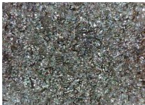
e) uzorak korodiran u otopini HCl, sredina
