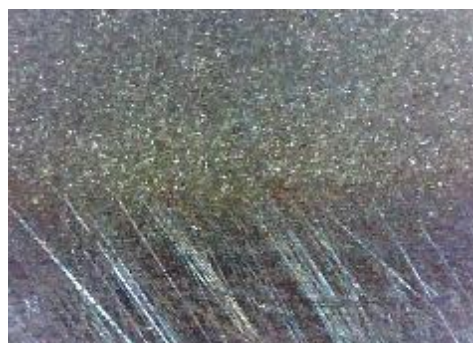
d) uzorak korodiran u otopini NaCl, prijelaz
