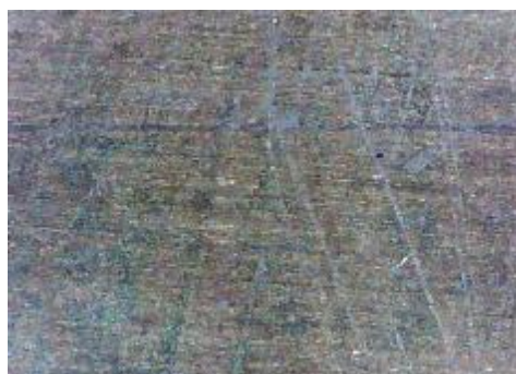
d) uzorak korodiran u otopini NaCl, prijelaz
