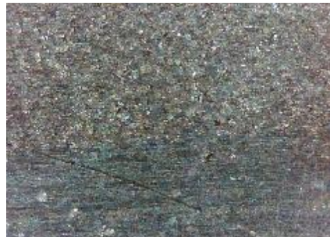
d) uzorak korodiran u otopini NaCl, prijelaz
