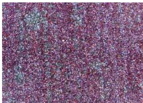
e) uzorak korodiran u otopini HCl, sredina
