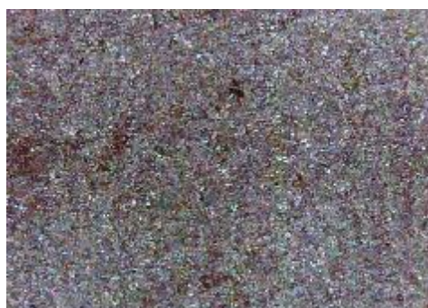
e) uzorak korodiran u otopini HCl, sredina
