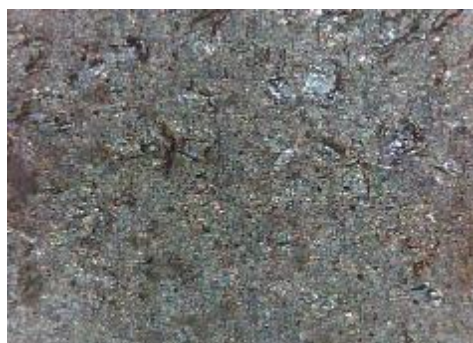
d) uzorak korodiran u otopini NaCl, prijelaz
