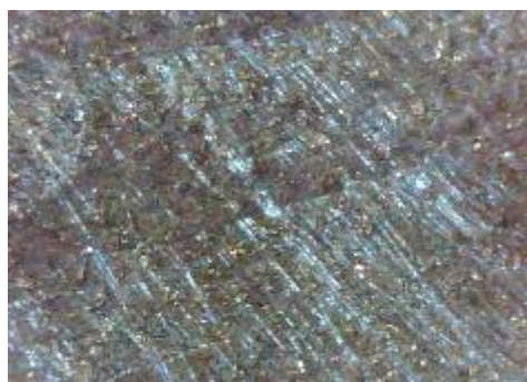
d) uzorak korodiran u otopini NaCl, prijelaz
