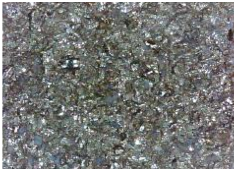
c) uzorak korodiran u otopini NaCl sredina
