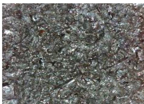
c) uzorak korodiran u otopini NaCl sredina
