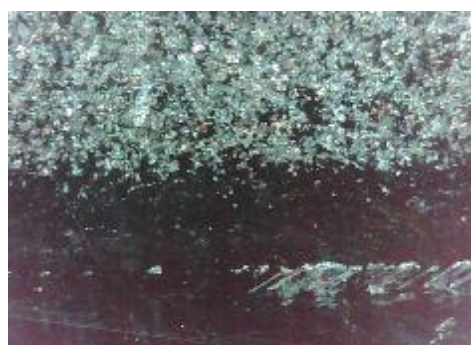
d) uzorak korodiran u otopini NaCl, prijelaz
