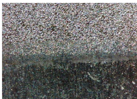
d) uzorak korodiran u otopini NaCl, prijelaz
