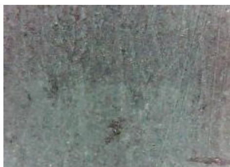
d) uzorak korodiran u otopini NaCl, prijelaz
