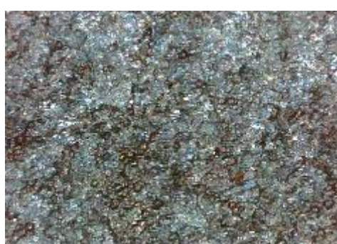
f) uzorak korodiran u otopini HCl, prijelaz
