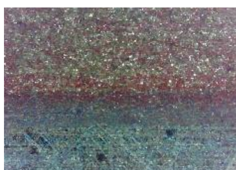
f) uzorak korodiran u otopini HCl, prijelaz
