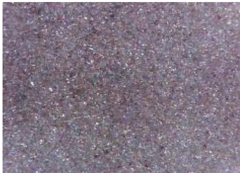
c) uzorak korodiran u otopini NaCl sredina
