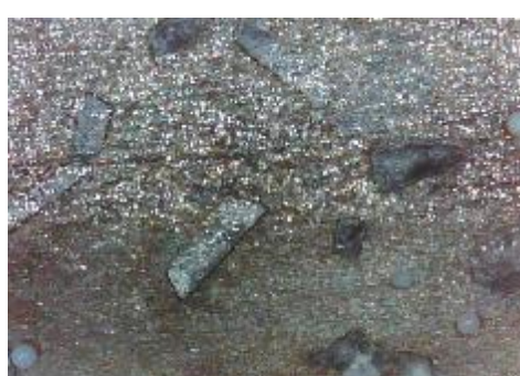
f) uzorak korodiran u otopini HCl, prijelaz
