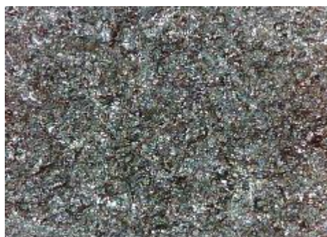
c) uzorak korodiran u otopini NaCl sredina
