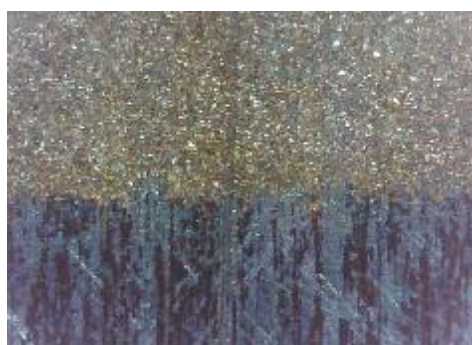
d) uzorak korodiran u otopini NaCl, prijelaz
