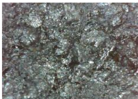
c) uzorak korodiran u otopini NaCl sredina
