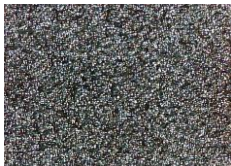
e) uzorak korodiran u otopini HCl, sredina
