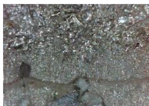
f) uzorak korodiran u otopini HCl, prijelaz
