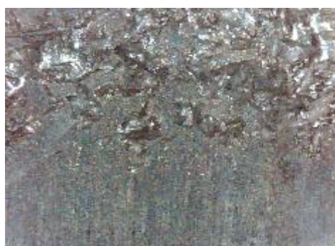
d) uzorak korodiran u otopini NaCl, prijelaz
