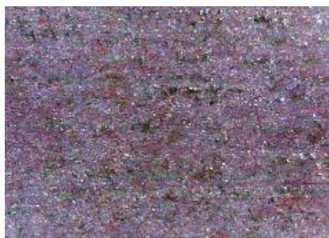
e) uzorak korodiran u otopini HCl, sredina
