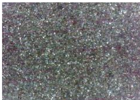
e) uzorak korodiran u otopini HCl, sredina
