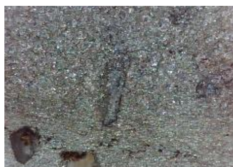
f) uzorak korodiran u otopini HCl, prijelaz
