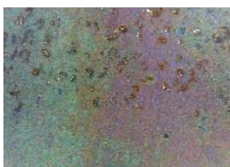
f) uzorak korodiran u otopini HCl, prijelaz
