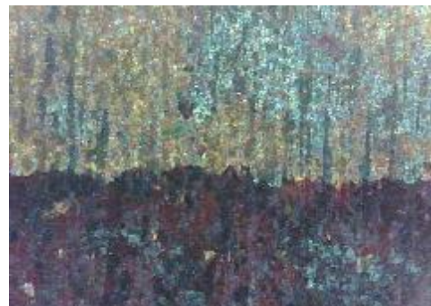
d) uzorak korodiran u otopini NaCl, prijelaz
