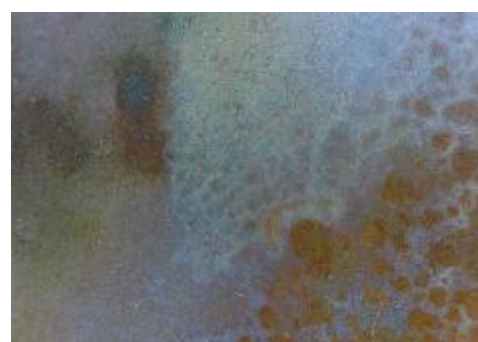
f) uzorak korodiran u otopini HCl, prijelaz
