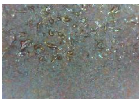
f) uzorak korodiran u otopini HCl, prijelaz
