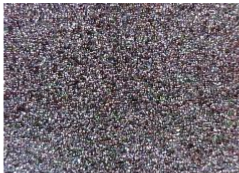
e) uzorak korodiran u otopini HCl, sredina
