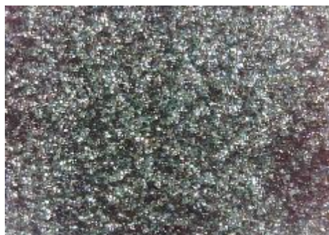
e) uzorak korodiran u otopini HCl, sredina
