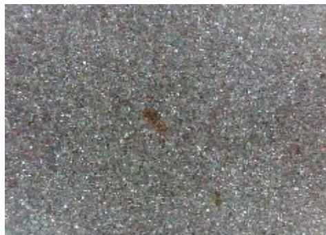
c) uzorak korodiran u otopini NaCl sredina
