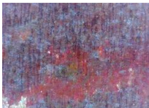
c) uzorak korodiran u otopini NaCl sredina
