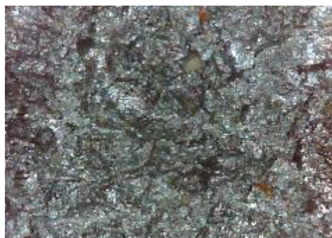
e) uzorak korodiran u otopini HCl, sredina
