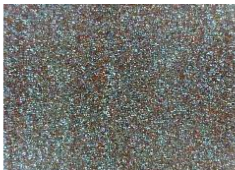
e) uzorak korodiran u otopini HCl, sredina
