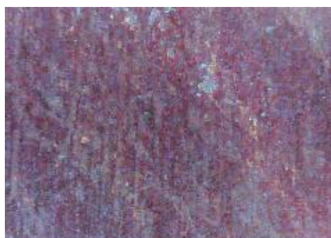
c) uzorak korodiran u otopini NaCl sredina
