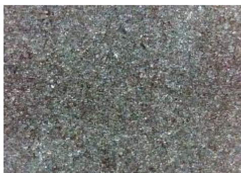
e) uzorak korodiran u otopini HCl, sredina
