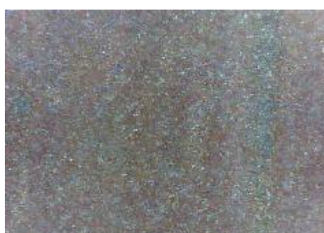
f) uzorak korodiran u otopini HCl, prijelaz
