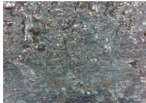
d) uzorak korodiran u otopini NaCl, prijelaz
