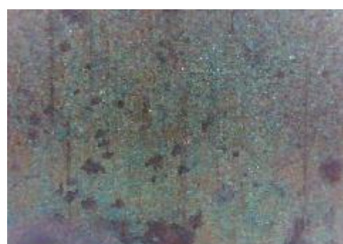
f) uzorak korodiran u otopini HCl, prijelaz
