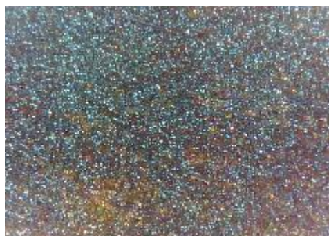
e) uzorak korodiran u otopini HCl, sredina
