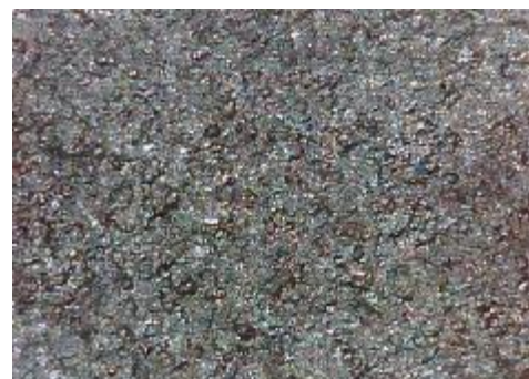
e) uzorak korodiran u otopini HCl, sredina
