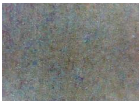
e) uzorak korodiran u otopini HCl, sredina
