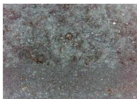
f) uzorak korodiran u otopini HCl, prijelaz
