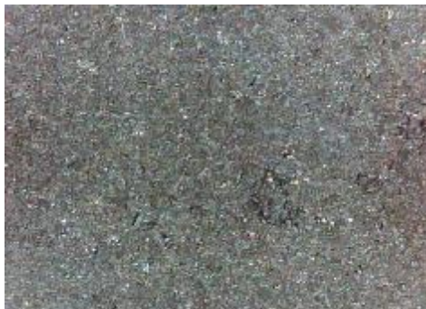
e) uzorak korodiran u otopini HCl, sredina
