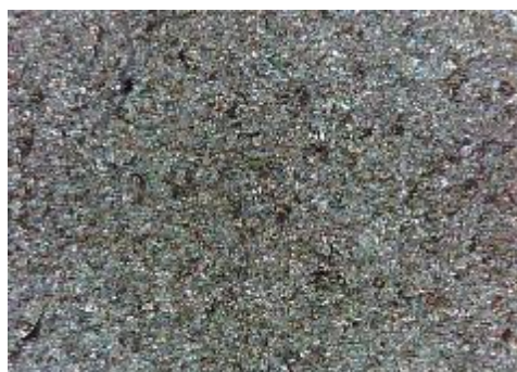
c) uzorak korodiran u otopini NaCl sredina
