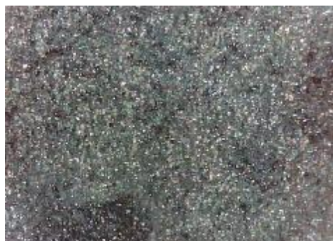
e) uzorak korodiran u otopini HCl, sredina
