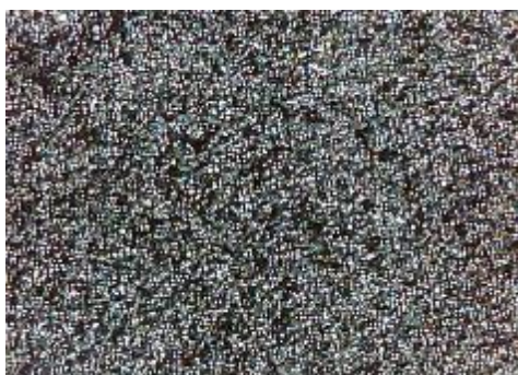
c) uzorak korodiran u otopini NaCl sredina
