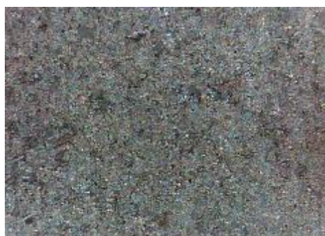
d) uzorak korodiran u otopini NaCl, prijelaz
