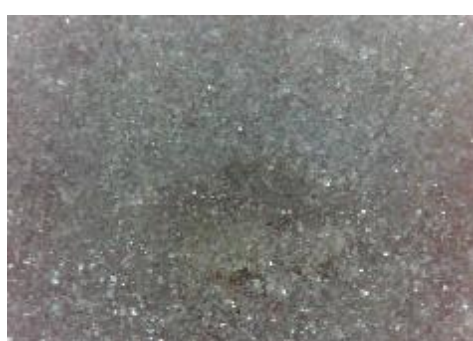
f) uzorak korodiran u otopini HCl, prijelaz
