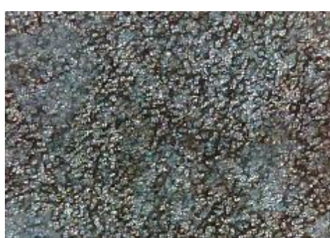
f) uzorak korodiran u otopini HCl, prijelaz
