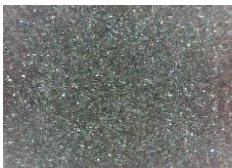
c) uzorak korodiran u otopini NaCl sredina
