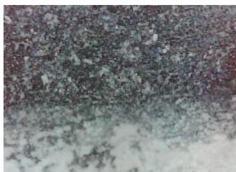
d) uzorak korodiran u otopini NaCl, prijelaz
