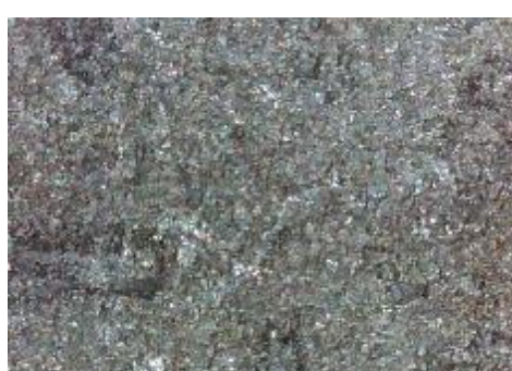
f) uzorak korodiran u otopini HCl, prijelaz
