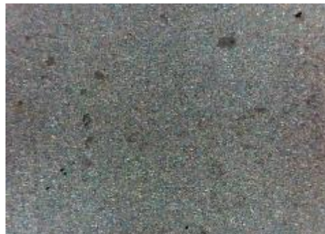
e) uzorak korodiran u otopini HCl, sredina
