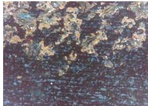
d) uzorak korodiran u otopini NaCl, prijelaz
