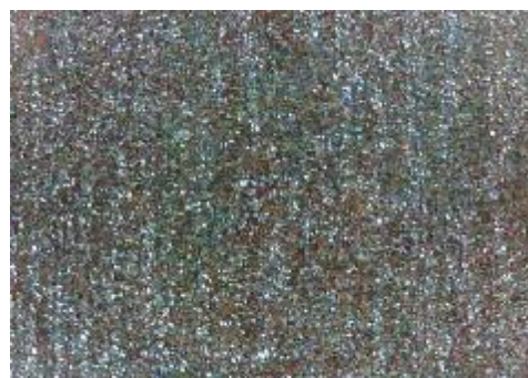
e) uzorak korodiran u otopini HCl, sredina
