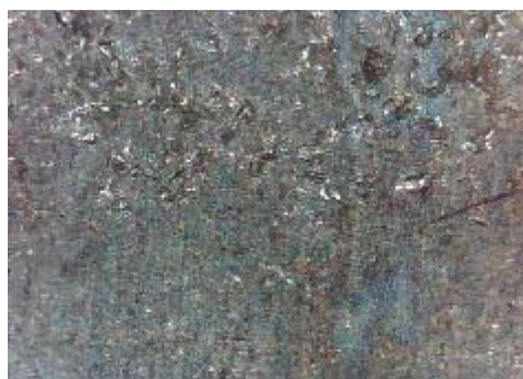
d) uzorak korodiran u otopini NaCl, prijelaz
