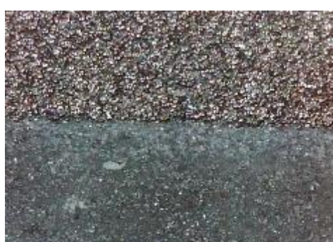
f) uzorak korodiran u otopini HCl, prijelaz
