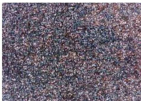
c) uzorak korodiran u otopini NaCl sredina
