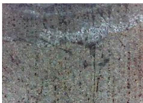
c) uzorak korodiran u otopini NaCl sredina
