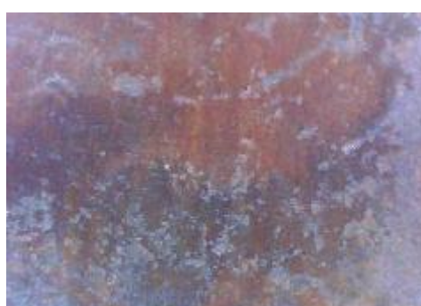
f) uzorak korodiran u otopini HCl, prijelaz
