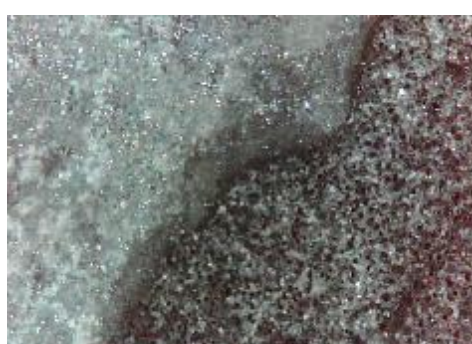
f) uzorak korodiran u otopini HCl, prijelaz
