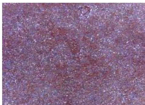
e) uzorak korodiran u otopini HCl, sredina
