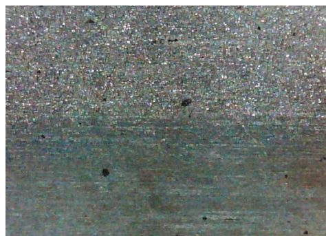
d) uzorak korodiran u otopini NaCl, prijelaz
