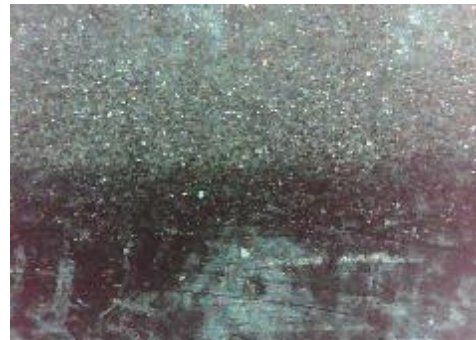
d) uzorak korodiran u otopini NaCl, prijelaz
