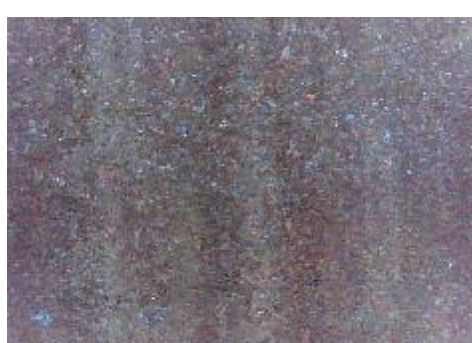
f) uzorak korodiran u otopini HCl, prijelaz
