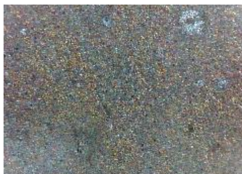
c) uzorak korodiran u otopini NaCl sredina
