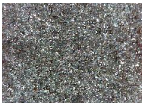
e) uzorak korodiran u otopini HCl, sredina
