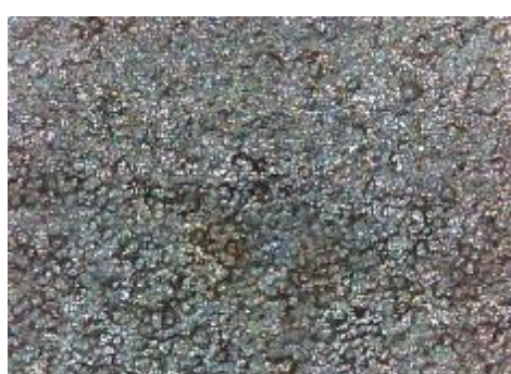
f) uzorak korodiran u otopini HCl, prijelaz
