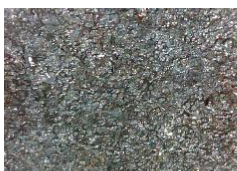
f) uzorak korodiran u otopini HCl, prijelaz
