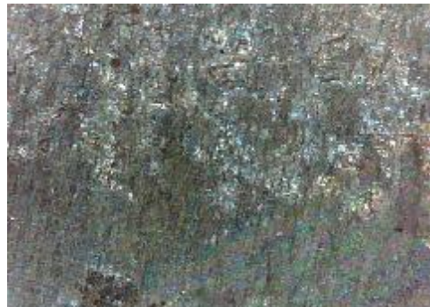
d) uzorak korodiran u otopini NaCl, prijelaz
