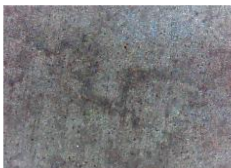
d) uzorak korodiran u otopini NaCl, prijelaz
