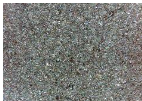
e) uzorak korodiran u otopini HCl, sredina
