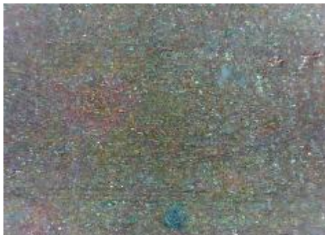
e) uzorak korodiran u otopini HCl, sredina
