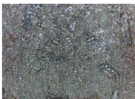
f) uzorak korodiran u otopini HCl, prijelaz
