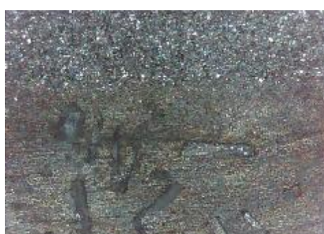
f) uzorak korodiran u otopini HCl, prijelaz
