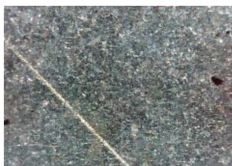
f) uzorak korodiran u otopini HCl, prijelaz
