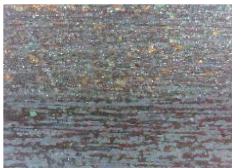
d) uzorak korodiran u otopini NaCl, prijelaz
