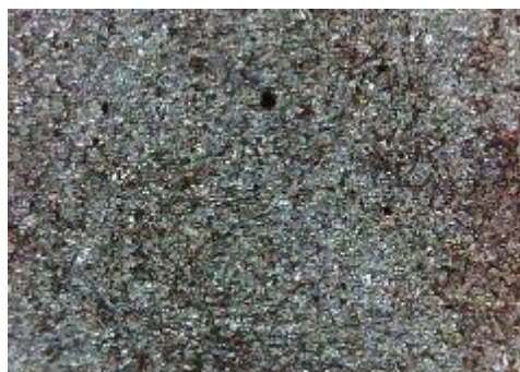
e) uzorak korodiran u otopini HCl, sredina
