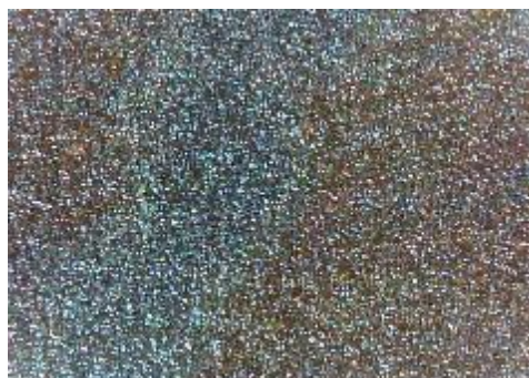
e) uzorak korodiran u otopini HCl, sredina
