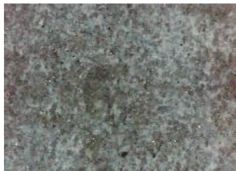
e) uzorak korodiran u otopini HCl, sredina
