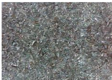
e) uzorak korodiran u otopini HCl, sredina
