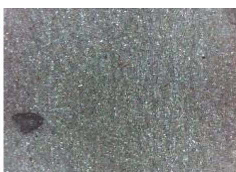
f) uzorak korodiran u otopini HCl, prijelaz
