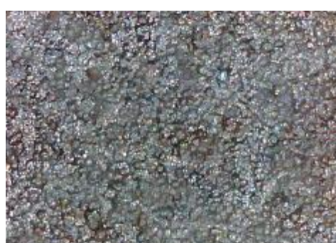
f) uzorak korodiran u otopini HCl, prijelaz
