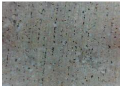
d) uzorak korodiran u otopini NaCl, prijelaz
