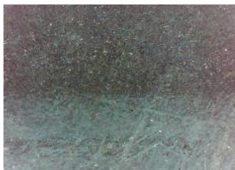
d) uzorak korodiran u otopini NaCl, prijelaz
