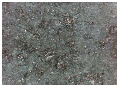
e) uzorak korodiran u otopini HCl, sredina
