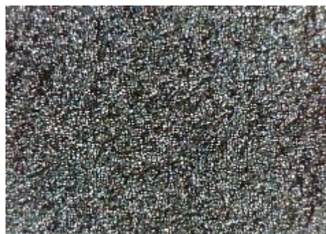
e) uzorak korodiran u otopini HCl, sredina
