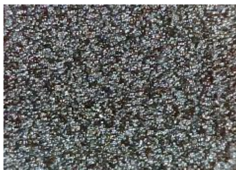
e) uzorak korodiran u otopini HCl, sredina
