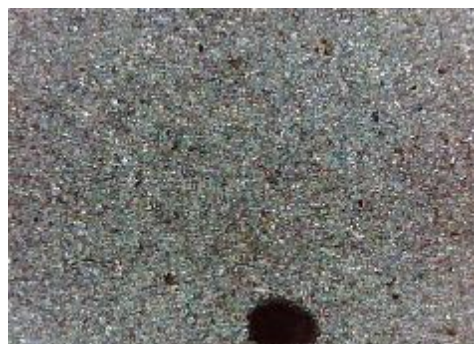
e) uzorak korodiran u otopini HCl, sredina
