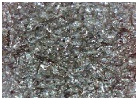
e) uzorak korodiran u otopini HCl, sredina
