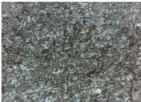
c) uzorak korodiran u otopini NaCl sredina
