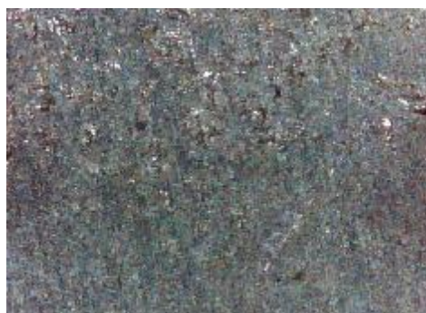
d) uzorak korodiran u otopini NaCl, prijelaz
