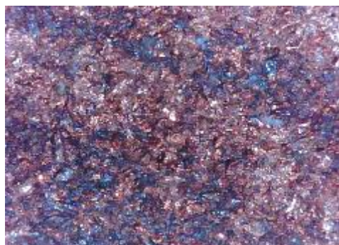
e) uzorak korodiran u otopini HCl, sredina
