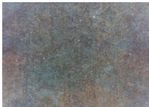
e) uzorak korodiran u otopini HCl, sredina
