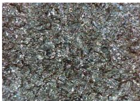
c) uzorak korodiran u otopini NaCl sredina
