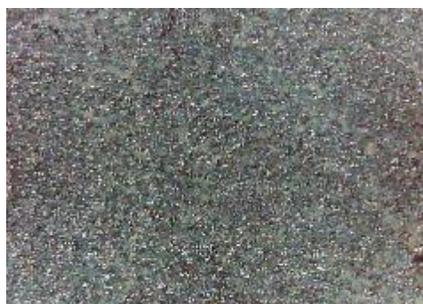
c) uzorak korodiran u otopini NaCl sredina
