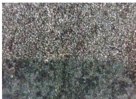
d) uzorak korodiran u otopini NaCl, prijelaz
