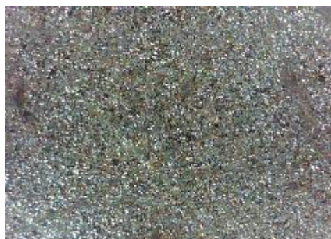
c) uzorak korodiran u otopini NaCl sredina
