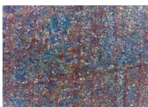
f) uzorak korodiran u otopini HCl, prijelaz
