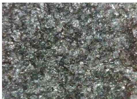
c) uzorak korodiran u otopini NaCl sredina
