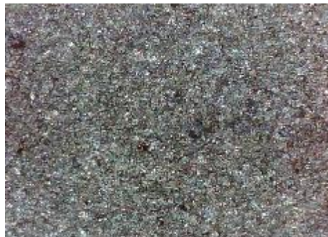
e) uzorak korodiran u otopini HCl, sredina
