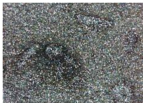
e) uzorak korodiran u otopini HCl, sredina
