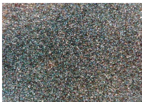
c) uzorak korodiran u otopini NaCl sredina
