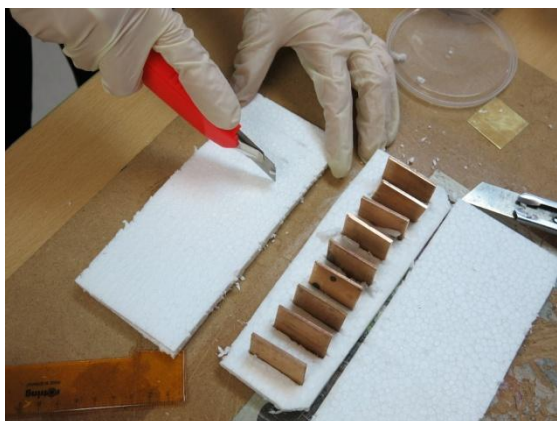
Slika 8. Priprema uzoraka - uzorci uglavljeni u stiroporsku podlogu
