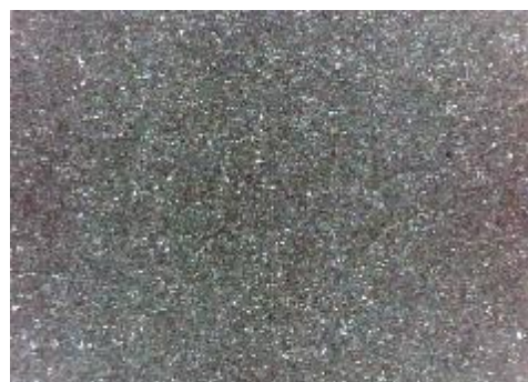
e) uzorak korodiran u otopini HCl, sredina
