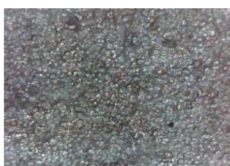
f) uzorak korodiran u otopini HCl, prijelaz
