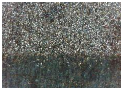
d) uzorak korodiran u otopini NaCl, prijelaz
