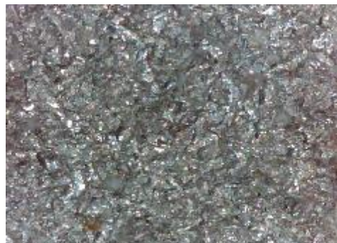
e) uzorak korodiran u otopini HCl, sredina
