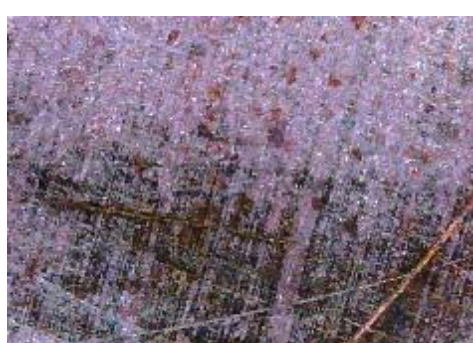
f) uzorak korodiran u otopini HCl, prijelaz
