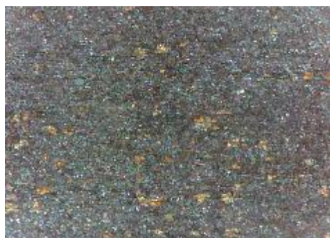
c) uzorak korodiran u otopini NaCl sredina
