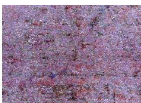
f) uzorak korodiran u otopini HCl, prijelaz
