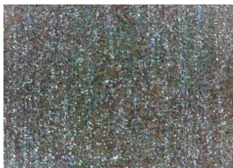
e) uzorak korodiran u otopini HCl, sredina
