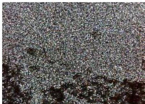
e) uzorak korodiran u otopini HCl, sredina
