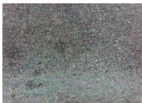
d) uzorak korodiran u otopini NaCl, prijelaz
