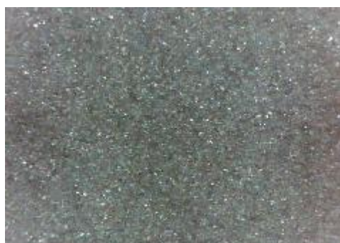
e) uzorak korodiran u otopini HCl, sredina
