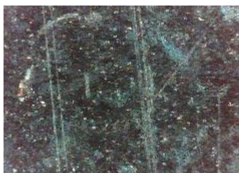
c) uzorak korodiran u otopini NaCl sredina
