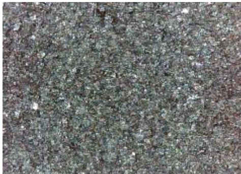
c) uzorak korodiran u otopini NaCl sredina
