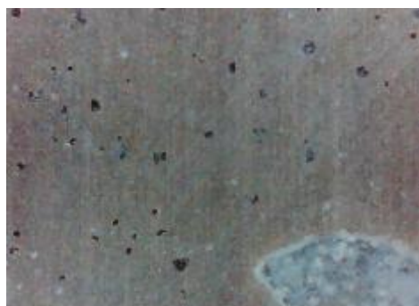
d) uzorak korodiran u otopini NaCl, prijelaz
