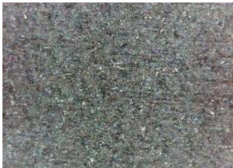
c) uzorak korodiran u otopini NaCl sredina
