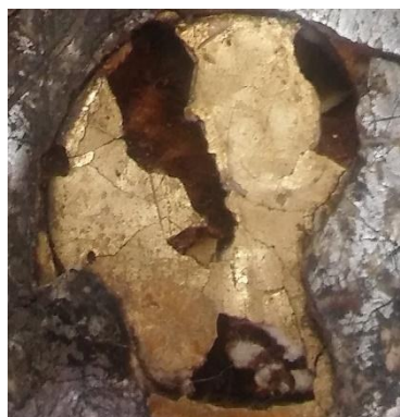
Slika 17. Lažni zračni džep
