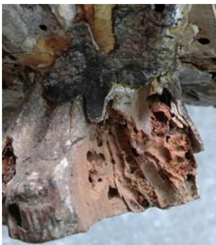
Slika 12. Oštećenje svijećnjaka crvotočinom
