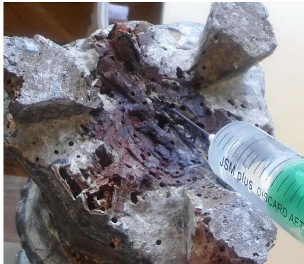
Slika 78. Potamnjeno drvo nakon konsolidacije
