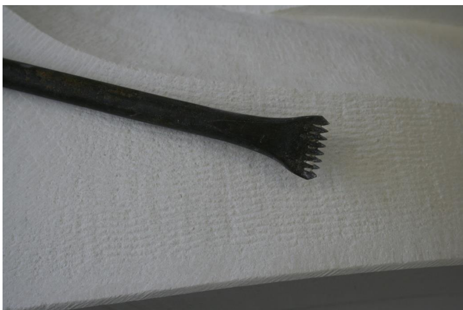
Slika 154. Tragovi ravnog dlijeta prelaze u tragove zupčastog dlijeta, fotografija: Josipa Krolo
