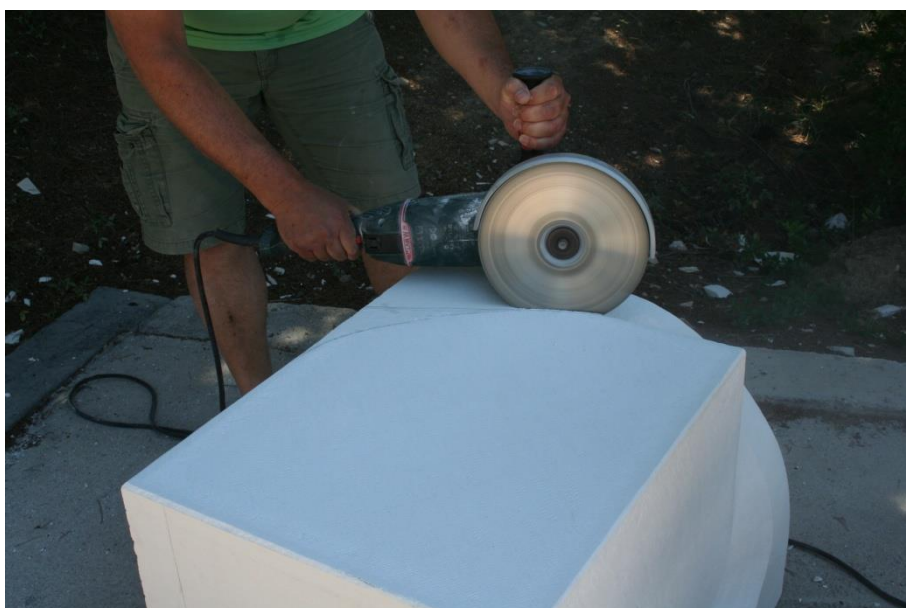
Slika 158. Zapilavanje druge strane kamenog bloka, fotografija: Josipa Krolo
