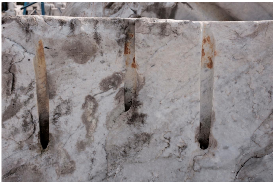
Sl. 84. Tragovi zabijanja klinova, Carrara, fotografija. Josipa Krolo
