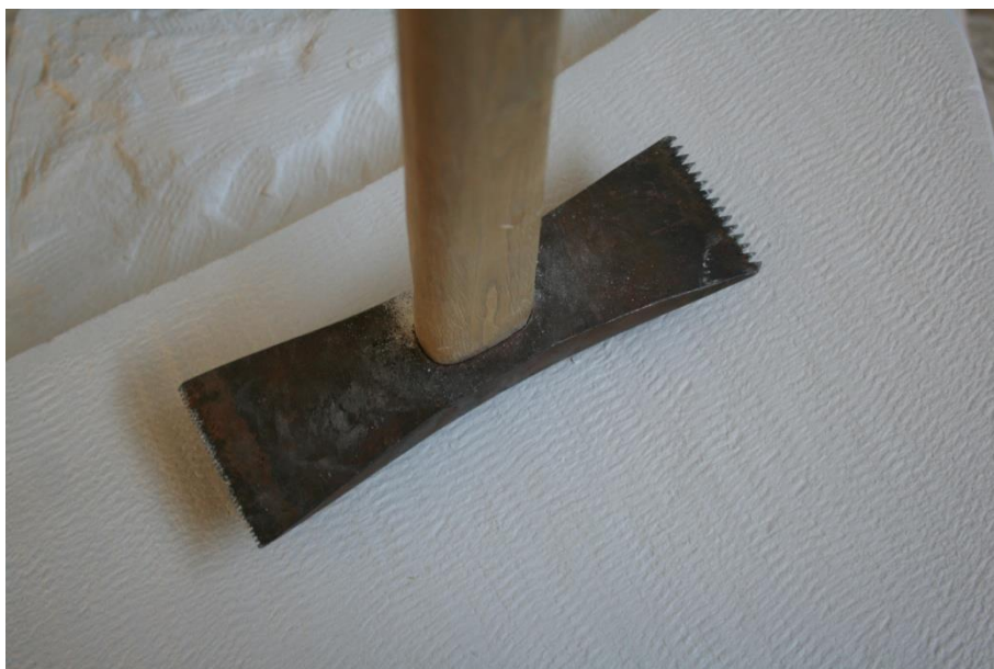
Slika 163. Martelina i tragovi marteline, fotografija: Josipa Krolo
