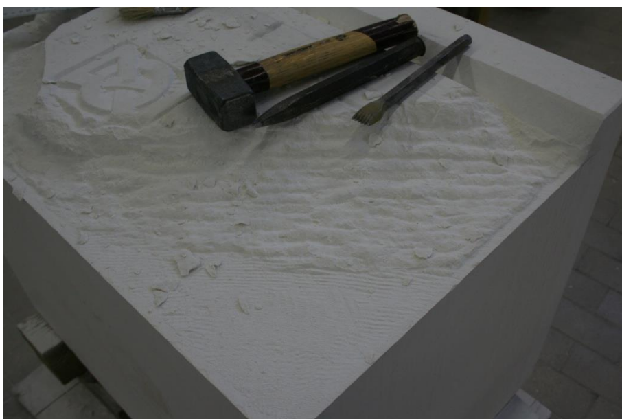
Slika 143. Skidanje kamene mase šiljastim dlijetom, fotografija: Josipa Krolo
