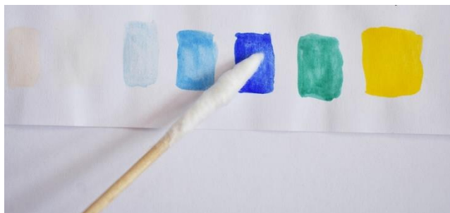
Slika 10 Test veze pigmenta i veziva
