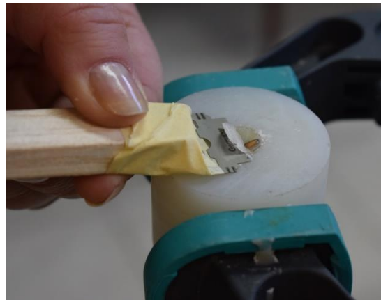
Slika 9 Rezanje uzorka pomoću improviziranog mikrotoma
