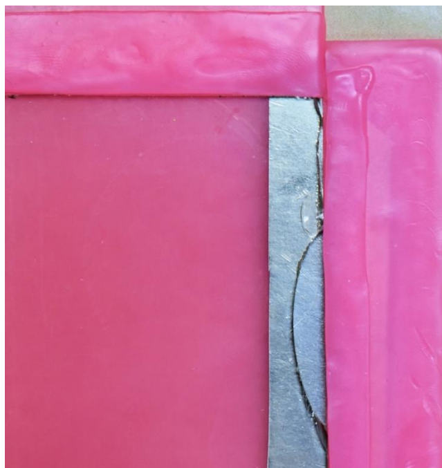
Slika 65 Dental vosak, kalup za lijevanje smole, detalj
