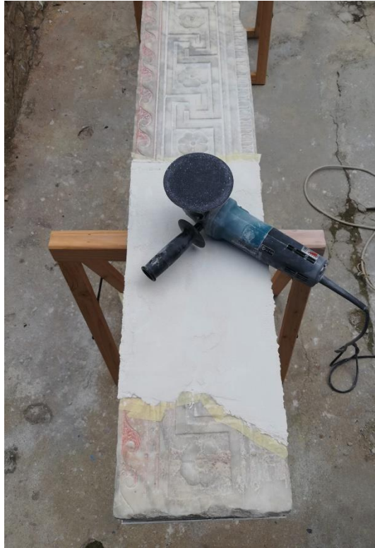
Slika 63: Brušenje Acrystala (foto: A. M. Lučić)
