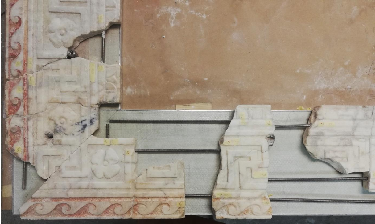
Slika 54: Spajanje “na suho“ (foto: A. M. Lučić)
