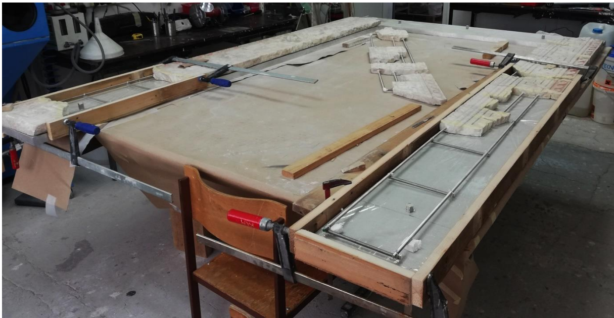
Slika 60: Priprema za lijevanje umjetnoga kamena (foto:A. M. Lučić)
