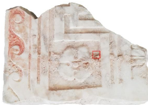
Slika 36: Uzimanje uzoraka žbuke i zona uzorkovanja (foto: A. M. Lučić)
