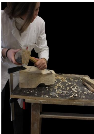
Slika 36: Fiksiranje drva stegom za radni stol
