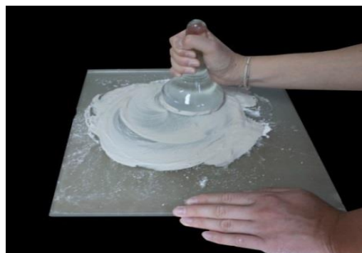
Slika 63: Trvenje gašenog gipsa na staklenoj ploči
