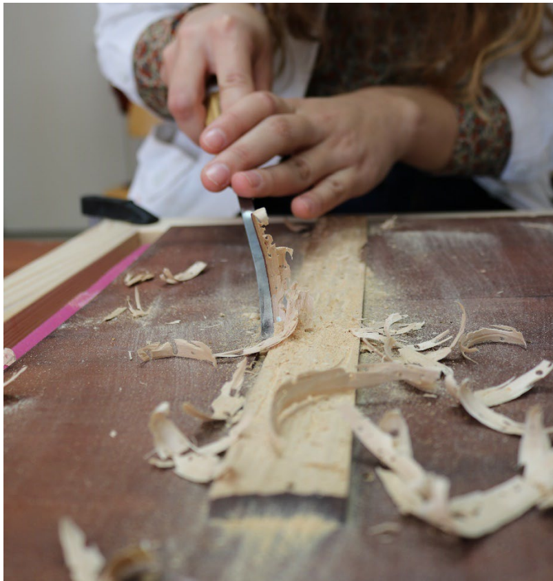
Slika 17 Uklanjanje poprečnih letvi s dlijetom
