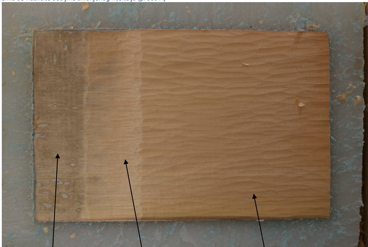
Slika 93 Različite debljine uklonjenog nositelja (proba A)
