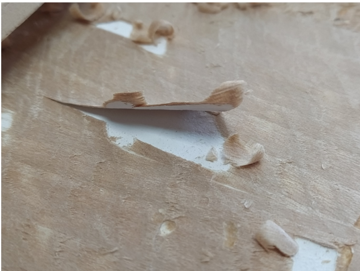
Slika 21 Detalj odvajanja nositelja zajedno s prvim slojem osnove od drugog sloja osnove
