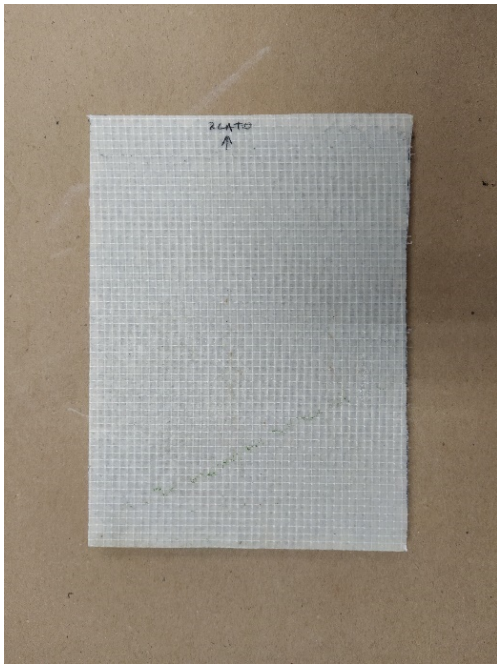
Slika 107 Pločica od aluminijskih saća na koje se prenosi slikani sloj probe B
