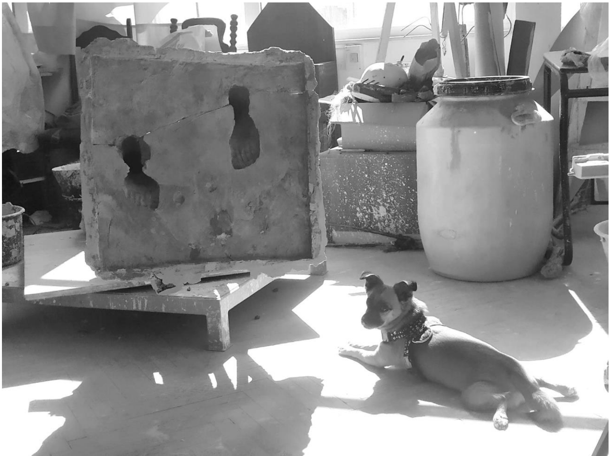
Nakon lijevanja, kalup je postavljen na prednju kapu, na letve koje ga čuvaju od pomicanja i lomljenja
