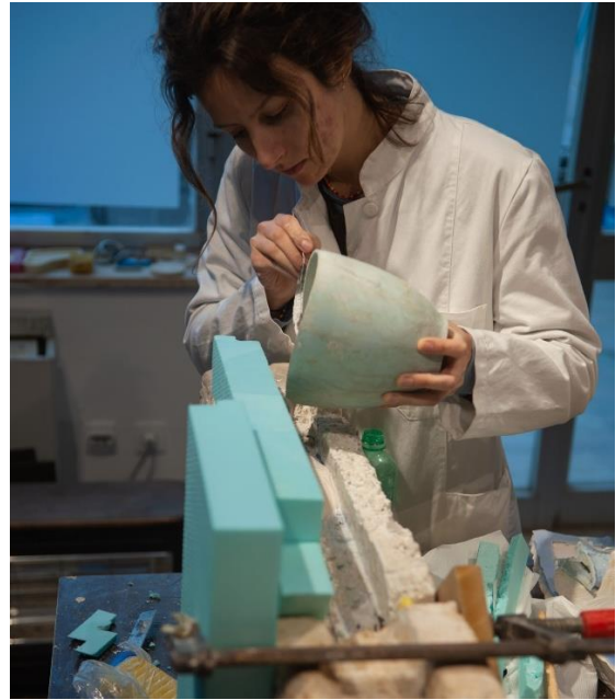
Slika 56 i Slika 57 Lijevanje Acrytalne smjese (autor: Mladen Matijaca)
