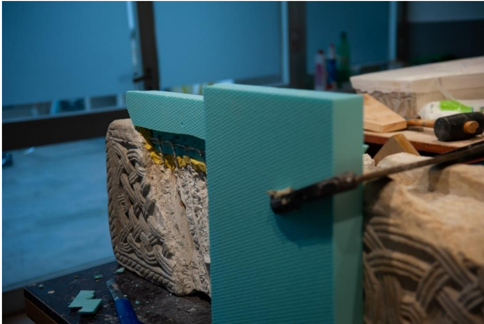
Slika 53 Kalup za lijevanje nove rekonstrukcije (autor: Rina Dubravec)
