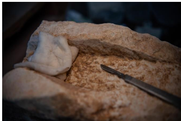
Slika 16 Čišćenje alkoholnim octom (autor: Rina Dubravec)
