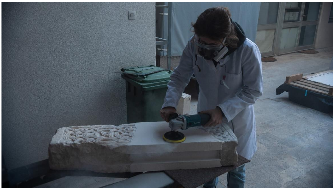
Slika 66 Ravnanje površine Acrystala brusilicom (autor: Zoran Boban)
