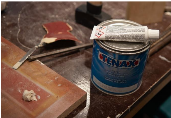
Slika 49 i Slika 50 Poliestersko lijepilo (autor: Rina Dubravec)
