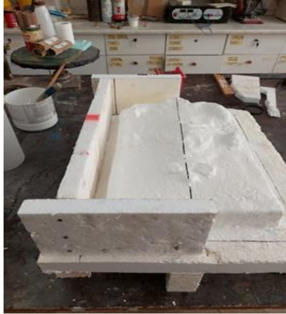
Slika 37, Izrada okvira od stiropora
