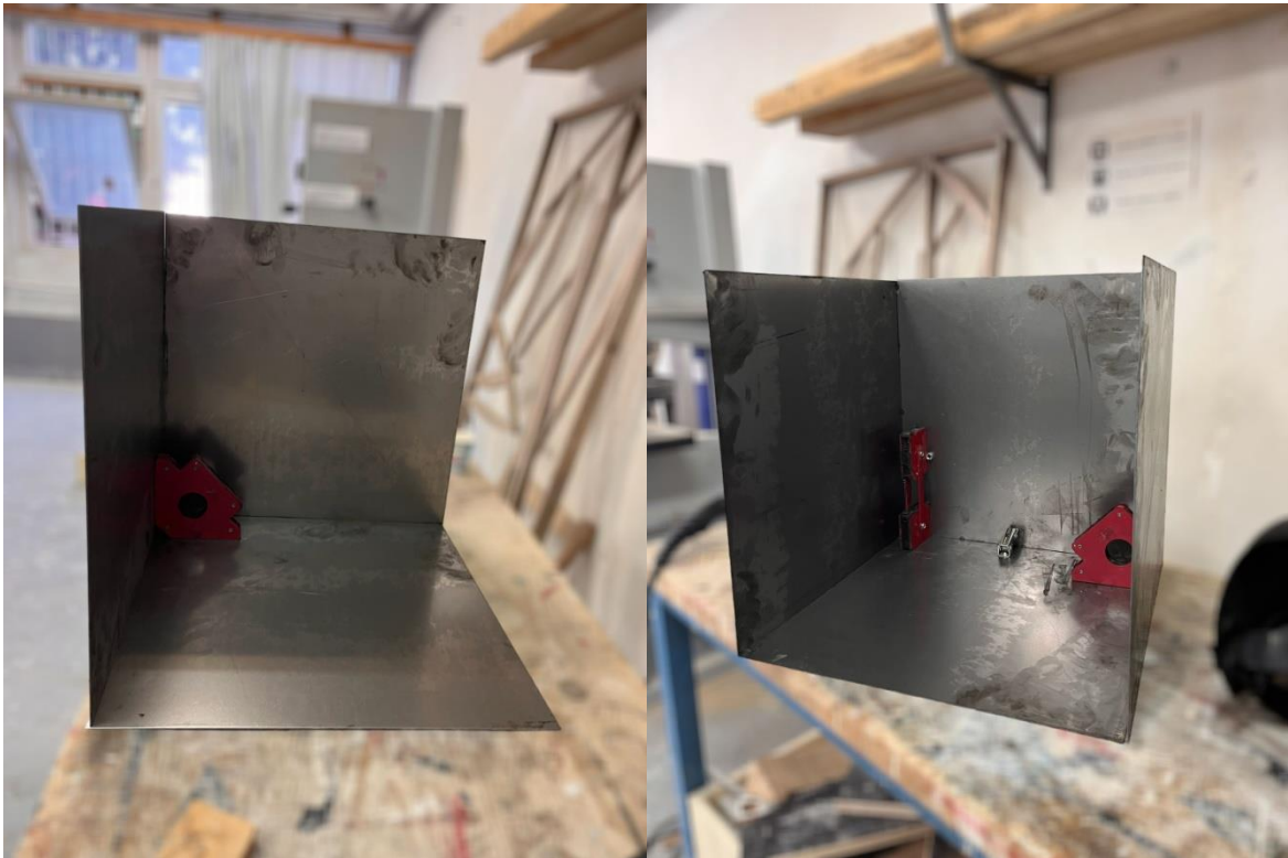
Slika 12. Spajanje lima magnetom
