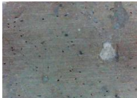
d) uzorak korodiran u otopini NaCl, prijelaz
