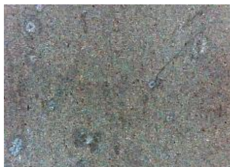
d) uzorak korodiran u otopini NaCl, prijelaz
