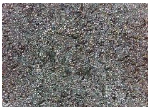
e) uzorak korodiran u otopini HCl, sredina
