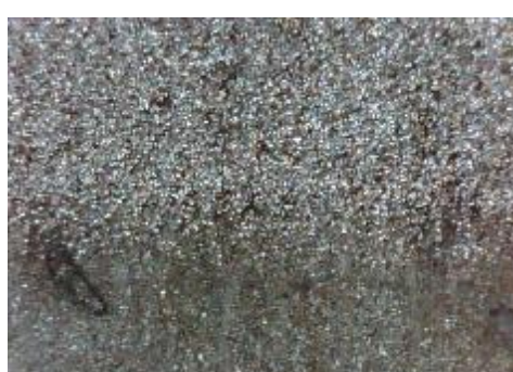
f) uzorak korodiran u otopini HCl, prijelaz
