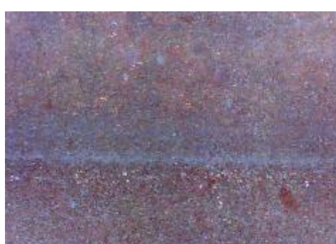
f) uzorak korodiran u otopini HCl, prijelaz
