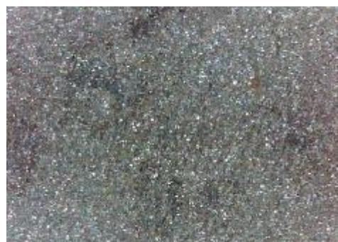
e) uzorak korodiran u otopini HCl, sredina
