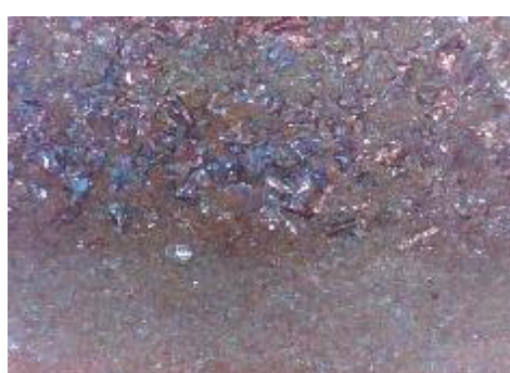
f) uzorak korodiran u otopini HCl, prijelaz
