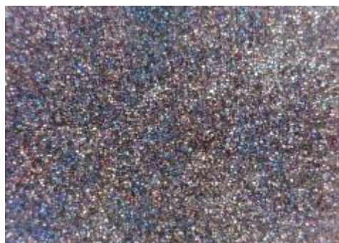
e) uzorak korodiran u otopini HCl, sredina
