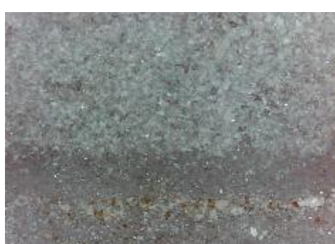
f) uzorak korodiran u otopini HCl, prijelaz
