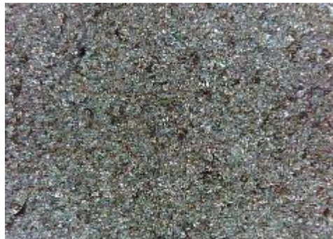
c) uzorak korodiran u otopini NaCl sredina
