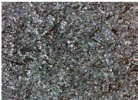
e) uzorak korodiran u otopini HCl, sredina
