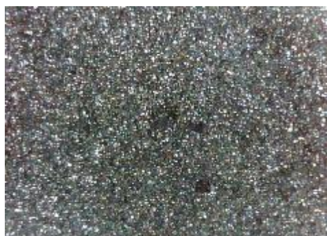
c) uzorak korodiran u otopini NaCl sredina
