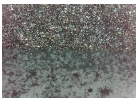
f) uzorak korodiran u otopini HCl, prijelaz
