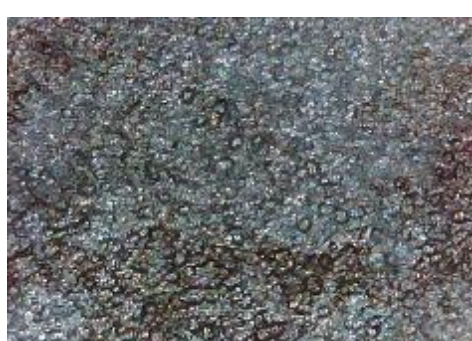
f) uzorak korodiran u otopini HCl, prijelaz
