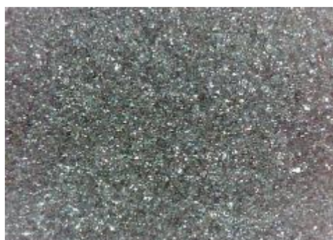
e) uzorak korodiran u otopini HCl, sredina
