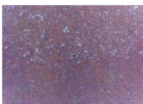
f) uzorak korodiran u otopini HCl, prijelaz
