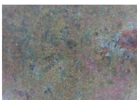
f) uzorak korodiran u otopini HCl, prijelaz
