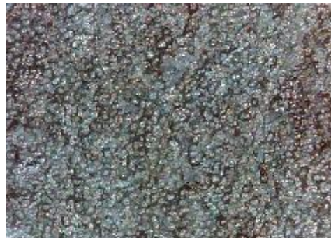
e) uzorak korodiran u otopini HCl, sredina
