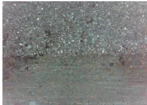
d) uzorak korodiran u otopini NaCl, prijelaz
