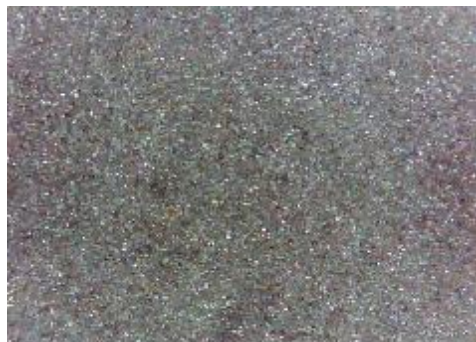
c) uzorak korodiran u otopini NaCl sredina
