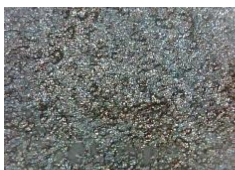
f) uzorak korodiran u otopini HCl, prijelaz
