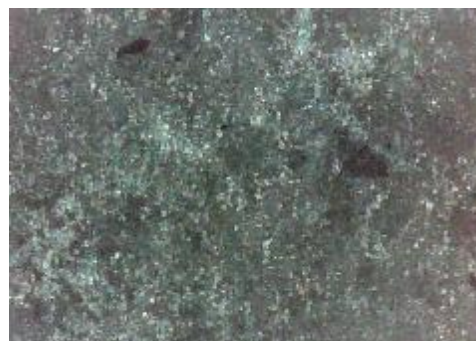
e) uzorak korodiran u otopini HCl, sredina
