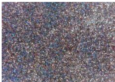
e) uzorak korodiran u otopini HCl, sredina
