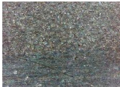
d) uzorak korodiran u otopini NaCl, prijelaz
