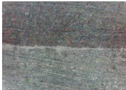
d) uzorak korodiran u otopini NaCl, prijelaz
