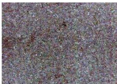
e) uzorak korodiran u otopini HCl, sredina
