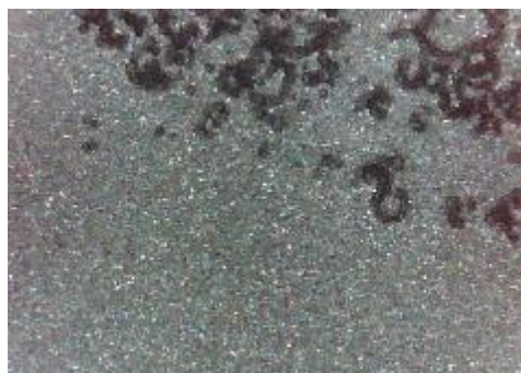
e) uzorak korodiran u otopini HCl, sredina
