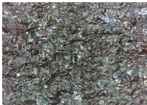
e) uzorak korodiran u otopini HCl, sredina
