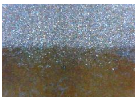
f) uzorak korodiran u otopini HCl, prijelaz
