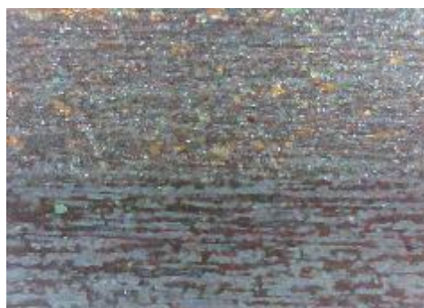
d) uzorak korodiran u otopini NaCl, prijelaz
