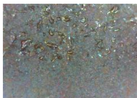
f) uzorak korodiran u otopini HCl, prijelaz
