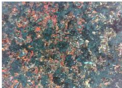
c) uzorak korodiran u otopini NaCl sredina
