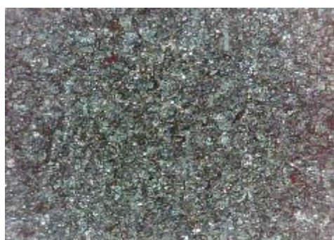
c) uzorak korodiran u otopini NaCl sredina
