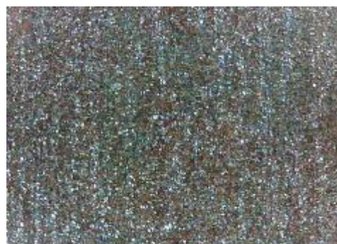
e) uzorak korodiran u otopini HCl, sredina
