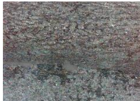
d) uzorak korodiran u otopini NaCl, prijelaz
