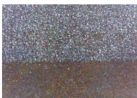
f) uzorak korodiran u otopini HCl, prijelaz
