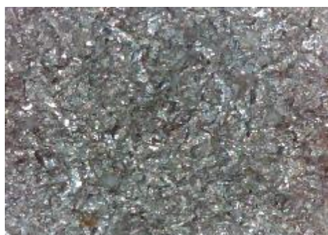
e) uzorak korodiran u otopini HCl, sredina
