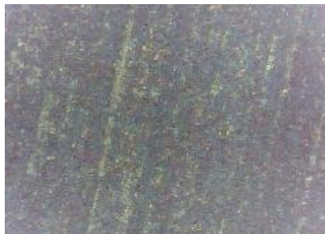
e) uzorak korodiran u otopini HCl, sredina
