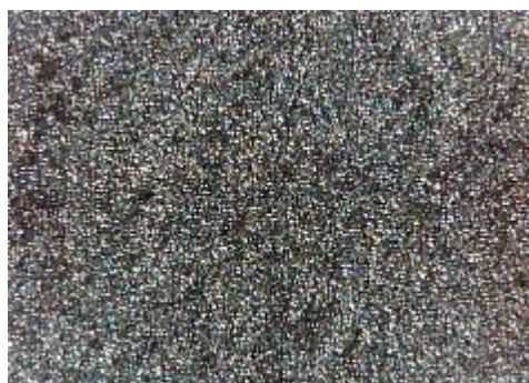
c) uzorak korodiran u otopini NaCl sredina
