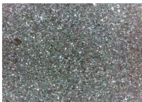
c) uzorak korodiran u otopini NaCl sredina
