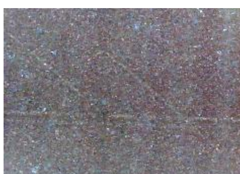
f) uzorak korodiran u otopini HCl, prijelaz
