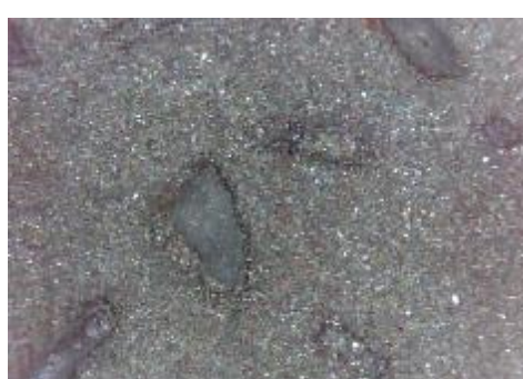
f) uzorak korodiran u otopini HCl, prijelaz
