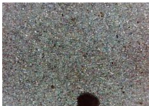
e) uzorak korodiran u otopini HCl, sredina
