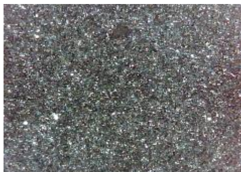
e) uzorak korodiran u otopini HCl, sredina
