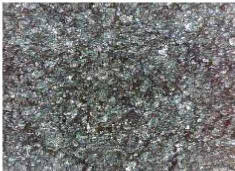
e) uzorak korodiran u otopini HCl, sredina
