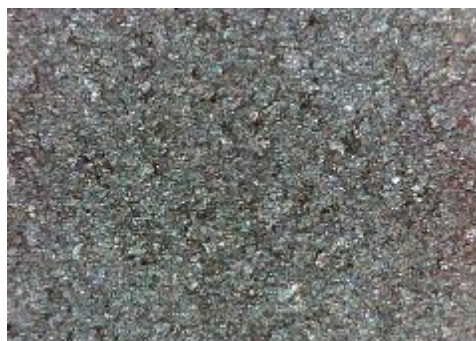
e) uzorak korodiran u otopini HCl, sredina
