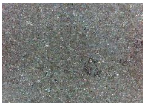
e) uzorak korodiran u otopini HCl, sredina
