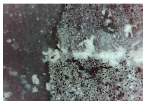
f) uzorak korodiran u otopini HCl, prijelaz
