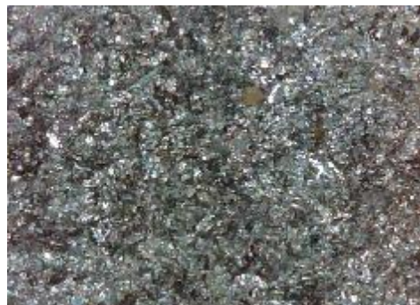
e) uzorak korodiran u otopini HCl, sredina
