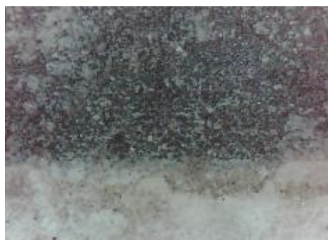
d) uzorak korodiran u otopini NaCl, prijelaz
