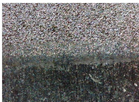
d) uzorak korodiran u otopini NaCl, prijelaz
