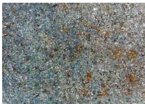
c) uzorak korodiran u otopini NaCl sredina
