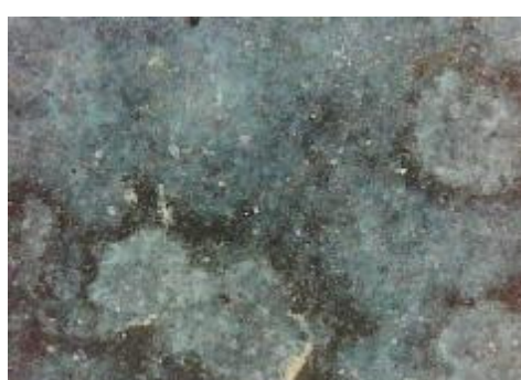
f) uzorak korodiran u otopini HCl, prijelaz
