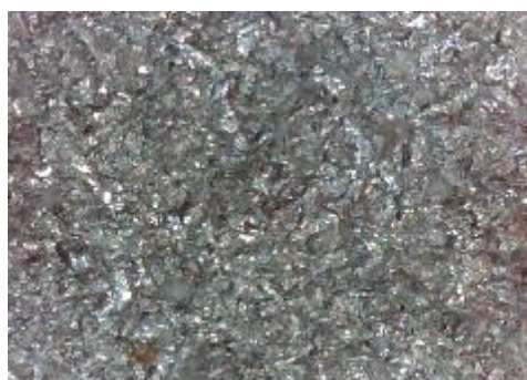
e) uzorak korodiran u otopini HCl, sredina
