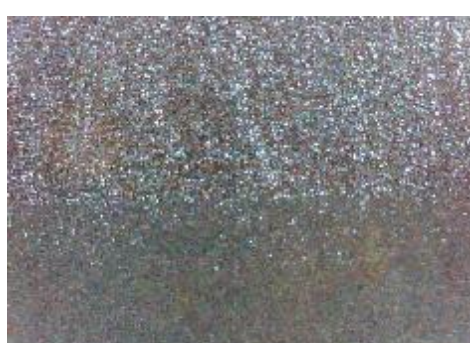
f) uzorak korodiran u otopini HCl, prijelaz
