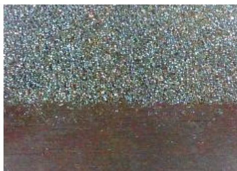
d) uzorak korodiran u otopini NaCl, prijelaz
