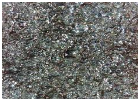
e) uzorak korodiran u otopini HCl, sredina
