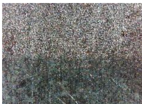
d) uzorak korodiran u otopini NaCl, prijelaz
