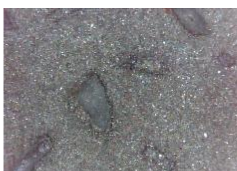
f) uzorak korodiran u otopini HCl, prijelaz
