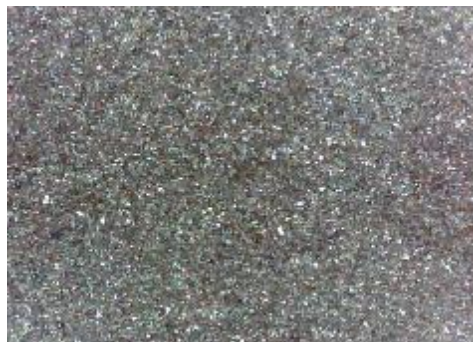
e) uzorak korodiran u otopini HCl, sredina
