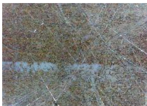
d) uzorak korodiran u otopini NaCl, prijelaz
