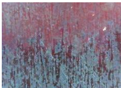
d) uzorak korodiran u otopini NaCl, prijelaz
