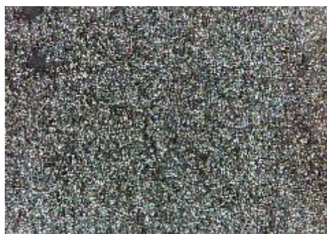
e) uzorak korodiran u otopini HCl, sredina
