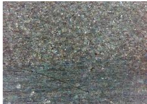
d) uzorak korodiran u otopini NaCl, prijelaz
