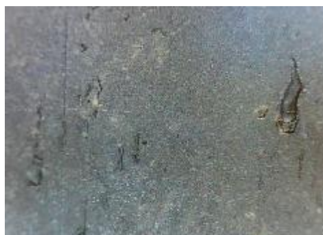
d) uzorak korodiran u otopini NaCl, prijelaz
