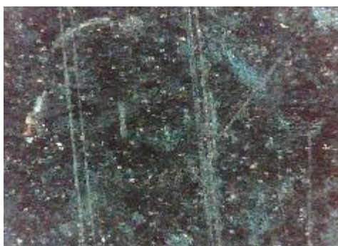
c) uzorak korodiran u otopini NaCl sredina
