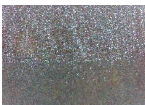
f) uzorak korodiran u otopini HCl, prijelaz
