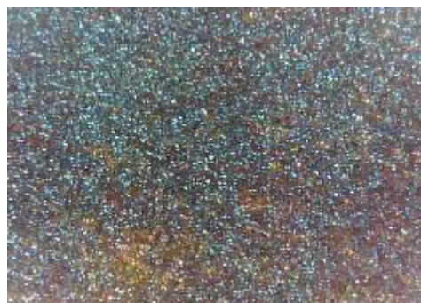
e) uzorak korodiran u otopini HCl, sredina
