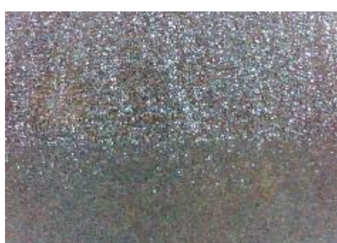
f) uzorak korodiran u otopini HCl, prijelaz
