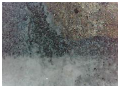
d) uzorak korodiran u otopini NaCl, prijelaz
