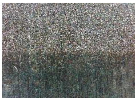
d) uzorak korodiran u otopini NaCl, prijelaz
