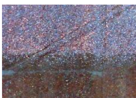
f) uzorak korodiran u otopini HCl, prijelaz
