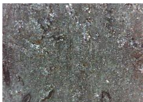
f) uzorak korodiran u otopini HCl, prijelaz
