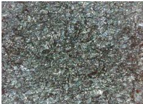
c) uzorak korodiran u otopini NaCl sredina
