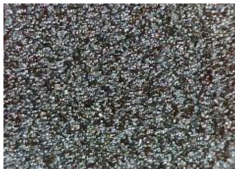
e) uzorak korodiran u otopini HCl, sredina
