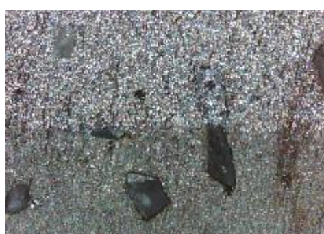
f) uzorak korodiran u otopini HCl, prijelaz
