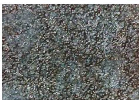
f) uzorak korodiran u otopini HCl, prijelaz
