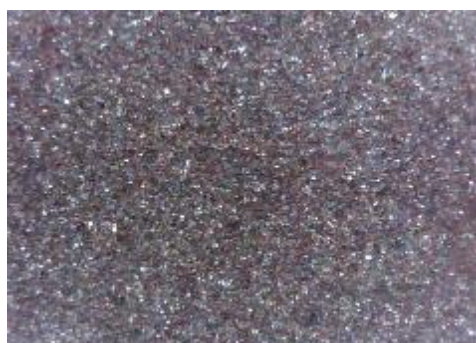
e) uzorak korodiran u otopini HCl, sredina
