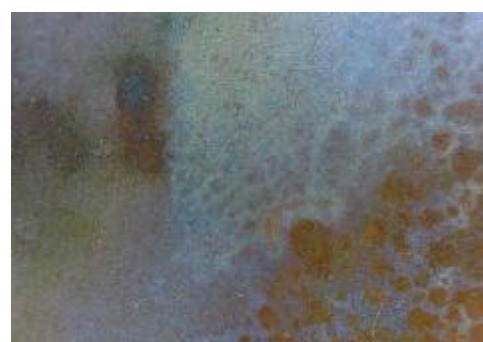
f) uzorak korodiran u otopini HCl, prijelaz
