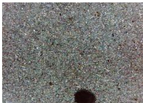
e) uzorak korodiran u otopini HCl, sredina
