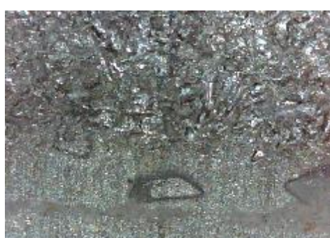
f) uzorak korodiran u otopini HCl, prijelaz
