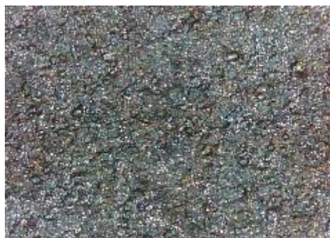
e) uzorak korodiran u otopini HCl, sredina
