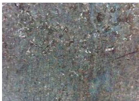
d) uzorak korodiran u otopini NaCl, prijelaz
