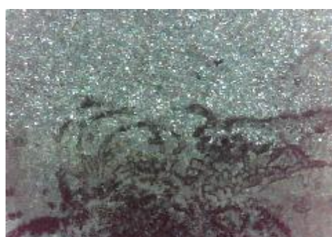
f) uzorak korodiran u otopini HCl, prijelaz
