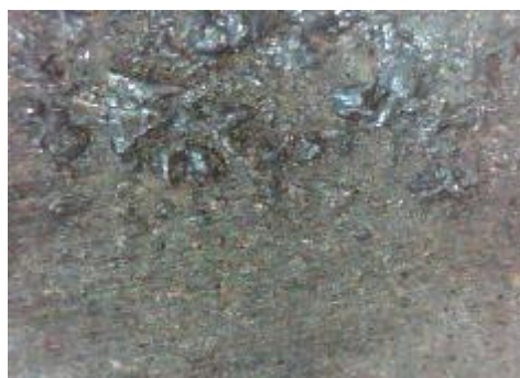
d) uzorak korodiran u otopini NaCl, prijelaz
