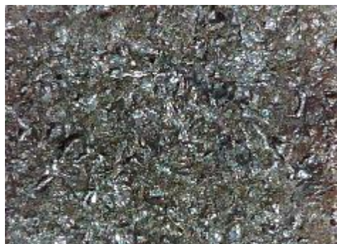
e) uzorak korodiran u otopini HCl, sredina
