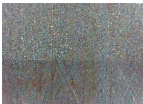
d) uzorak korodiran u otopini NaCl, prijelaz
