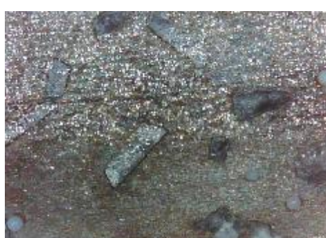
f) uzorak korodiran u otopini HCl, prijelaz
