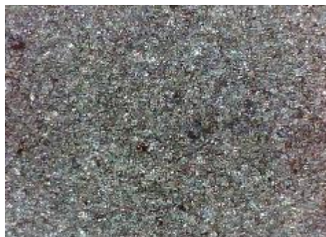
e) uzorak korodiran u otopini HCl, sredina
