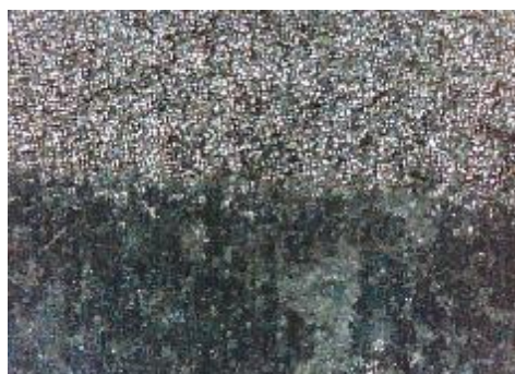
d) uzorak korodiran u otopini NaCl, prijelaz
