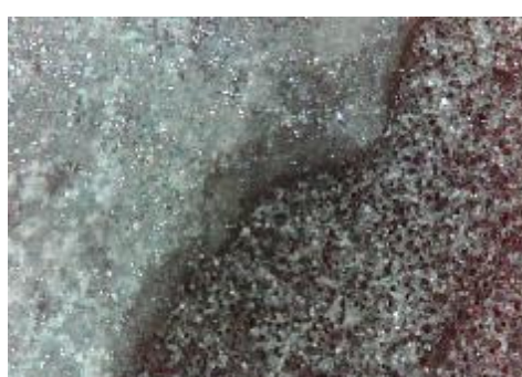
f) uzorak korodiran u otopini HCl, prijelaz
