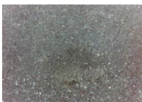
f) uzorak korodiran u otopini HCl, prijelaz
