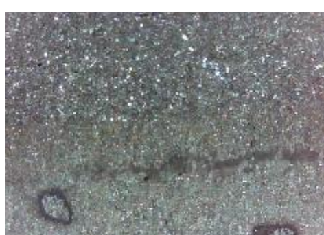
f) uzorak korodiran u otopini HCl, prijelaz
