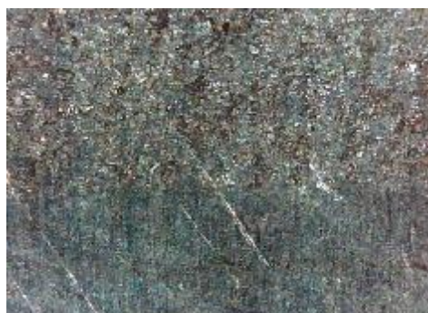
d) uzorak korodiran u otopini NaCl, prijelaz
