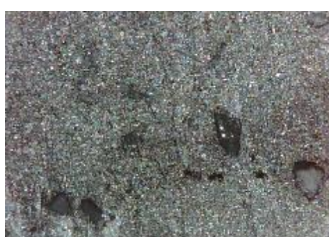
f) uzorak korodiran u otopini HCl, prijelaz
