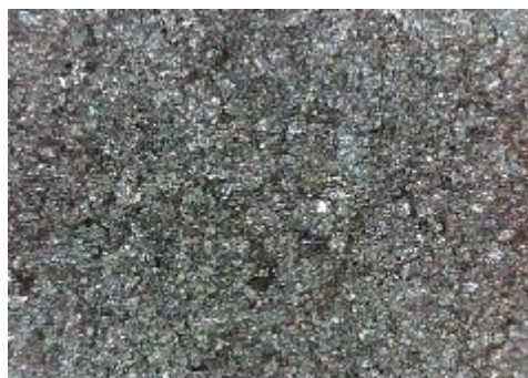
e) uzorak korodiran u otopini HCl, sredina
