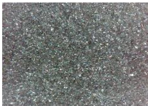
e) uzorak korodiran u otopini HCl, sredina
