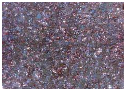
e) uzorak korodiran u otopini HCl, sredina
