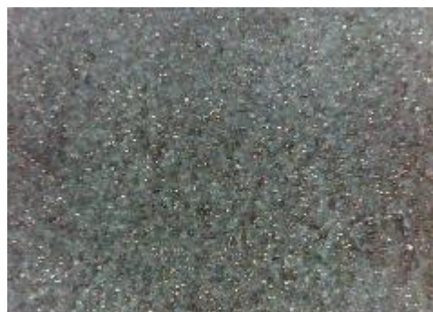
e) uzorak korodiran u otopini HCl, sredina
