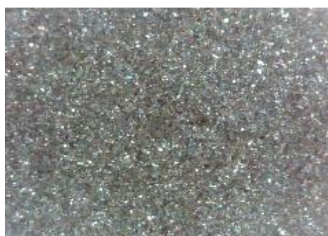
c) uzorak korodiran u otopini NaCl sredina
