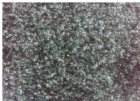
e) uzorak korodiran u otopini HCl, sredina
