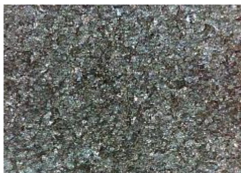
c) uzorak korodiran u otopini NaCl sredina
