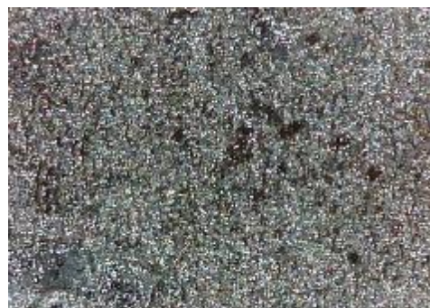
e) uzorak korodiran u otopini HCl, sredina
