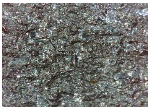
e) uzorak korodiran u otopini HCl, sredina
