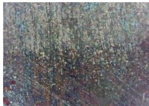
h) uzorak korodiran u otopini Na 2 S 2 O 5 , prijelaz
