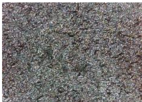
e) uzorak korodiran u otopini HCl, sredina
