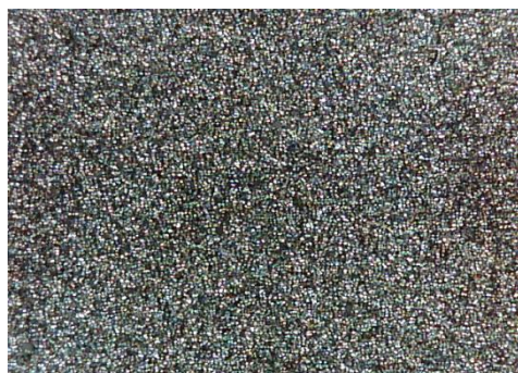
c) uzorak korodiran u otopini NaCl sredina
