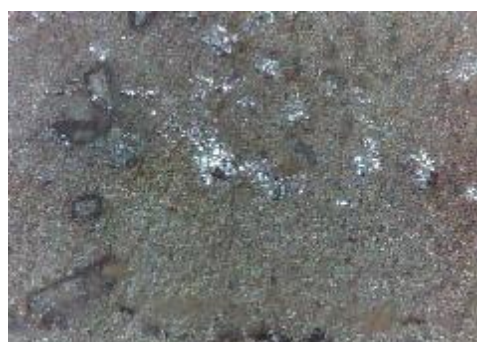
f) uzorak korodiran u otopini HCl, prijelaz
