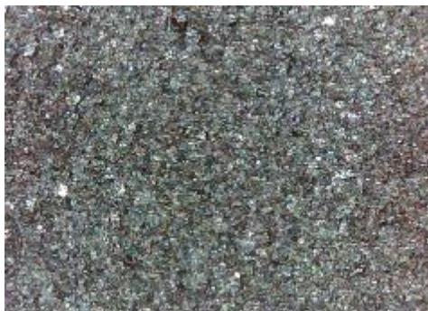
c) uzorak korodiran u otopini NaCl sredina
