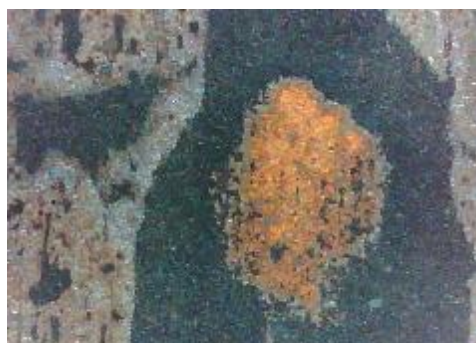
c) uzorak korodiran u otopini NaCl sredina
