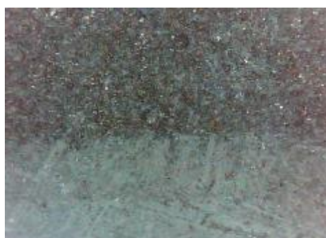
d) uzorak korodiran u otopini NaCl, prijelaz
