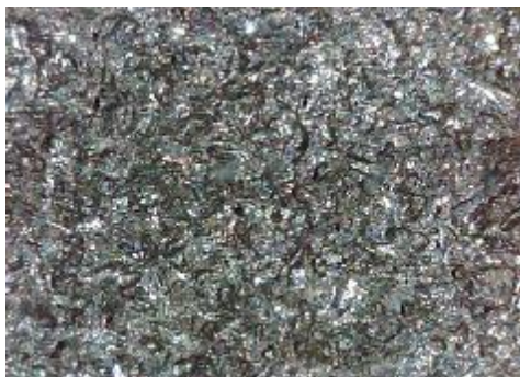
c) uzorak korodiran u otopini NaCl sredina
