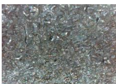
f) uzorak korodiran u otopini HCl, prijelaz
