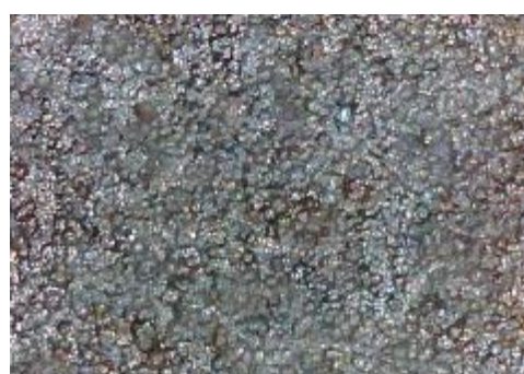
f) uzorak korodiran u otopini HCl, prijelaz
