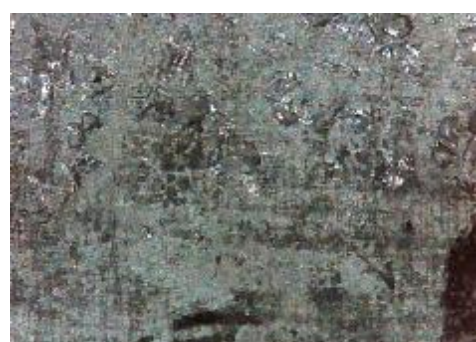
f) uzorak korodiran u otopini HCl, prijelaz
