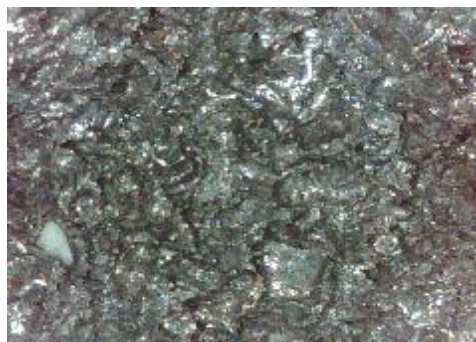
e) uzorak korodiran u otopini HCl, sredina
