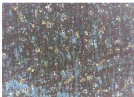
d) uzorak korodiran u otopini NaCl, prijelaz
