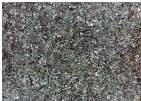
e) uzorak korodiran u otopini HCl, sredina
