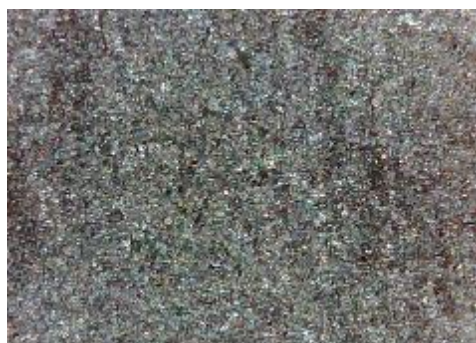
c) uzorak korodiran u otopini NaCl sredina
