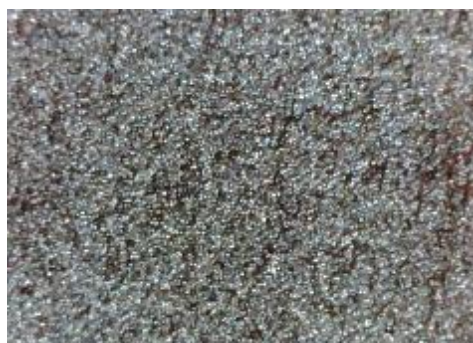
e) uzorak korodiran u otopini HCl, sredina
