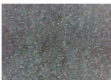
f) uzorak korodiran u otopini HCl, prijelaz
