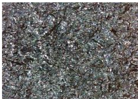
e) uzorak korodiran u otopini HCl, sredina
