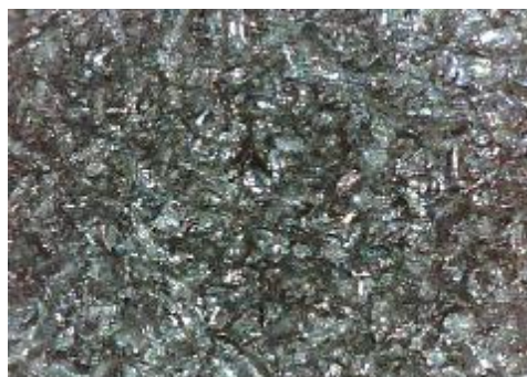
e) uzorak korodiran u otopini HCl, sredina
