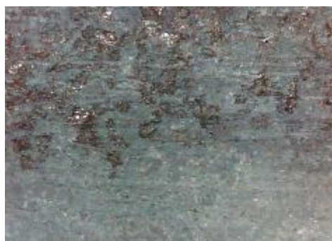
d) uzorak korodiran u otopini NaCl, prijelaz
