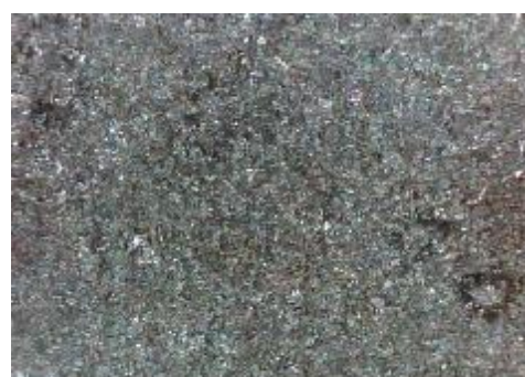
f) uzorak korodiran u otopini HCl, prijelaz
