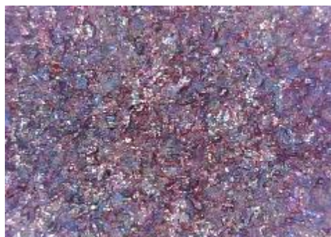
e) uzorak korodiran u otopini HCl, sredina
