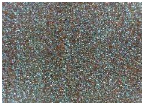
e) uzorak korodiran u otopini HCl, sredina
