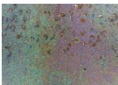
f) uzorak korodiran u otopini HCl, prijelaz
