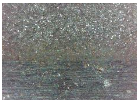
d) uzorak korodiran u otopini NaCl, prijelaz
