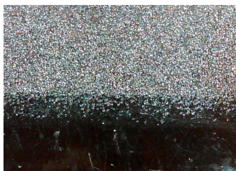
d) uzorak korodiran u otopini NaCl, prijelaz
