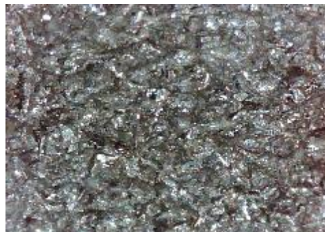
e) uzorak korodiran u otopini HCl, sredina
