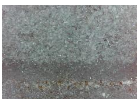
f) uzorak korodiran u otopini HCl, prijelaz
