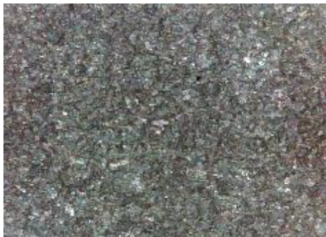
e) uzorak korodiran u otopini HCl, sredina
