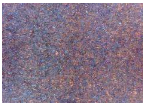
e) uzorak korodiran u otopini HCl, sredina
