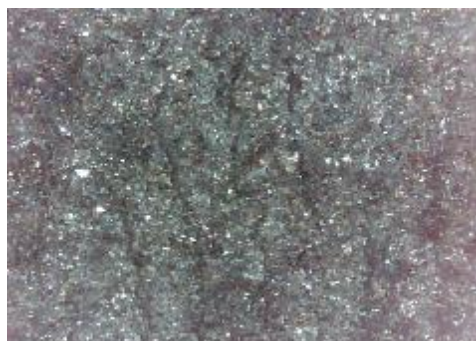
e) uzorak korodiran u otopini HCl, sredina
