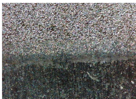
d) uzorak korodiran u otopini NaCl, prijelaz
