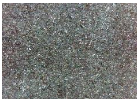
e) uzorak korodiran u otopini HCl, sredina
