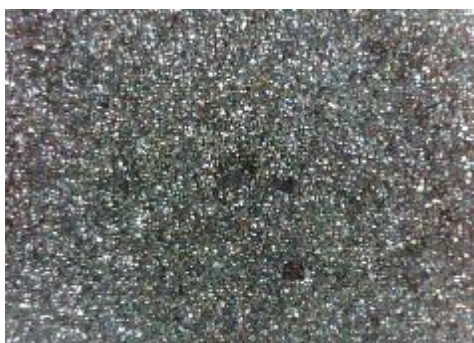
c) uzorak korodiran u otopini NaCl sredina
