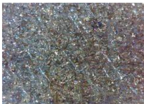
c) uzorak korodiran u otopini NaCl sredina
