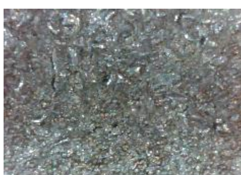
f) uzorak korodiran u otopini HCl, prijelaz
