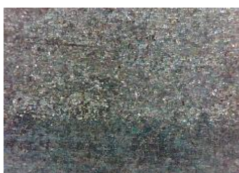
f) uzorak korodiran u otopini HCl, prijelaz
