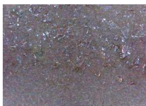
f) uzorak korodiran u otopini HCl, prijelaz
