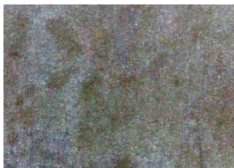
e) uzorak korodiran u otopini HCl, sredina
