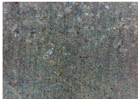
d) uzorak korodiran u otopini NaCl, prijelaz
