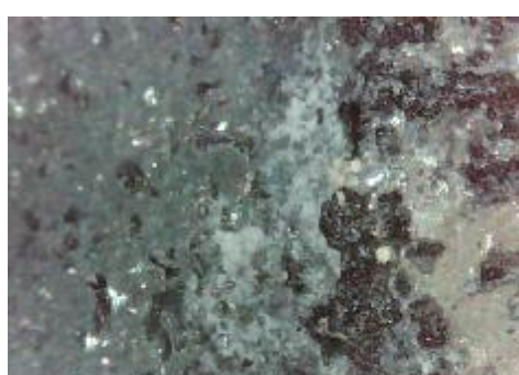
f) uzorak korodiran u otopini HCl, prijelaz
