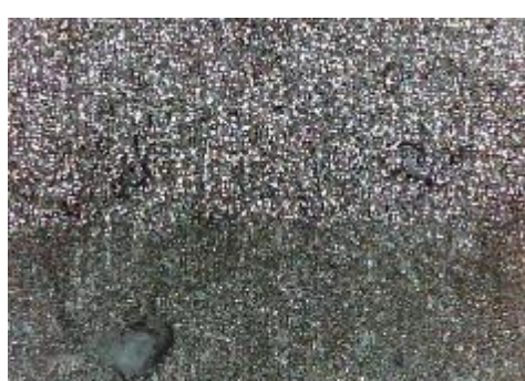
f) uzorak korodiran u otopini HCl, prijelaz
