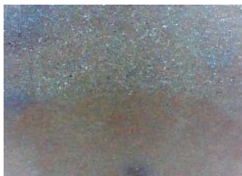
d) uzorak korodiran u otopini NaCl, prijelaz
