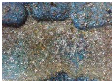
d) uzorak korodiran u otopini NaCl, prijelaz
