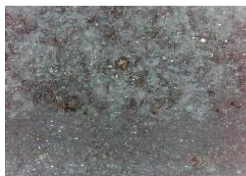
f) uzorak korodiran u otopini HCl, prijelaz
