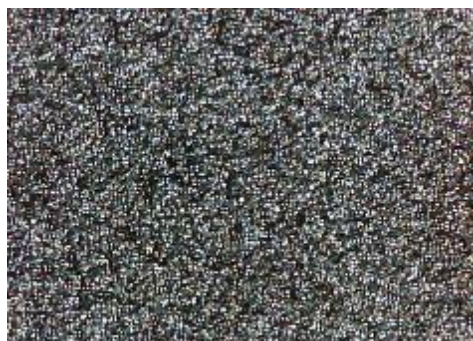
e) uzorak korodiran u otopini HCl, sredina
