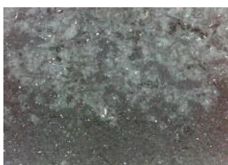
f) uzorak korodiran u otopini HCl, prijelaz
