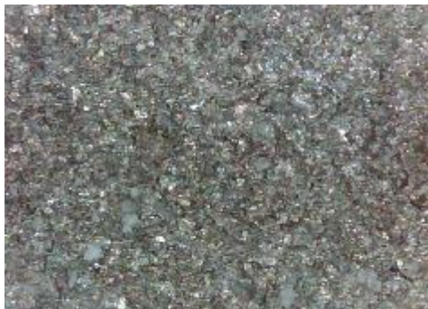
c) uzorak korodiran u otopini NaCl sredina
