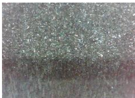
h) uzorak korodiran u otopini Na 2 S 2 O 5 , prijelaz
