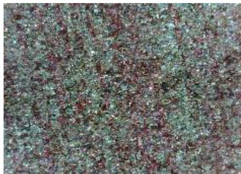
e) uzorak korodiran u otopini HCl, sredina
