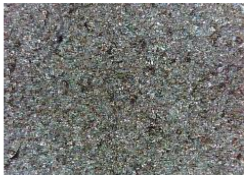
c) uzorak korodiran u otopini NaCl sredina
