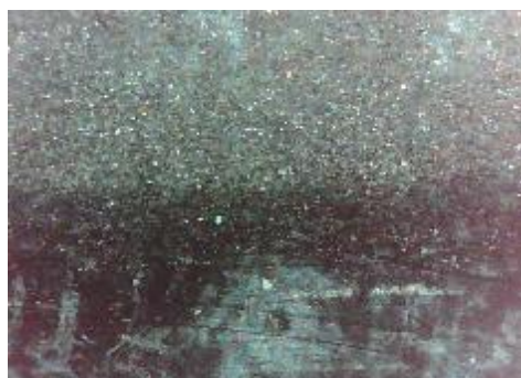
d) uzorak korodiran u otopini NaCl, prijelaz
