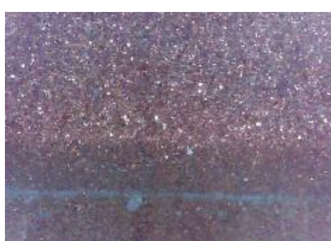
f) uzorak korodiran u otopini HCl, prijelaz
