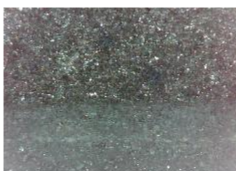
f) uzorak korodiran u otopini HCl, prijelaz
