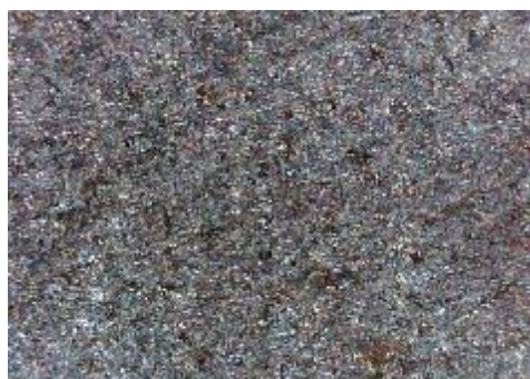
e) uzorak korodiran u otopini HCl, sredina
