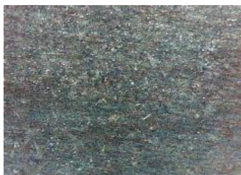
d) uzorak korodiran u otopini NaCl, prijelaz
