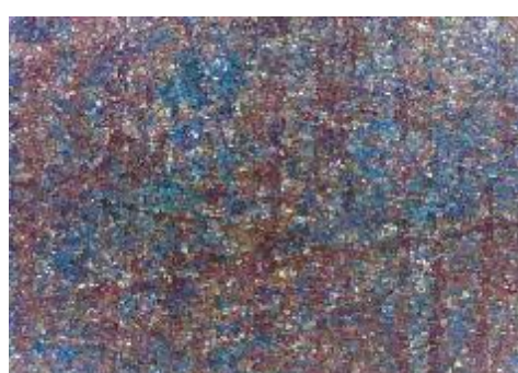
f) uzorak korodiran u otopini HCl, prijelaz
