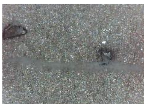
f) uzorak korodiran u otopini HCl, prijelaz
