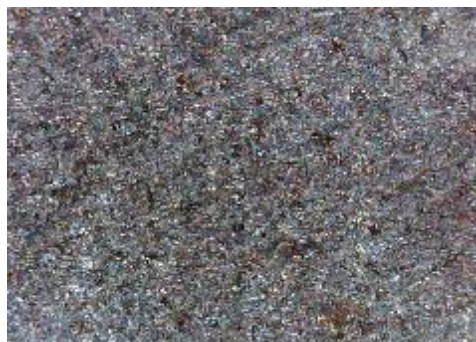
e) uzorak korodiran u otopini HCl, sredina
