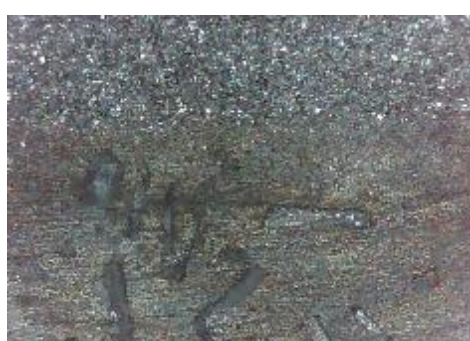
f) uzorak korodiran u otopini HCl, prijelaz
