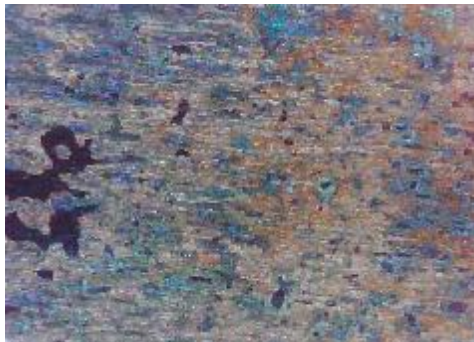
c) uzorak korodiran u otopini NaCl sredina
