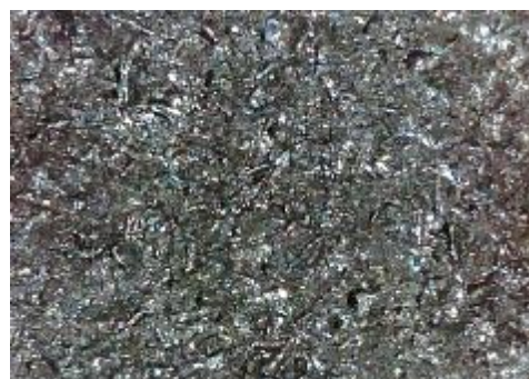
e) uzorak korodiran u otopini HCl, sredina
