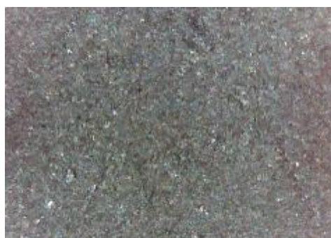
e) uzorak korodiran u otopini HCl, sredina
