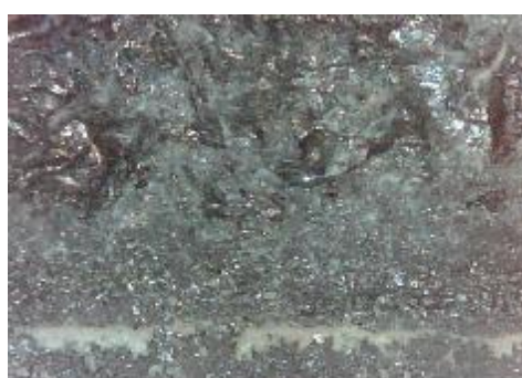
f) uzorak korodiran u otopini HCl, prijelaz
