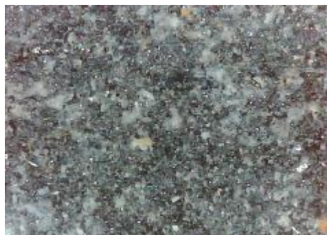
g) uzorak korodiran u otopini Na 2 S 2 O 5 , sredina
