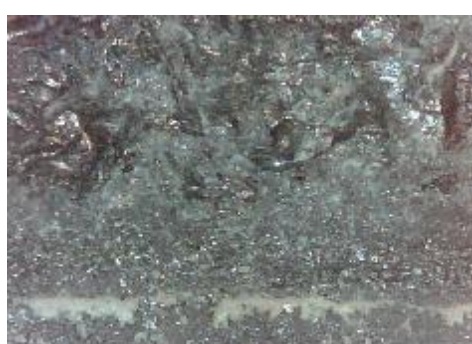
f) uzorak korodiran u otopini HCl, prijelaz
