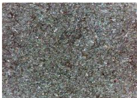
c) uzorak korodiran u otopini NaCl sredina
