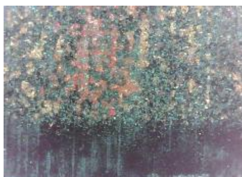
d) uzorak korodiran u otopini NaCl, prijelaz
