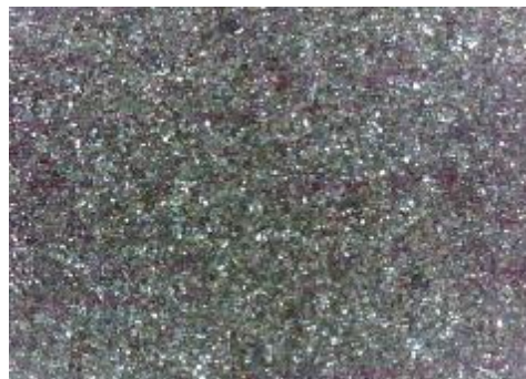
e) uzorak korodiran u otopini HCl, sredina
