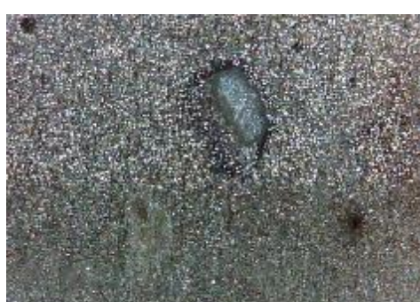
f) uzorak korodiran u otopini HCl, prijelaz
