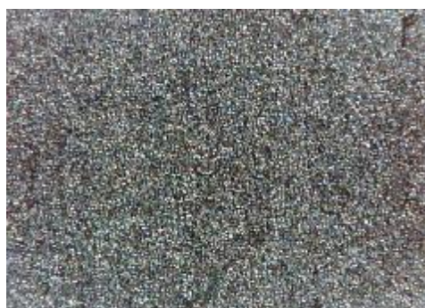
c) uzorak korodiran u otopini NaCl sredina
