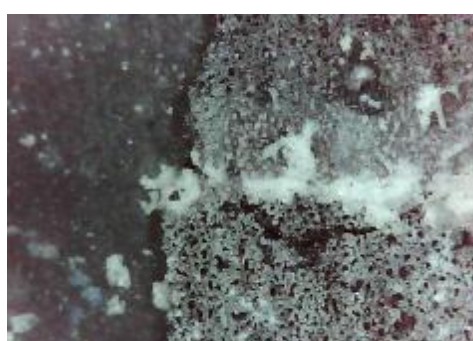
f) uzorak korodiran u otopini HCl, prijelaz
