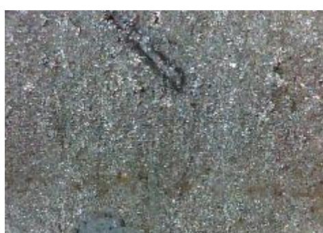
f) uzorak korodiran u otopini HCl, prijelaz
