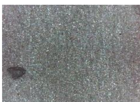
f) uzorak korodiran u otopini HCl, prijelaz
