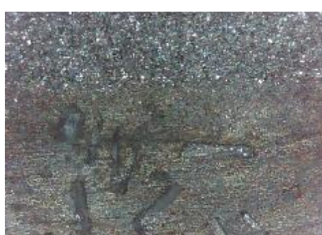
f) uzorak korodiran u otopini HCl, prijelaz
