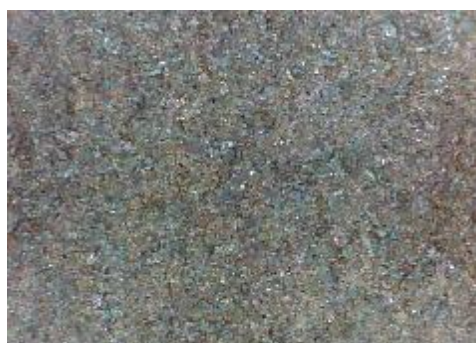
c) uzorak korodiran u otopini NaCl sredina
