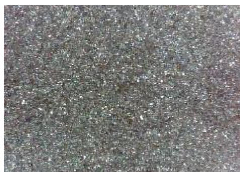
e) uzorak korodiran u otopini HCl, sredina
