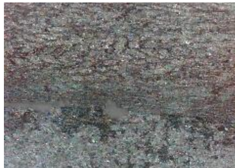
d) uzorak korodiran u otopini NaCl, prijelaz
