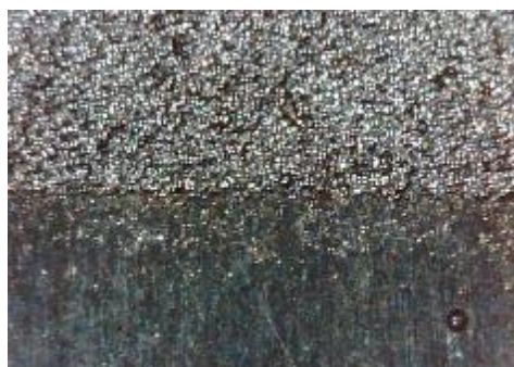
b) nekorodirani uzorak, prijelaz
