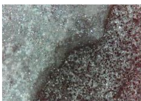
f) uzorak korodiran u otopini HCl, prijelaz
