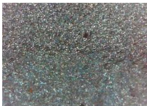
b) nekorodirani uzorak, prijelaz
