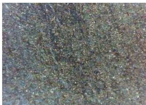
c) uzorak korodiran u otopini NaCl sredina
