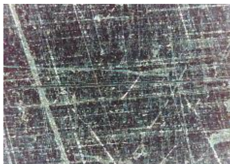
b) nekorodirani uzorak, prijelaz
