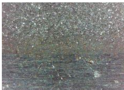
d) uzorak korodiran u otopini NaCl, prijelaz
