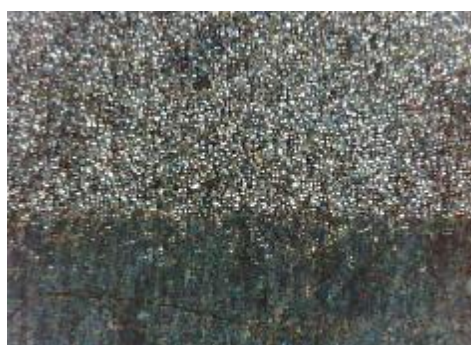
d) uzorak korodiran u otopini NaCl, prijelaz
