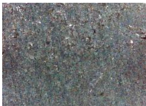
d) uzorak korodiran u otopini NaCl, prijelaz
