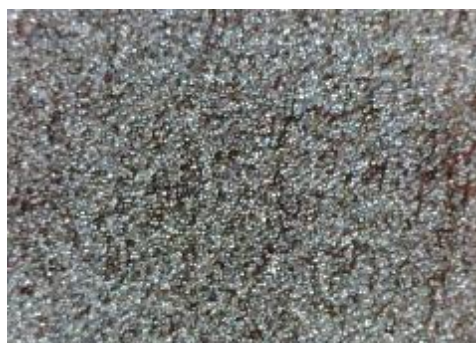
e) uzorak korodiran u otopini HCl, sredina
