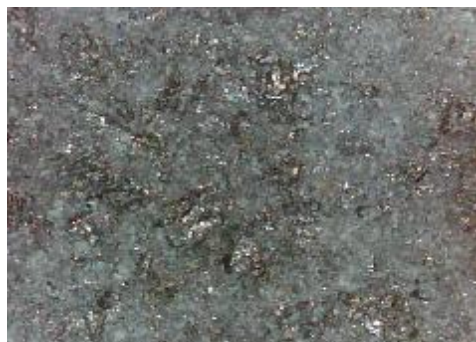
e) uzorak korodiran u otopini HCl, sredina
