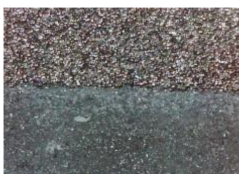
f) uzorak korodiran u otopini HCl, prijelaz
