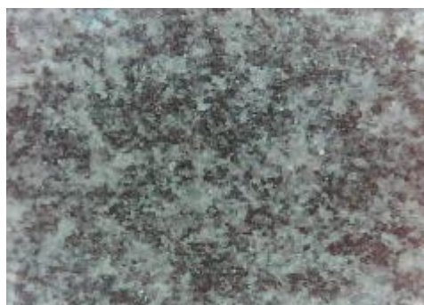
c) uzorak korodiran u otopini NaCl sredina
