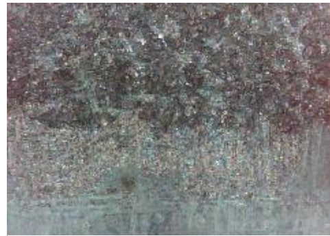
d) uzorak korodiran u otopini NaCl, prijelaz
