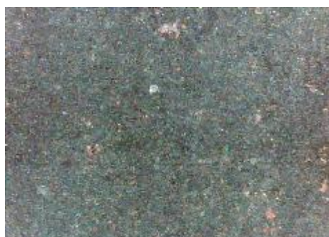
c) uzorak korodiran u otopini NaCl sredina
