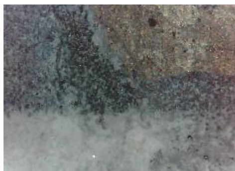
d) uzorak korodiran u otopini NaCl, prijelaz
