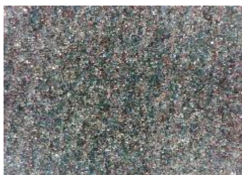
c) uzorak korodiran u otopini NaCl sredina
