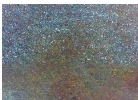
f) uzorak korodiran u otopini HCl, prijelaz
