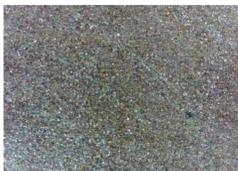
c) uzorak korodiran u otopini NaCl sredina
