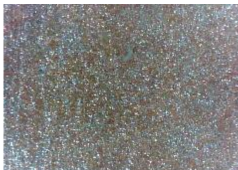
e) uzorak korodiran u otopini HCl, sredina
