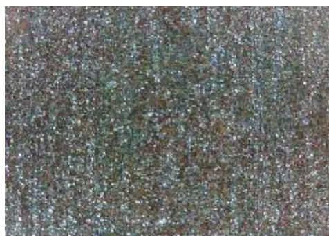
e) uzorak korodiran u otopini HCl, sredina
