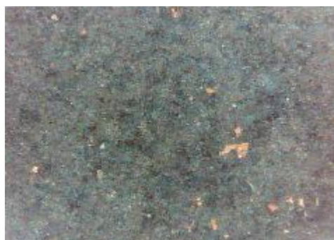
c) uzorak korodiran u otopini NaCl sredina
