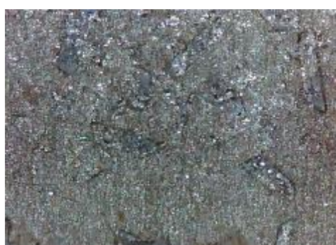
f) uzorak korodiran u otopini HCl, prijelaz
