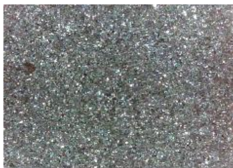
c) uzorak korodiran u otopini NaCl sredina
