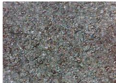
e) uzorak korodiran u otopini HCl, sredina
