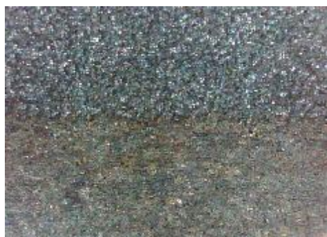
d) uzorak korodiran u otopini NaCl, prijelaz
