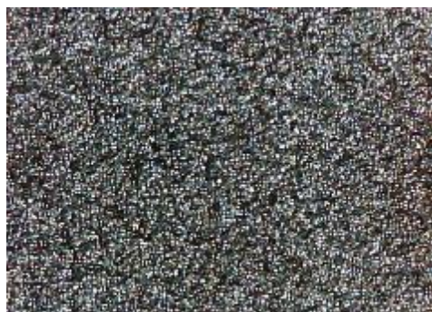
e) uzorak korodiran u otopini HCl, sredina
