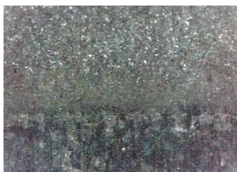
d) uzorak korodiran u otopini NaCl, prijelaz
