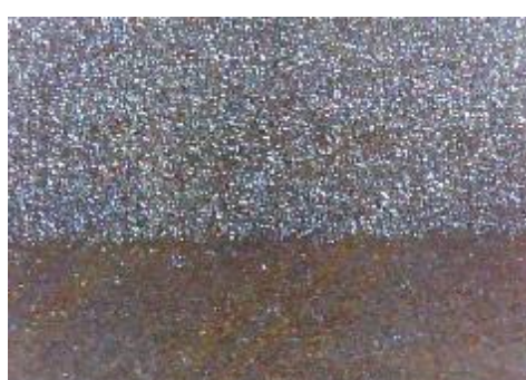
f) uzorak korodiran u otopini HCl, prijelaz
