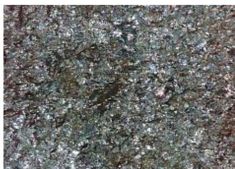
c) uzorak korodiran u otopini NaCl sredina
