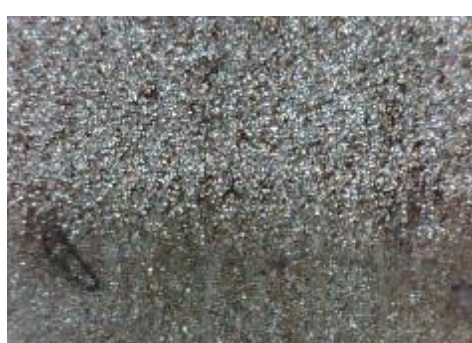
f) uzorak korodiran u otopini HCl, prijelaz
