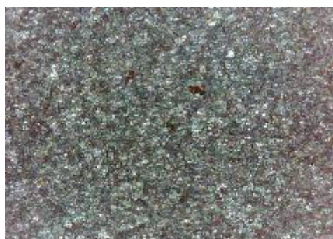
e) uzorak korodiran u otopini HCl, sredina
