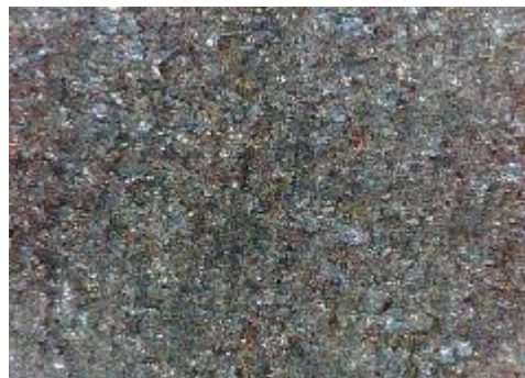
c) uzorak korodiran u otopini NaCl sredina
