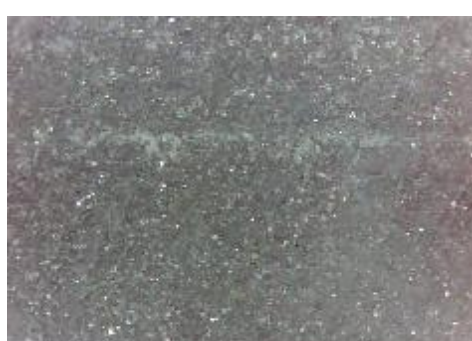
f) uzorak korodiran u otopini HCl, prijelaz
