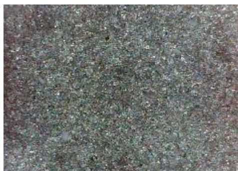
c) uzorak korodiran u otopini NaCl sredina
