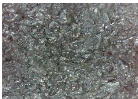
c) uzorak korodiran u otopini NaCl sredina
