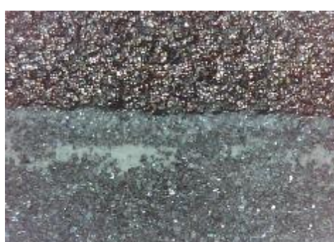
f) uzorak korodiran u otopini HCl, prijelaz
