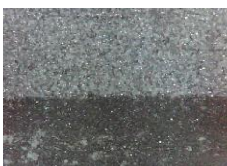
f) uzorak korodiran u otopini HCl, prijelaz
