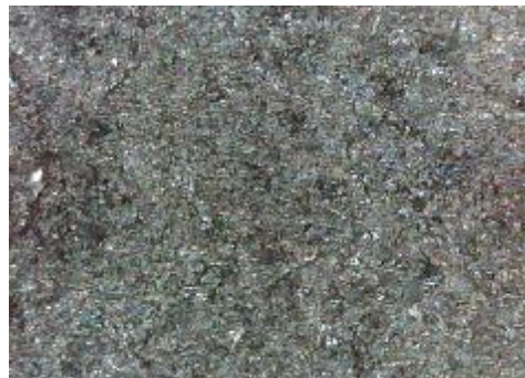
e) uzorak korodiran u otopini HCl, sredina
