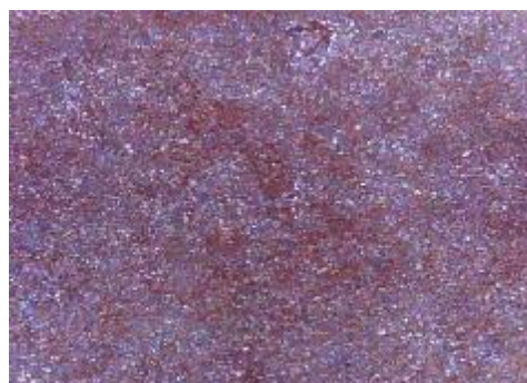
e) uzorak korodiran u otopini HCl, sredina
