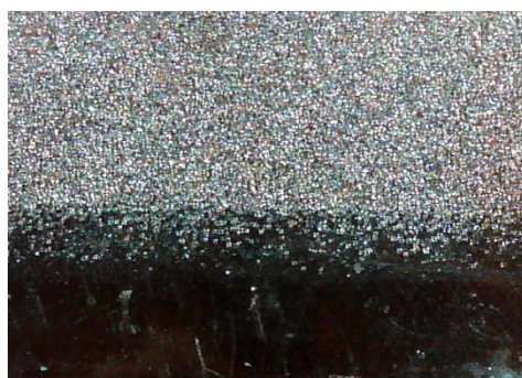
d) uzorak korodiran u otopini NaCl, prijelaz
