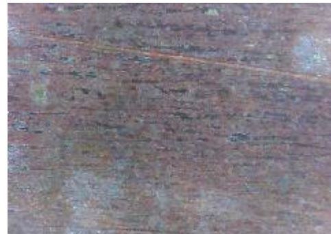
d) uzorak korodiran u otopini NaCl, prijelaz
