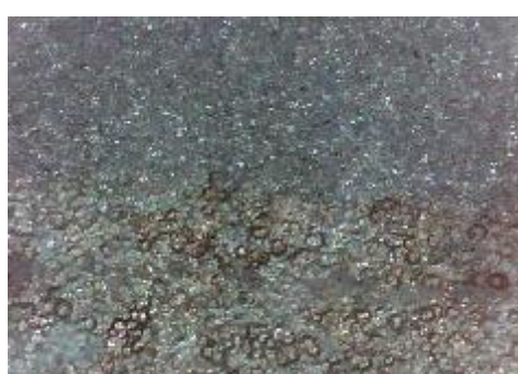
f) uzorak korodiran u otopini HCl, prijelaz
