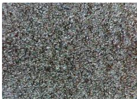
e) uzorak korodiran u otopini HCl, sredina
