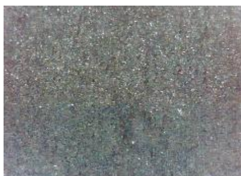
d) uzorak korodiran u otopini NaCl, prijelaz
