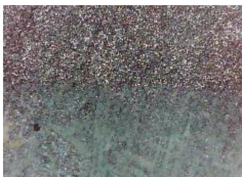
d) uzorak korodiran u otopini NaCl, prijelaz
