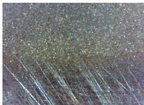
d) uzorak korodiran u otopini NaCl, prijelaz
