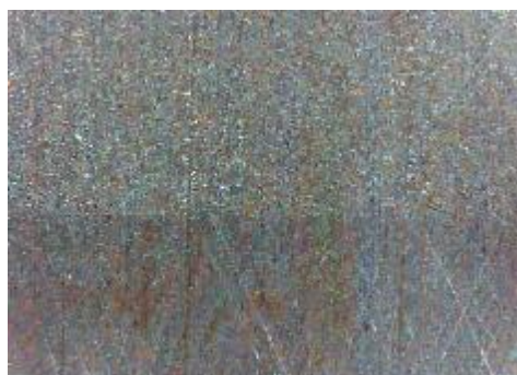
d) uzorak korodiran u otopini NaCl, prijelaz
