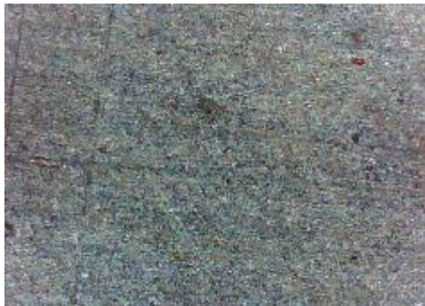
c) uzorak korodiran u otopini NaCl sredina
