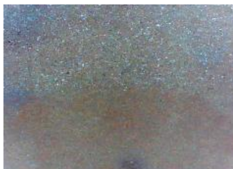
d) uzorak korodiran u otopini NaCl, prijelaz
