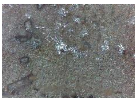
f) uzorak korodiran u otopini HCl, prijelaz
