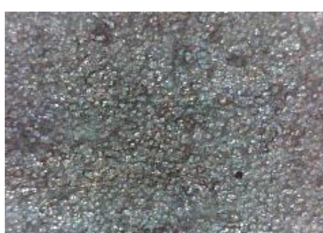
f) uzorak korodiran u otopini HCl, prijelaz
