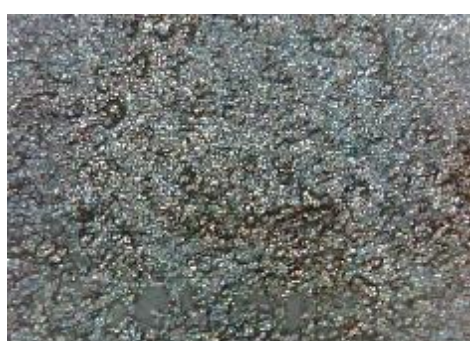
f) uzorak korodiran u otopini HCl, prijelaz
