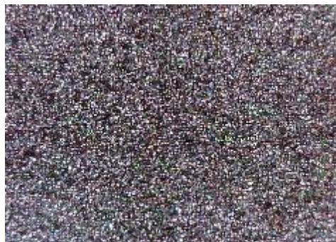
e) uzorak korodiran u otopini HCl, sredina
