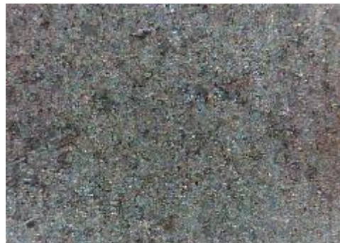
d) uzorak korodiran u otopini NaCl, prijelaz
