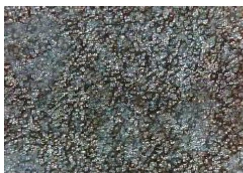
f) uzorak korodiran u otopini HCl, prijelaz
