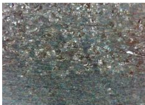
d) uzorak korodiran u otopini NaCl, prijelaz
