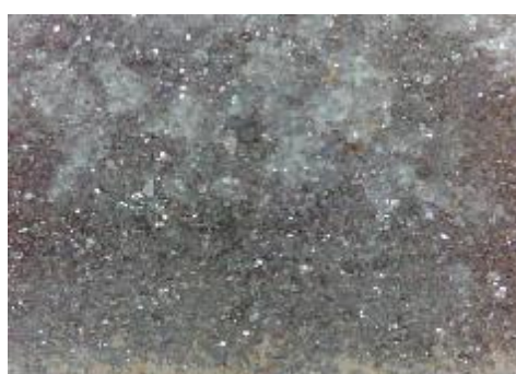
f) uzorak korodiran u otopini HCl, prijelaz
