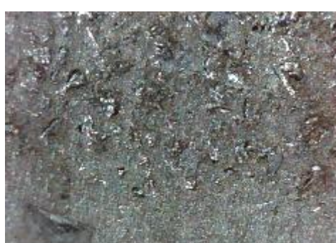
f) uzorak korodiran u otopini HCl, prijelaz
