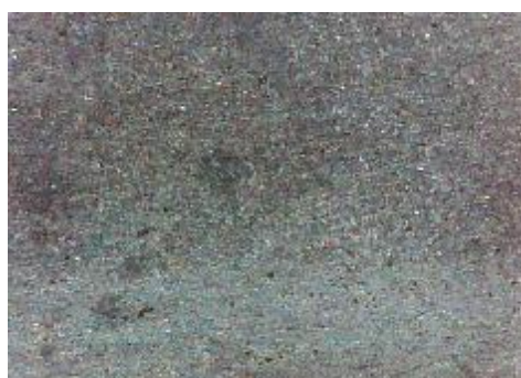
d) uzorak korodiran u otopini NaCl, prijelaz
