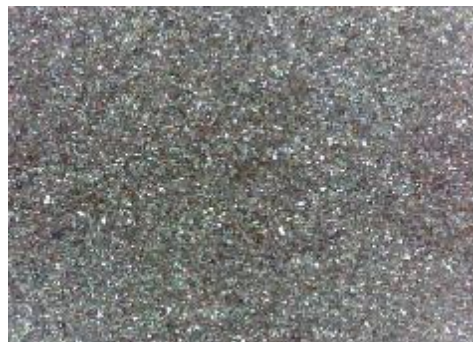
e) uzorak korodiran u otopini HCl, sredina
