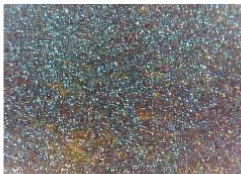
e) uzorak korodiran u otopini HCl, sredina
