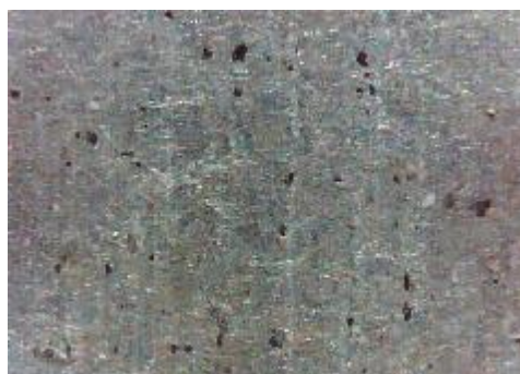
c) uzorak korodiran u otopini NaCl sredina
