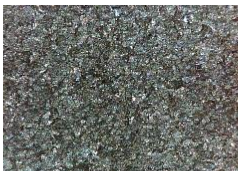
c) uzorak korodiran u otopini NaCl sredina
