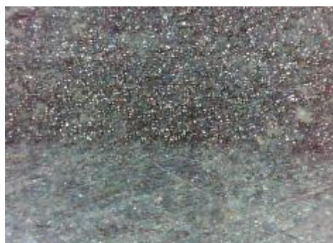
d) uzorak korodiran u otopini NaCl, prijelaz
