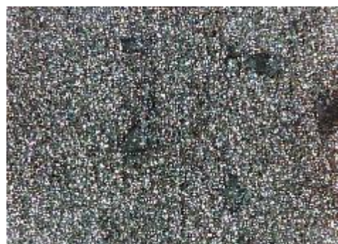
e) uzorak korodiran u otopini HCl, sredina
