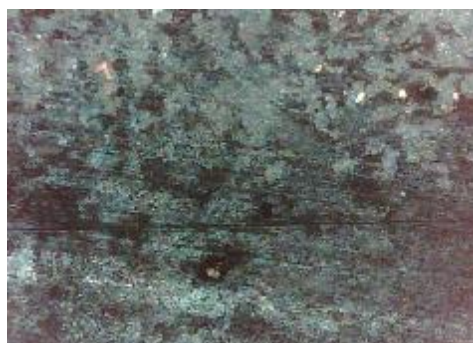
d) uzorak korodiran u otopini NaCl, prijelaz
