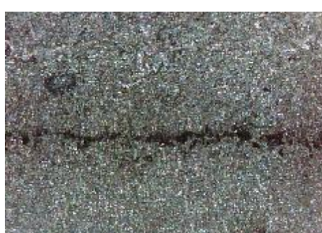
f) uzorak korodiran u otopini HCl, prijelaz
