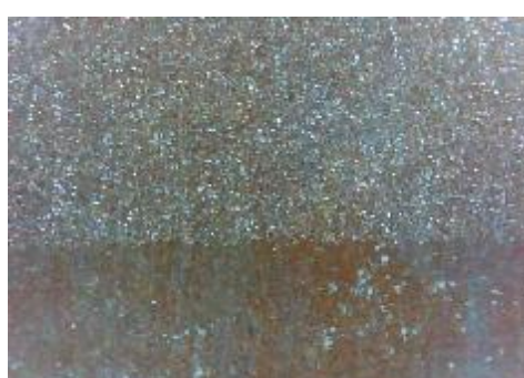
f) uzorak korodiran u otopini HCl, prijelaz
