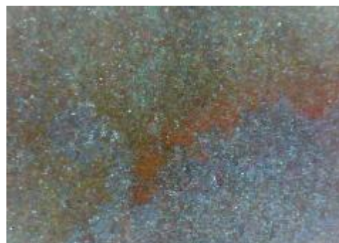
e) uzorak korodiran u otopini HCl, sredina
