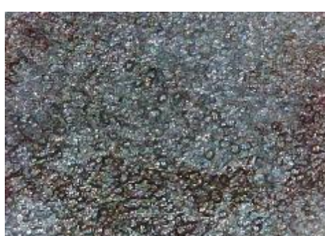
f) uzorak korodiran u otopini HCl, prijelaz
