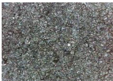
e) uzorak korodiran u otopini HCl, sredina
