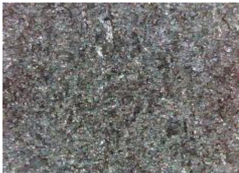
c) uzorak korodiran u otopini NaCl sredina
