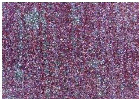
e) uzorak korodiran u otopini HCl, sredina
