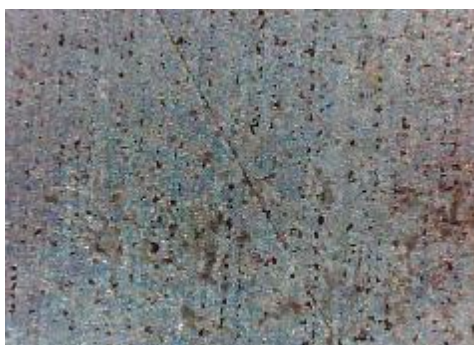
c) uzorak korodiran u otopini NaCl sredina
