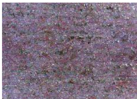
e) uzorak korodiran u otopini HCl, sredina
