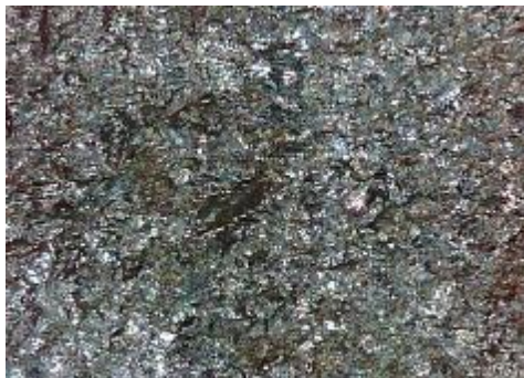
c) uzorak korodiran u otopini NaCl sredina
