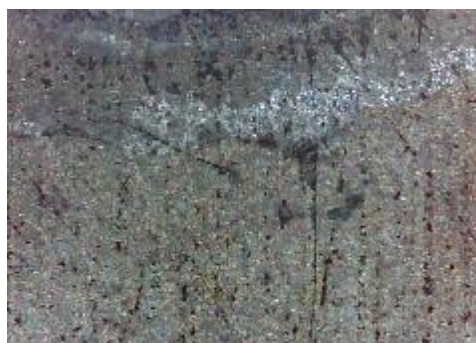
c) uzorak korodiran u otopini NaCl sredina
