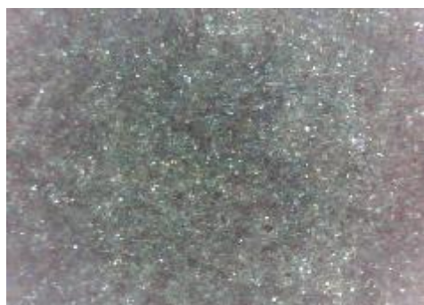
c) uzorak korodiran u otopini NaCl sredina
