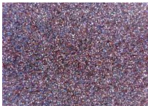
e) uzorak korodiran u otopini HCl, sredina
