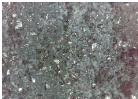
e) uzorak korodiran u otopini HCl, sredina
