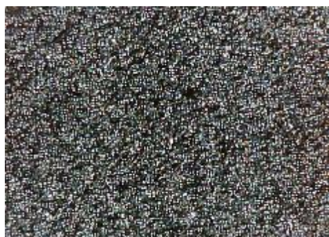
c) uzorak korodiran u otopini NaCl sredina
