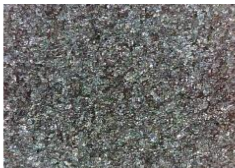
e) uzorak korodiran u otopini HCl, sredina
