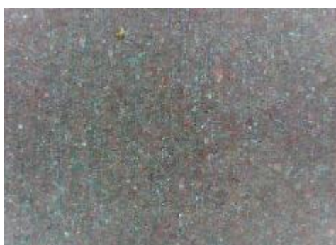
c) uzorak korodiran u otopini NaCl sredina
