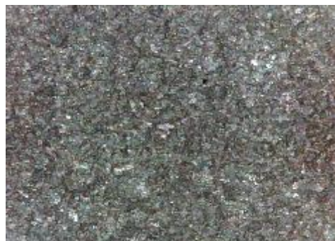
e) uzorak korodiran u otopini HCl, sredina
