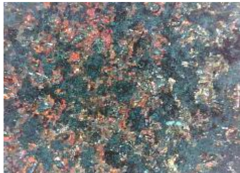
c) uzorak korodiran u otopini NaCl sredina
