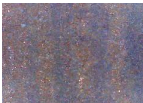
e) uzorak korodiran u otopini HCl, sredina
