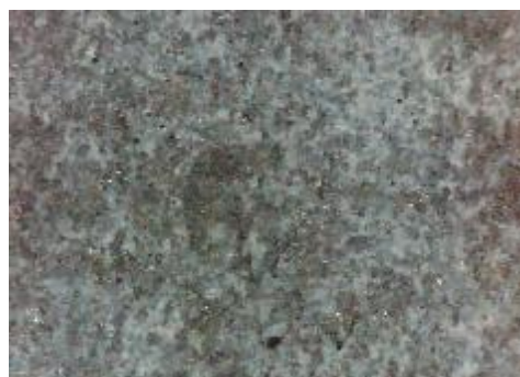
e) uzorak korodiran u otopini HCl, sredina
