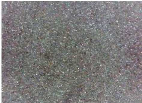
c) uzorak korodiran u otopini NaCl sredina
