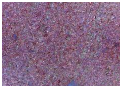
e) uzorak korodiran u otopini HCl, sredina
