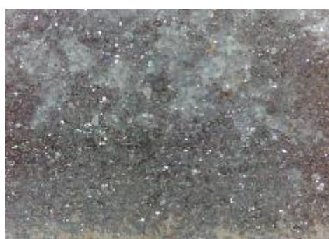
f) uzorak korodiran u otopini HCl, prijelaz
