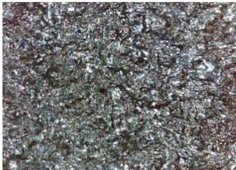
c) uzorak korodiran u otopini NaCl sredina
