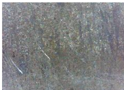
d) uzorak korodiran u otopini NaCl, prijelaz
