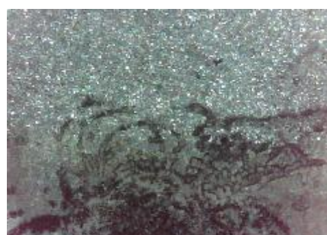
f) uzorak korodiran u otopini HCl, prijelaz
