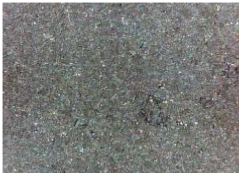
e) uzorak korodiran u otopini HCl, sredina
