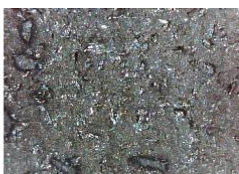
f) uzorak korodiran u otopini HCl, prijelaz
