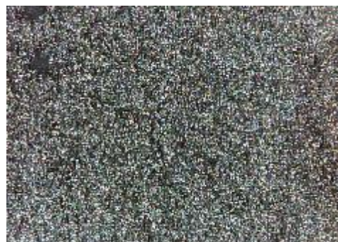
e) uzorak korodiran u otopini HCl, sredina
