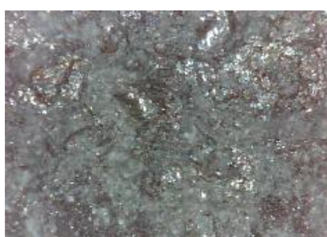
f) uzorak korodiran u otopini HCl, prijelaz
