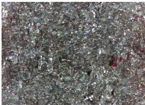
c) uzorak korodiran u otopini NaCl sredina
