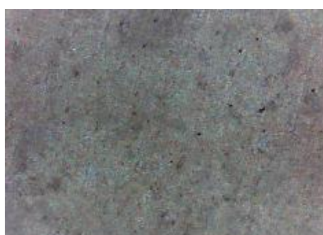
f) uzorak korodiran u otopini HCl, prijelaz
