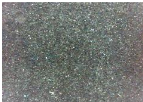
e) uzorak korodiran u otopini HCl, sredina
