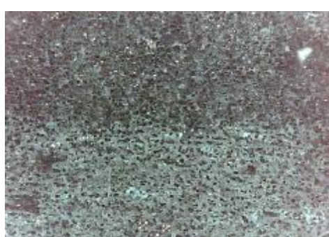
f) uzorak korodiran u otopini HCl, prijelaz
