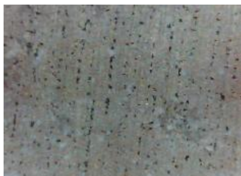
d) uzorak korodiran u otopini NaCl, prijelaz
