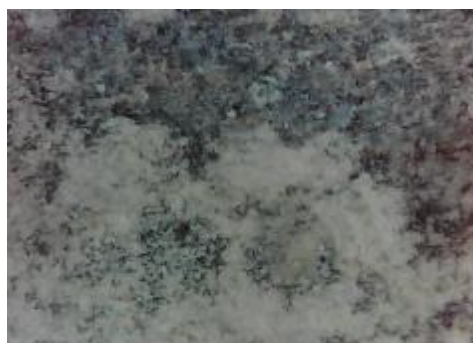
d) uzorak korodiran u otopini NaCl, prijelaz
