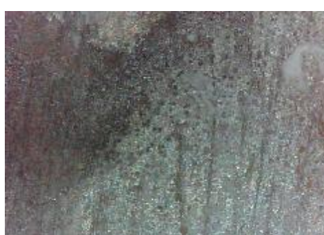
f) uzorak korodiran u otopini HCl, prijelaz
