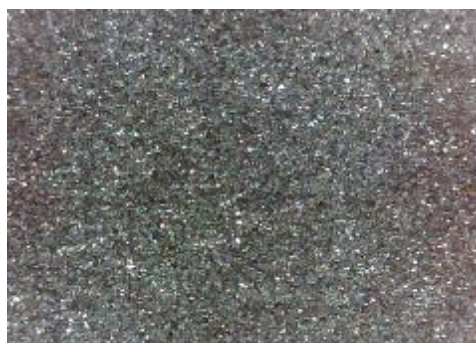
c) uzorak korodiran u otopini NaCl sredina
