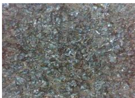
c) uzorak korodiran u otopini NaCl sredina
