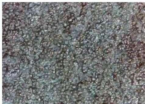
e) uzorak korodiran u otopini HCl, sredina
