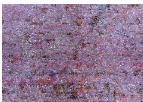
f) uzorak korodiran u otopini HCl, prijelaz
