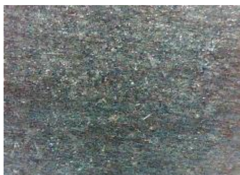
d) uzorak korodiran u otopini NaCl, prijelaz
