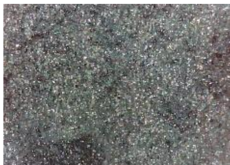
e) uzorak korodiran u otopini HCl, sredina
