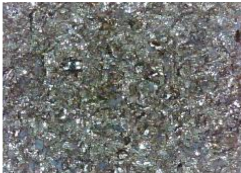
c) uzorak korodiran u otopini NaCl sredina
