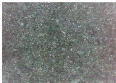
c) uzorak korodiran u otopini NaCl sredina
