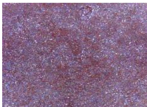
e) uzorak korodiran u otopini HCl, sredina
