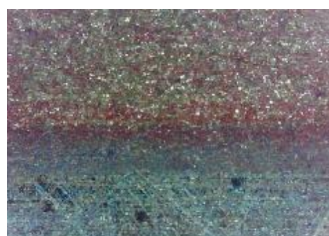
f) uzorak korodiran u otopini HCl, prijelaz
