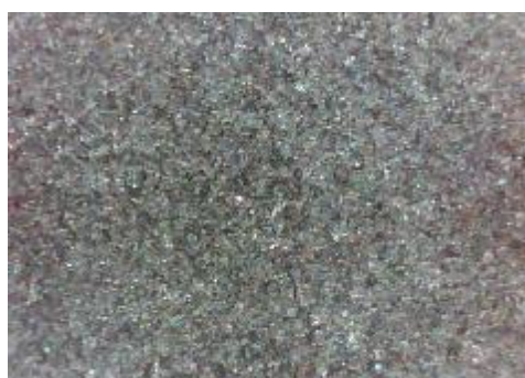
c) uzorak korodiran u otopini NaCl sredina
