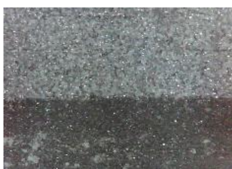
f) uzorak korodiran u otopini HCl, prijelaz
