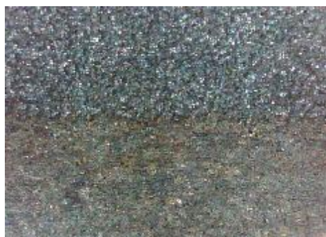
d) uzorak korodiran u otopini NaCl, prijelaz
