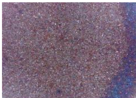
e) uzorak korodiran u otopini HCl, sredina
