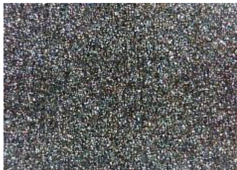
c) uzorak korodiran u otopini NaCl sredina
