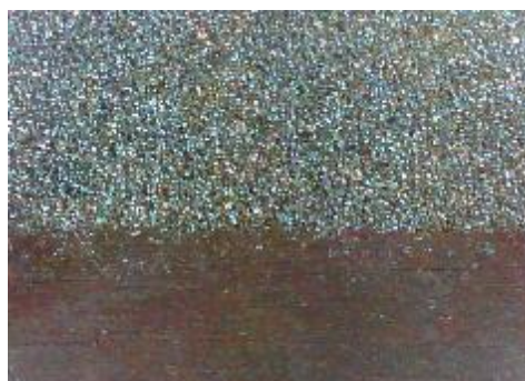
d) uzorak korodiran u otopini NaCl, prijelaz
