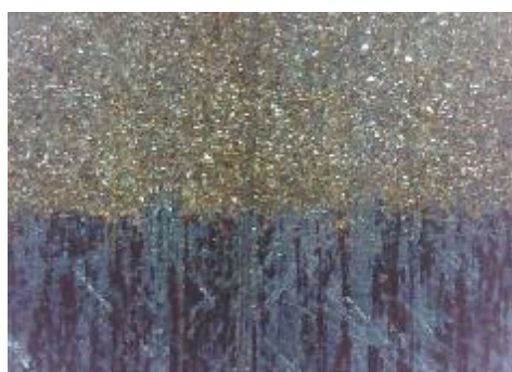
d) uzorak korodiran u otopini NaCl, prijelaz
