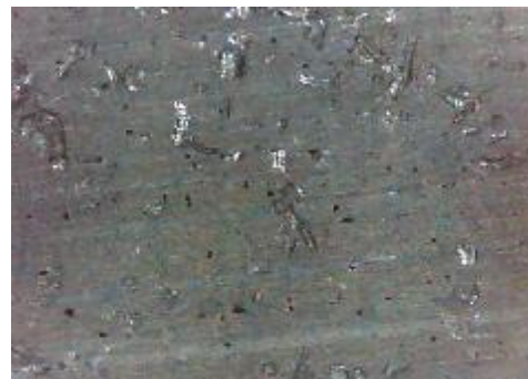
d) uzorak korodiran u otopini NaCl, prijelaz
