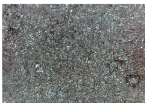
f) uzorak korodiran u otopini HCl, prijelaz
