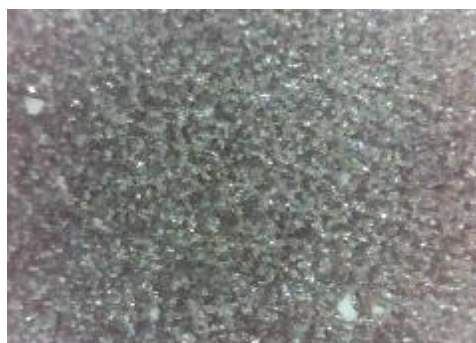
c) uzorak korodiran u otopini NaCl sredina
