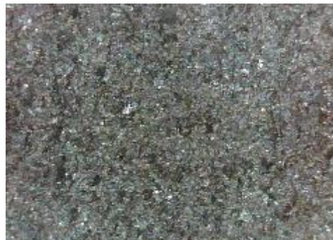
e) uzorak korodiran u otopini HCl, sredina
