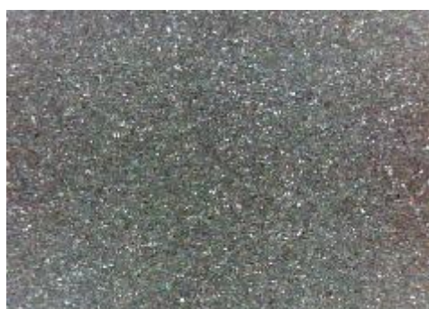
c) uzorak korodiran u otopini NaCl sredina
