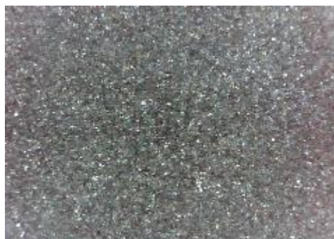
e) uzorak korodiran u otopini HCl, sredina
