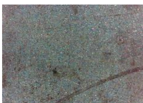
f) uzorak korodiran u otopini HCl, prijelaz
