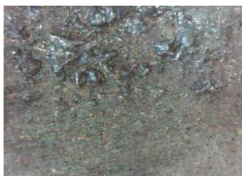
d) uzorak korodiran u otopini NaCl, prijelaz
