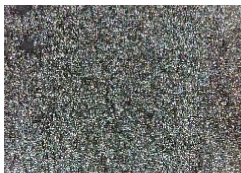
e) uzorak korodiran u otopini HCl, sredina
