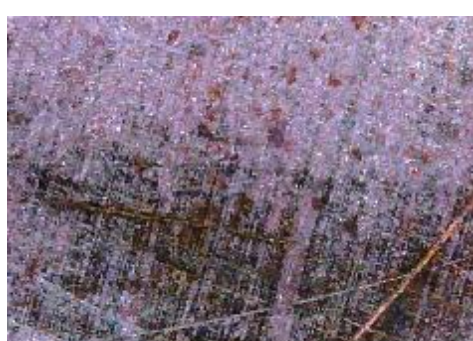
f) uzorak korodiran u otopini HCl, prijelaz
