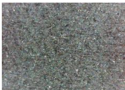
c) uzorak korodiran u otopini NaCl sredina
