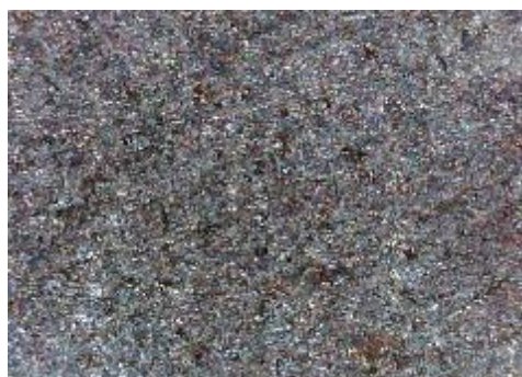
e) uzorak korodiran u otopini HCl, sredina
