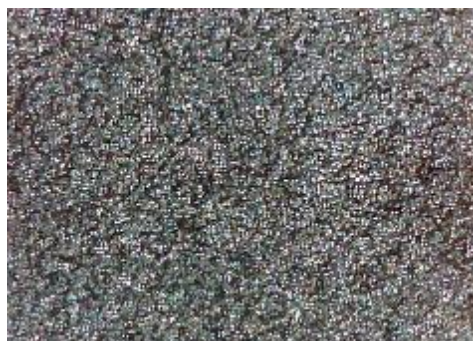
e) uzorak korodiran u otopini HCl, sredina
