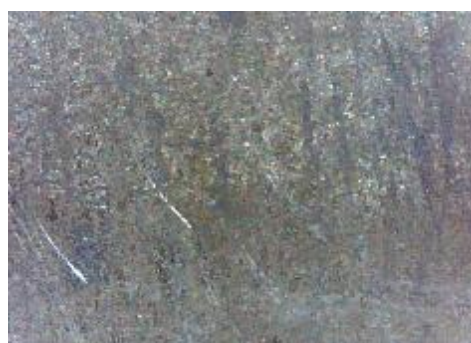
d) uzorak korodiran u otopini NaCl, prijelaz
