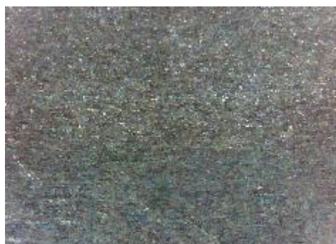
d) uzorak korodiran u otopini NaCl, prijelaz
