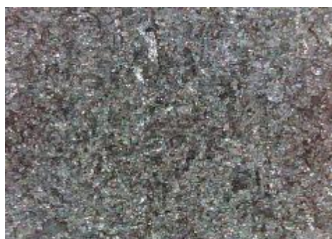
c) uzorak korodiran u otopini NaCl sredina
