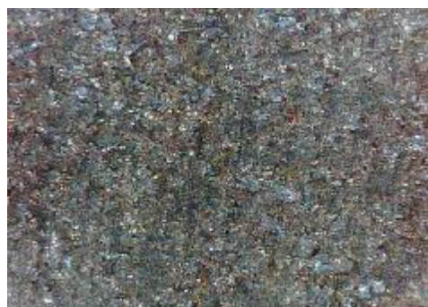
c) uzorak korodiran u otopini NaCl sredina
