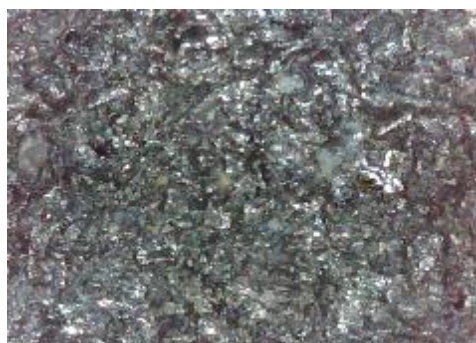
c) uzorak korodiran u otopini NaCl sredina
