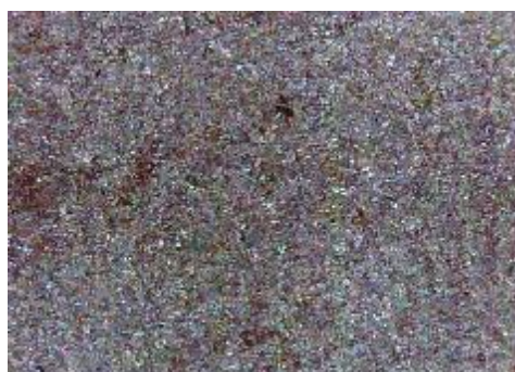
e) uzorak korodiran u otopini HCl, sredina
