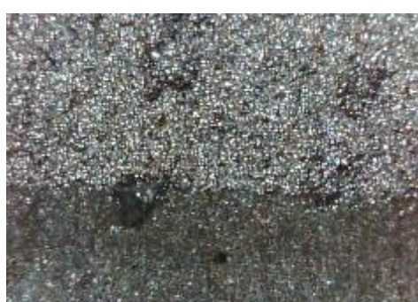
f) uzorak korodiran u otopini HCl, prijelaz
