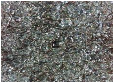
e) uzorak korodiran u otopini HCl, sredina
