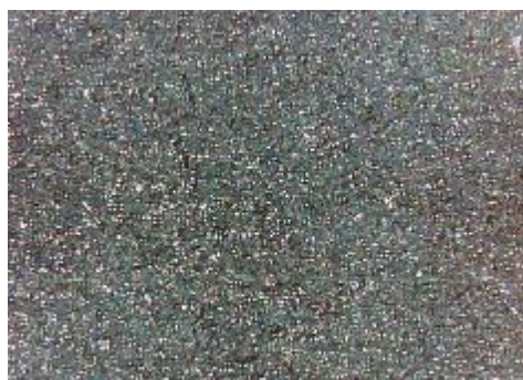
g) uzorak korodiran u otopini Na 2 S 2 O 5 , sredina
