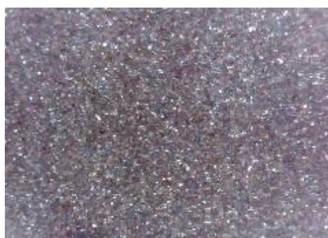
c) uzorak korodiran u otopini NaCl sredina
