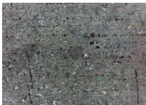
c) uzorak korodiran u otopini NaCl sredina
