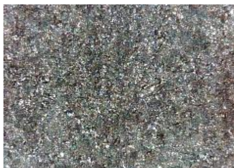
c) uzorak korodiran u otopini NaCl sredina
