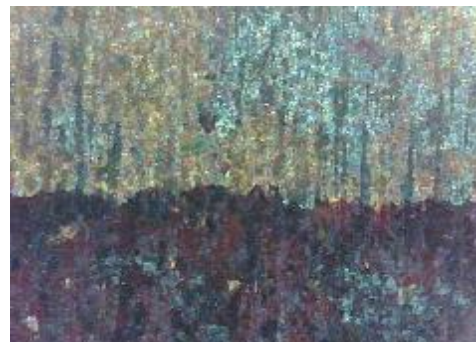
d) uzorak korodiran u otopini NaCl, prijelaz
