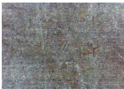
c) uzorak korodiran u otopini NaCl sredina
