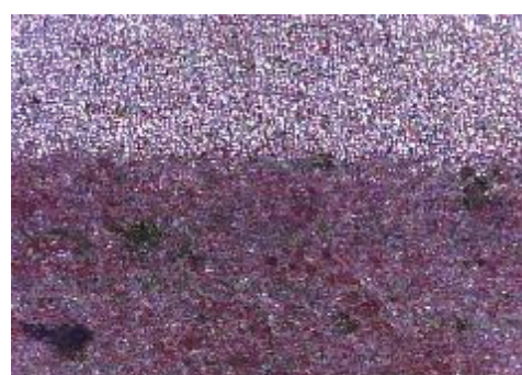
f) uzorak korodiran u otopini HCl, prijelaz
