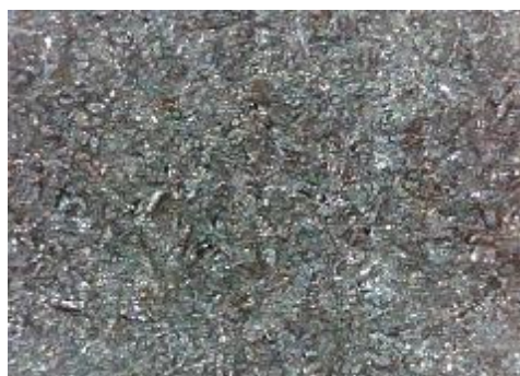
e) uzorak korodiran u otopini HCl, sredina
