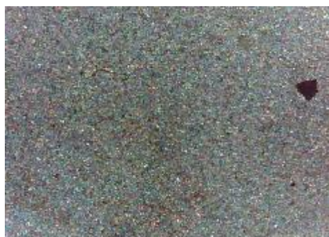
c) uzorak korodiran u otopini NaCl sredina
