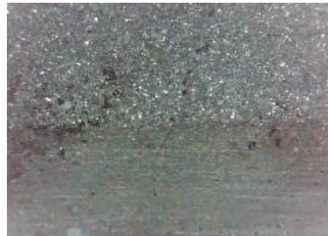
d) uzorak korodiran u otopini NaCl, prijelaz
