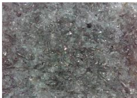
e) uzorak korodiran u otopini HCl, sredina
