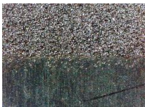
d) uzorak korodiran u otopini NaCl, prijelaz
