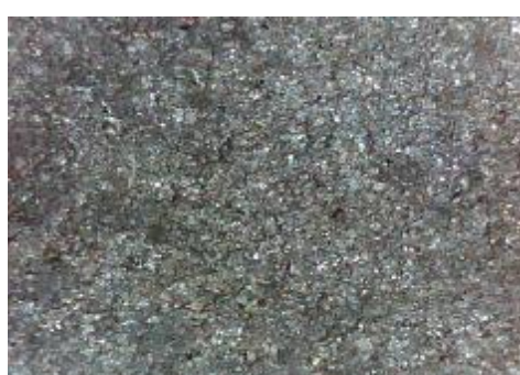
f) uzorak korodiran u otopini HCl, prijelaz
