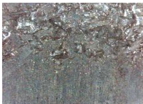
d) uzorak korodiran u otopini NaCl, prijelaz
