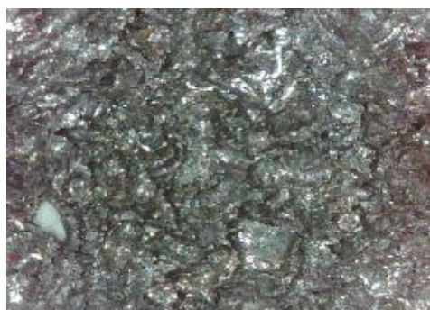
e) uzorak korodiran u otopini HCl, sredina
