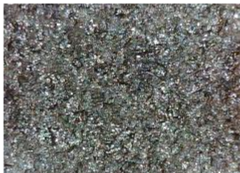
e) uzorak korodiran u otopini HCl, sredina
