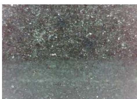
f) uzorak korodiran u otopini HCl, prijelaz
