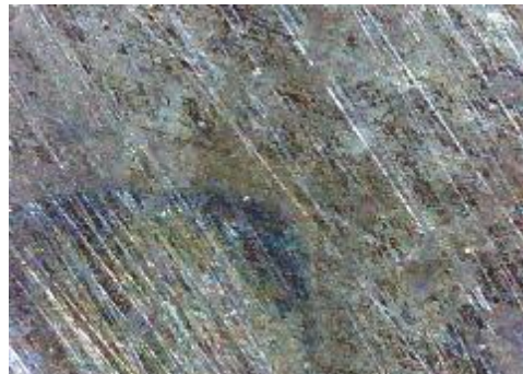
d) uzorak korodiran u otopini NaCl, prijelaz
