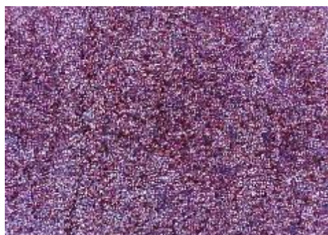
e) uzorak korodiran u otopini HCl, sredina
