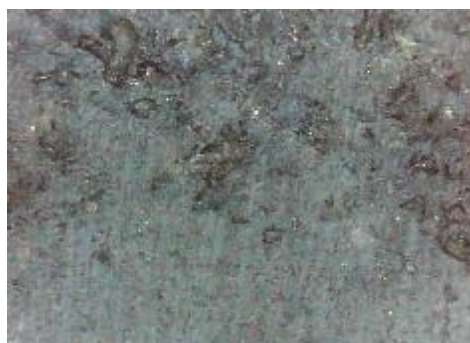
d) uzorak korodiran u otopini NaCl, prijelaz
