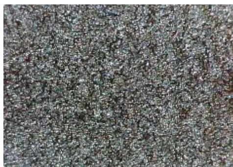
e) uzorak korodiran u otopini HCl, sredina
