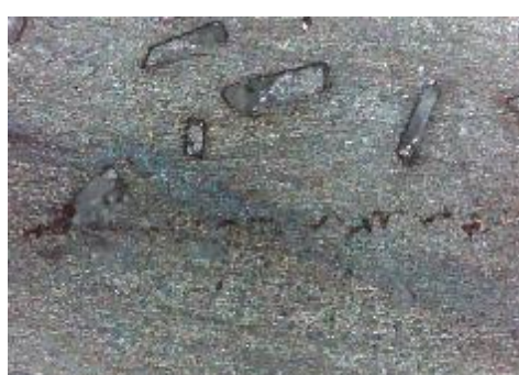
f) uzorak korodiran u otopini HCl, prijelaz
