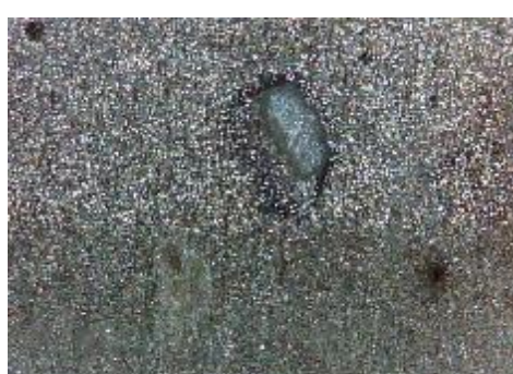
f) uzorak korodiran u otopini HCl, prijelaz
