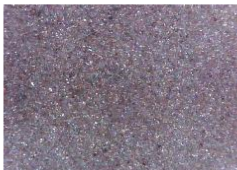
c) uzorak korodiran u otopini NaCl sredina
