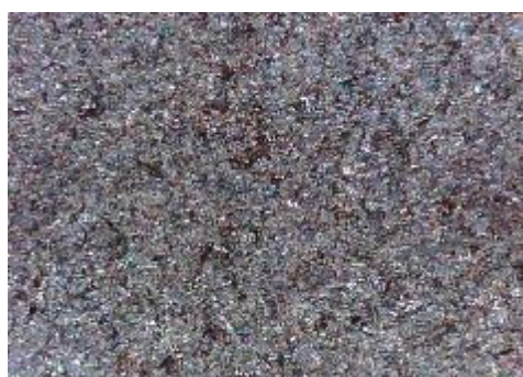
c) uzorak korodiran u otopini NaCl sredina
