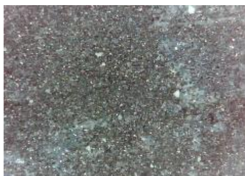
c) uzorak korodiran u otopini NaCl sredina
