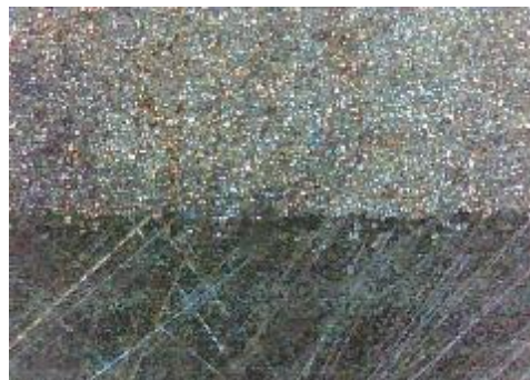
d) uzorak korodiran u otopini NaCl, prijelaz
