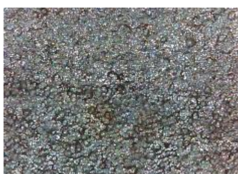
f) uzorak korodiran u otopini HCl, prijelaz
