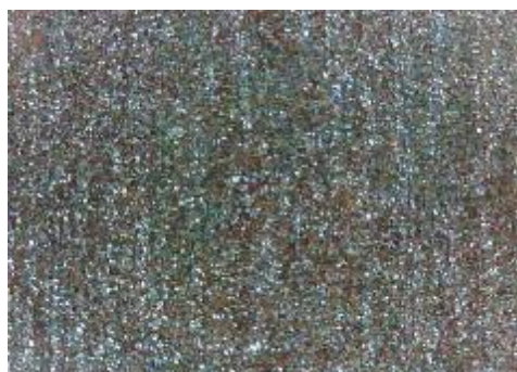
e) uzorak korodiran u otopini HCl, sredina
