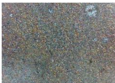
c) uzorak korodiran u otopini NaCl sredina
