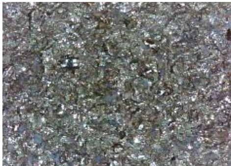
c) uzorak korodiran u otopini NaCl sredina
