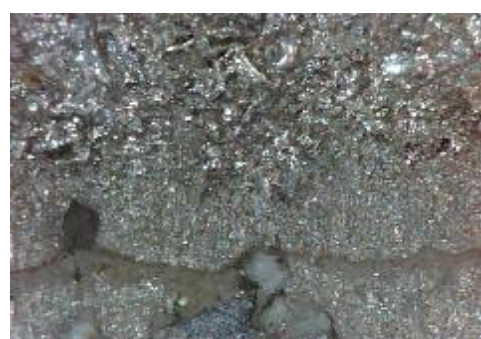
f) uzorak korodiran u otopini HCl, prijelaz
