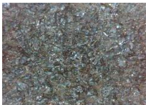
c) uzorak korodiran u otopini NaCl sredina
