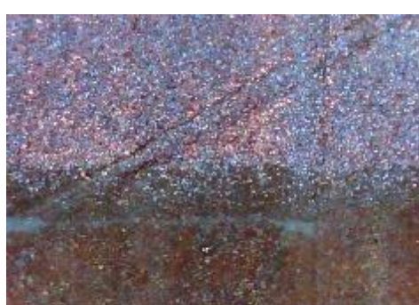
f) uzorak korodiran u otopini HCl, prijelaz
