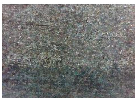
f) uzorak korodiran u otopini HCl, prijelaz
