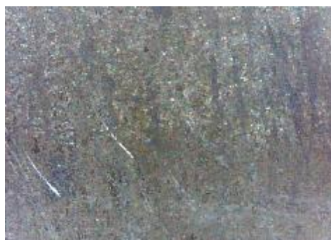
d) uzorak korodiran u otopini NaCl, prijelaz
