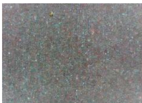
c) uzorak korodiran u otopini NaCl sredina
