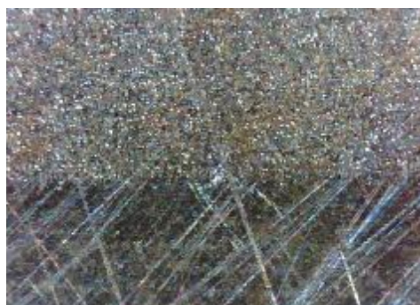
d) uzorak korodiran u otopini NaCl, prijelaz
