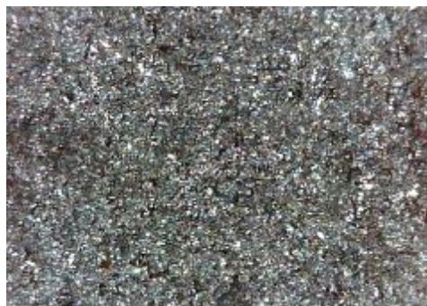
e) uzorak korodiran u otopini HCl, sredina
