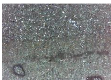
f) uzorak korodiran u otopini HCl, prijelaz
