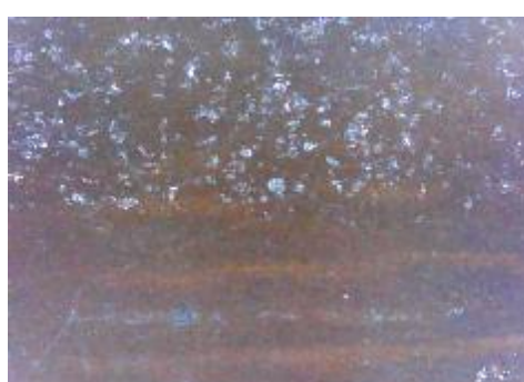
f) uzorak korodiran u otopini HCl, prijelaz
