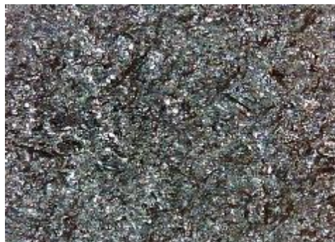
e) uzorak korodiran u otopini HCl, sredina
