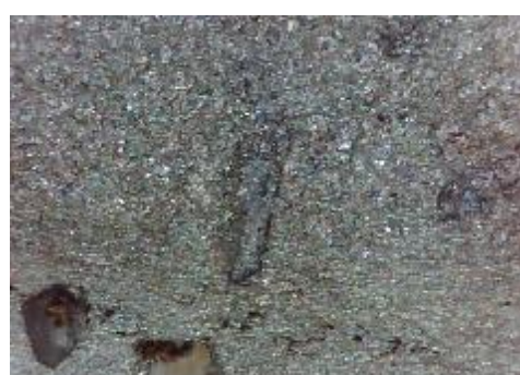
f) uzorak korodiran u otopini HCl, prijelaz
