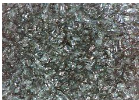
e) uzorak korodiran u otopini HCl, sredina
