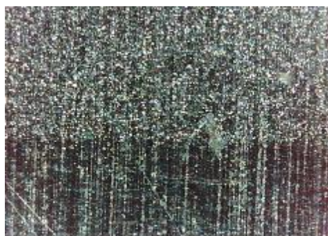
b) nekorodirani uzorak, prijelaz
