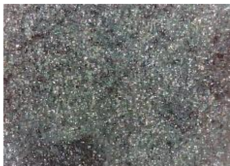
e) uzorak korodiran u otopini HCl, sredina
