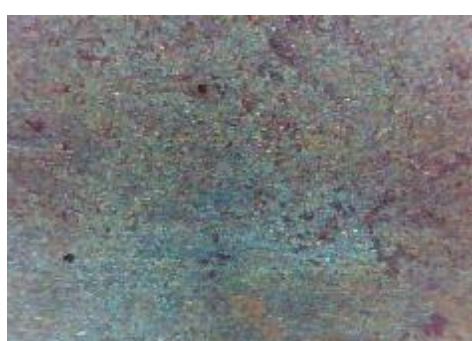
f) uzorak korodiran u otopini HCl, prijelaz
