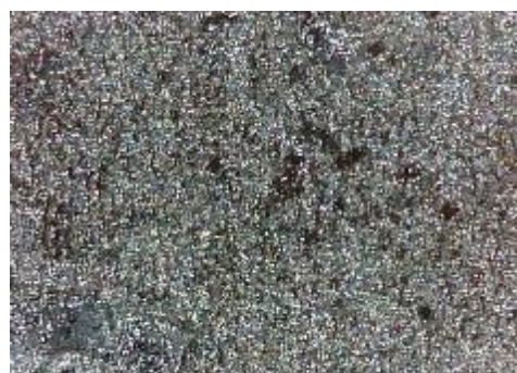
e) uzorak korodiran u otopini HCl, sredina
