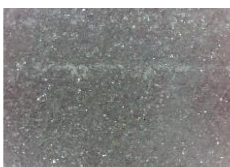
f) uzorak korodiran u otopini HCl, prijelaz
