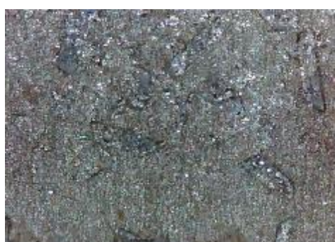
f) uzorak korodiran u otopini HCl, prijelaz
