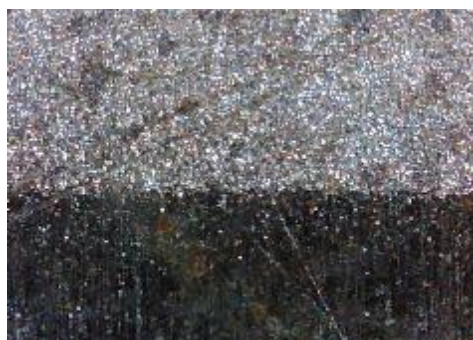
b) nekorodirani uzorak, prijelaz
