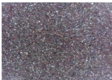
e) uzorak korodiran u otopini HCl, sredina
