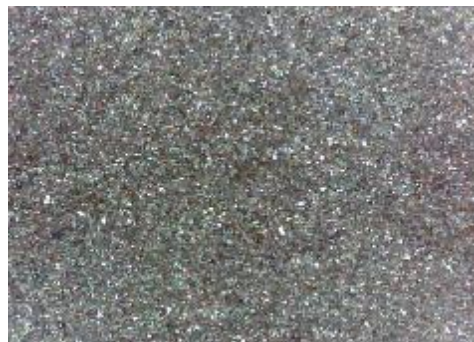
e) uzorak korodiran u otopini HCl, sredina
