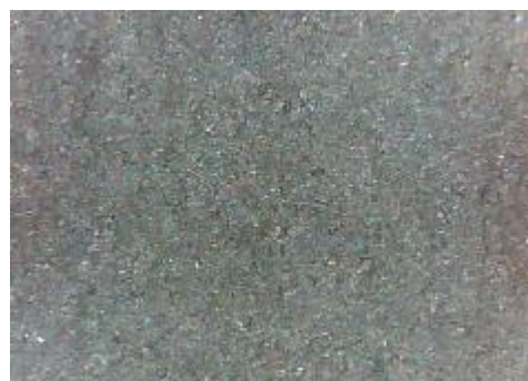
e) uzorak korodiran u otopini HCl, sredina
