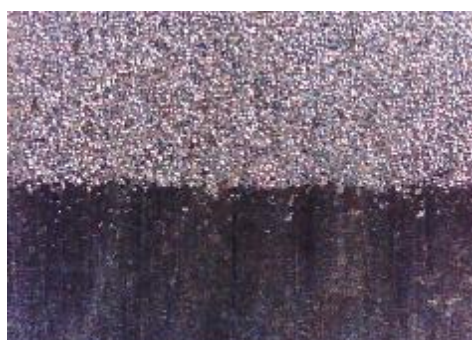
b) nekorodirani uzorak, prijelaz
