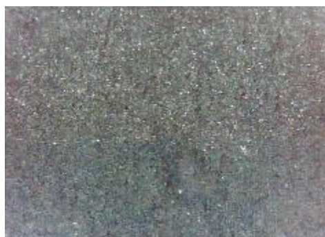
d) uzorak korodiran u otopini NaCl, prijelaz
