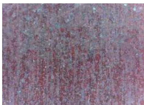
d) uzorak korodiran u otopini NaCl, prijelaz
