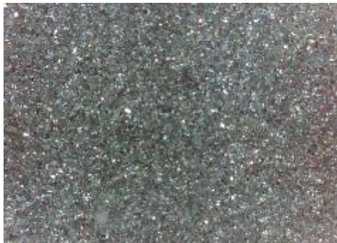
c) uzorak korodiran u otopini NaCl sredina
