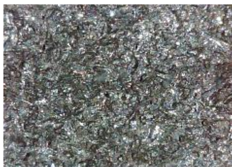
c) uzorak korodiran u otopini NaCl sredina
