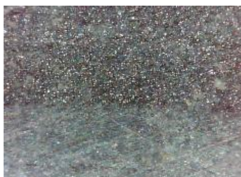
d) uzorak korodiran u otopini NaCl, prijelaz
