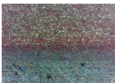
f) uzorak korodiran u otopini HCl, prijelaz
