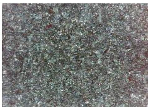
c) uzorak korodiran u otopini NaCl sredina
