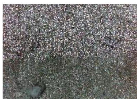
f) uzorak korodiran u otopini HCl, prijelaz
