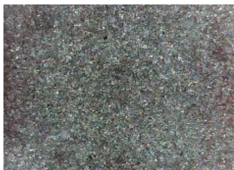
c) uzorak korodiran u otopini NaCl sredina
