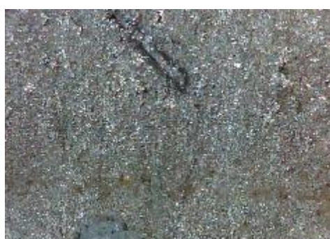
f) uzorak korodiran u otopini HCl, prijelaz
