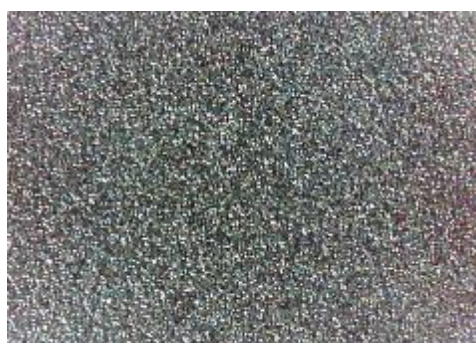
c) uzorak korodiran u otopini NaCl sredina
