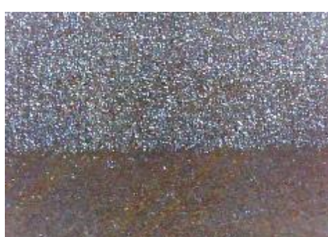
f) uzorak korodiran u otopini HCl, prijelaz
