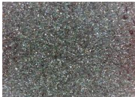
e) uzorak korodiran u otopini HCl, sredina
