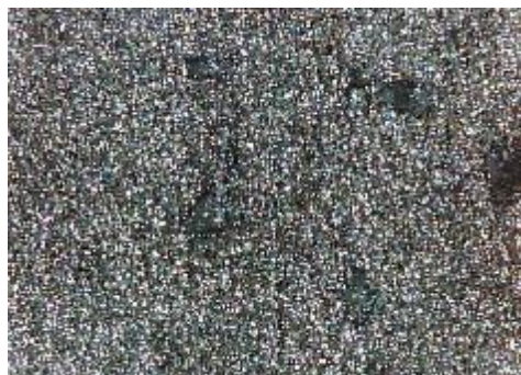
e) uzorak korodiran u otopini HCl, sredina
