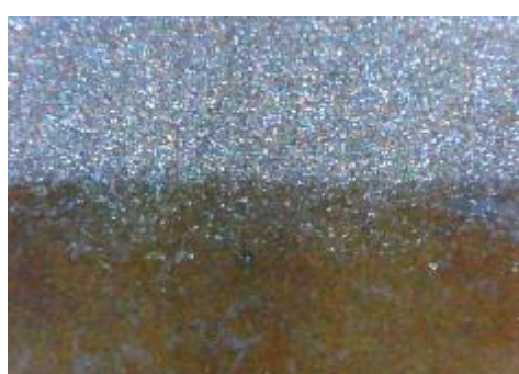
f) uzorak korodiran u otopini HCl, prijelaz
