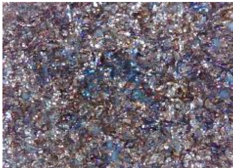
c) uzorak korodiran u otopini NaCl sredina
