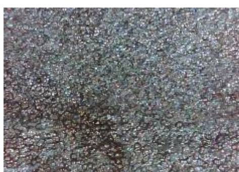
f) uzorak korodiran u otopini HCl, prijelaz
