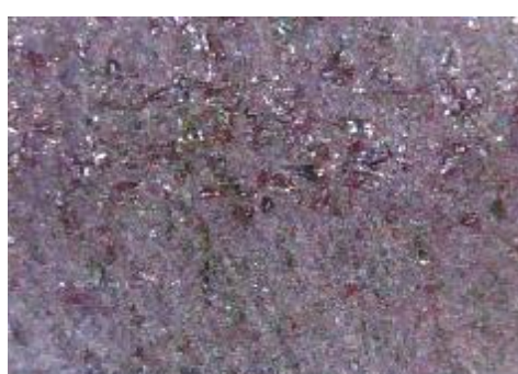
f) uzorak korodiran u otopini HCl, prijelaz
