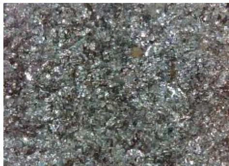
e) uzorak korodiran u otopini HCl, sredina
