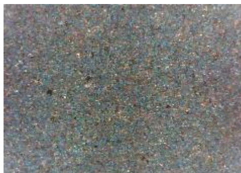
e) uzorak korodiran u otopini HCl, sredina
