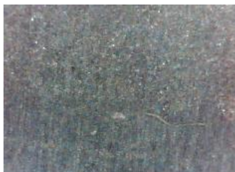
d) uzorak korodiran u otopini NaCl, prijelaz
