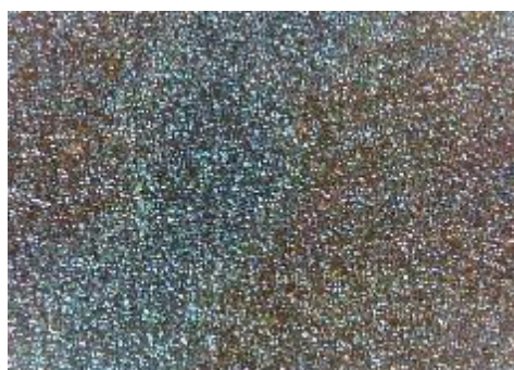
e) uzorak korodiran u otopini HCl, sredina
