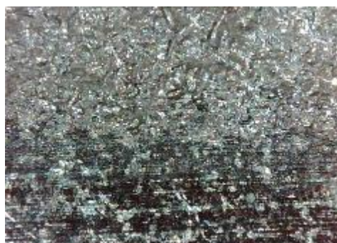
b) nekorodirani uzorak, prijelaz
