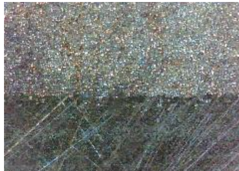
d) uzorak korodiran u otopini NaCl, prijelaz
