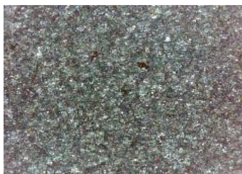
e) uzorak korodiran u otopini HCl, sredina
