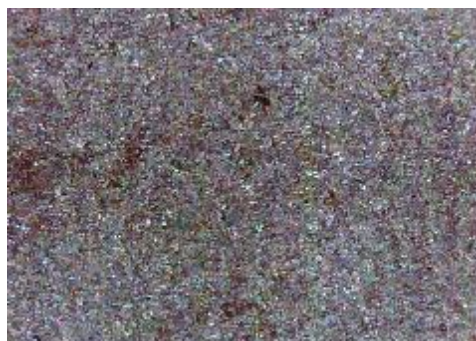
e) uzorak korodiran u otopini HCl, sredina
