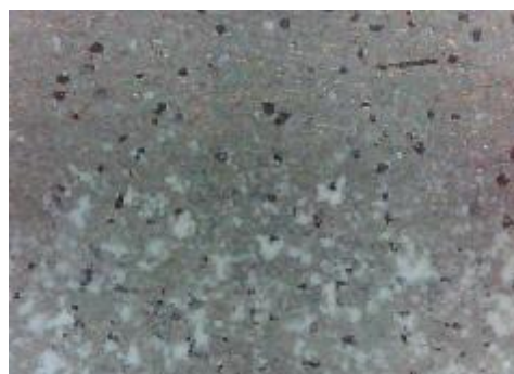
d) uzorak korodiran u otopini NaCl, prijelaz
