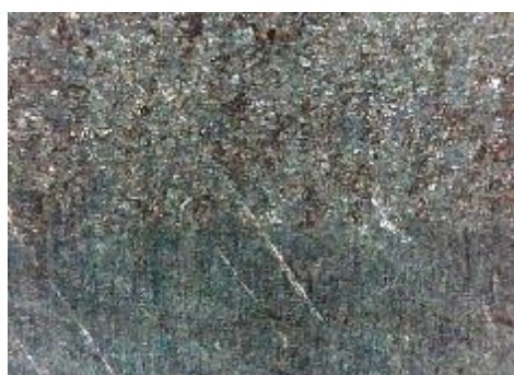
d) uzorak korodiran u otopini NaCl, prijelaz
