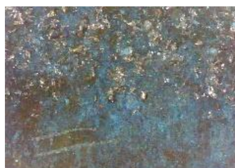
f) uzorak korodiran u otopini HCl, prijelaz
