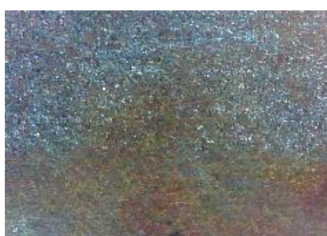
f) uzorak korodiran u otopini HCl, prijelaz
