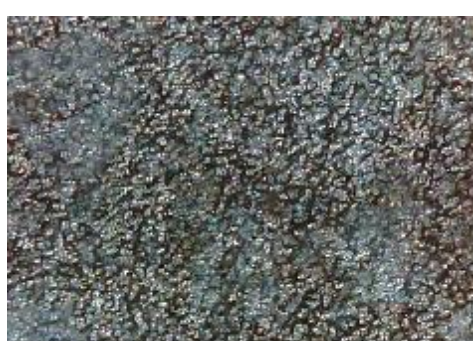
f) uzorak korodiran u otopini HCl, prijelaz
