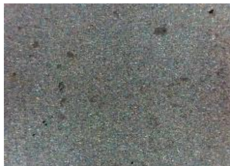
e) uzorak korodiran u otopini HCl, sredina
