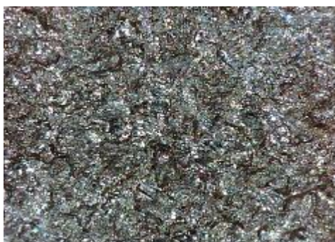
c) uzorak korodiran u otopini NaCl sredina
