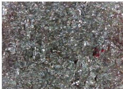
c) uzorak korodiran u otopini NaCl sredina
