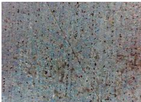
c) uzorak korodiran u otopini NaCl sredina
