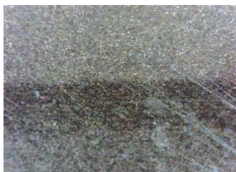
d) uzorak korodiran u otopini NaCl, prijelaz
