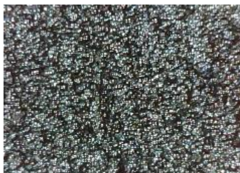
c) uzorak korodiran u otopini NaCl sredina
