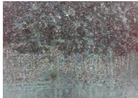
d) uzorak korodiran u otopini NaCl, prijelaz
