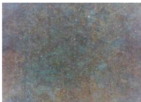
e) uzorak korodiran u otopini HCl, sredina
