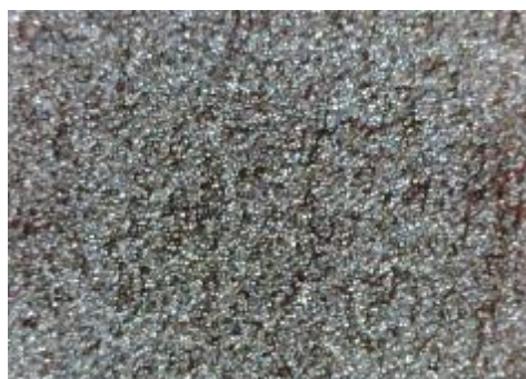
e) uzorak korodiran u otopini HCl, sredina
