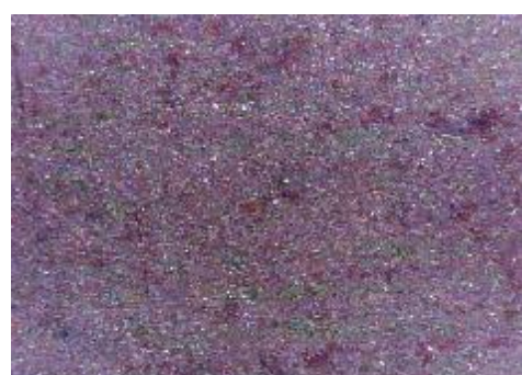
f) uzorak korodiran u otopini HCl, prijelaz
