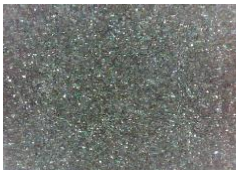
c) uzorak korodiran u otopini NaCl sredina
