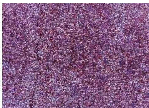
e) uzorak korodiran u otopini HCl, sredina
