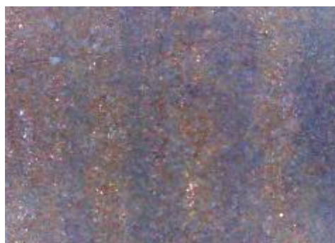
e) uzorak korodiran u otopini HCl, sredina
