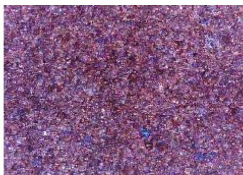
e) uzorak korodiran u otopini HCl, sredina
