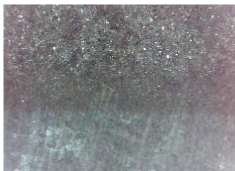
d) uzorak korodiran u otopini NaCl, prijelaz
