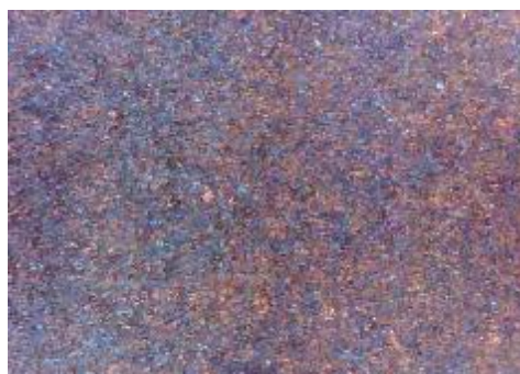
e) uzorak korodiran u otopini HCl, sredina
