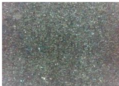
e) uzorak korodiran u otopini HCl, sredina
