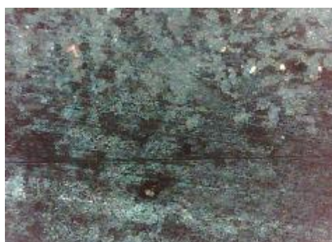
d) uzorak korodiran u otopini NaCl, prijelaz
