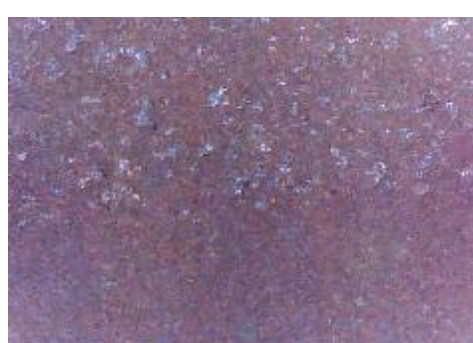
f) uzorak korodiran u otopini HCl, prijelaz
