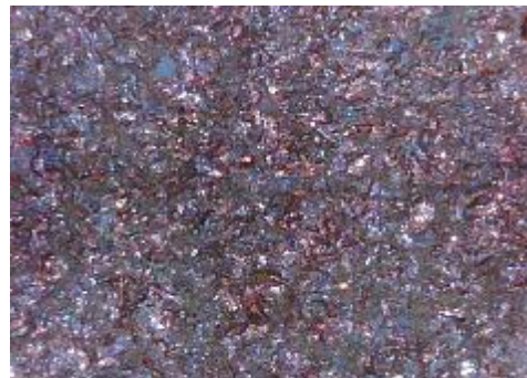
e) uzorak korodiran u otopini HCl, sredina
