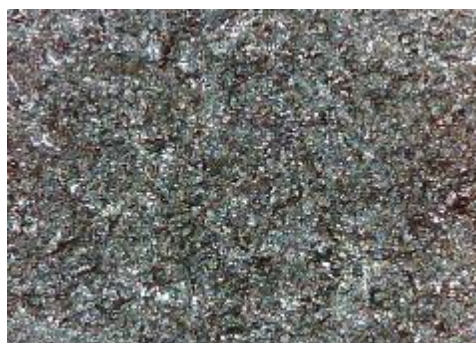
c) uzorak korodiran u otopini NaCl sredina
