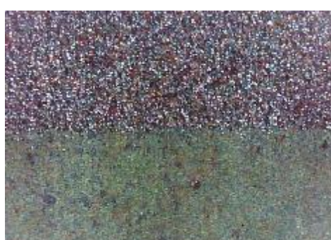
f) uzorak korodiran u otopini HCl, prijelaz
