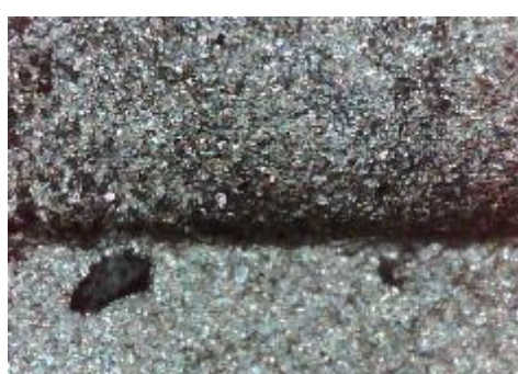
f) uzorak korodiran u otopini HCl, prijelaz
