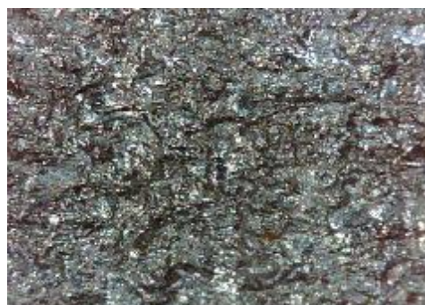
e) uzorak korodiran u otopini HCl, sredina
