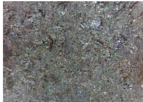
d) uzorak korodiran u otopini NaCl, prijelaz
