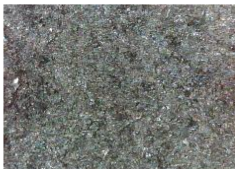
e) uzorak korodiran u otopini HCl, sredina
