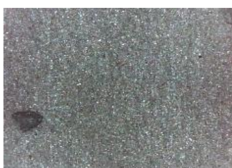
f) uzorak korodiran u otopini HCl, prijelaz
