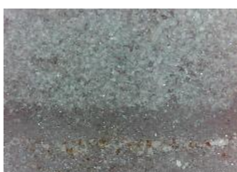
f) uzorak korodiran u otopini HCl, prijelaz
