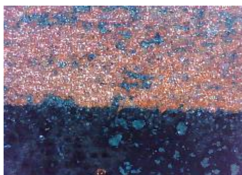
d) uzorak korodiran u otopini NaCl, prijelaz
