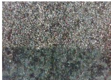
d) uzorak korodiran u otopini NaCl, prijelaz
