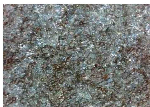
f) uzorak korodiran u otopini HCl, prijelaz
