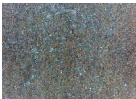
d) uzorak korodiran u otopini NaCl, prijelaz
