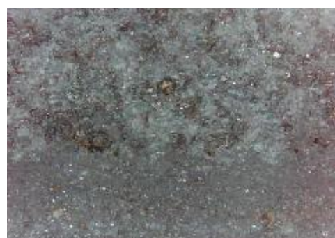
f) uzorak korodiran u otopini HCl, prijelaz
