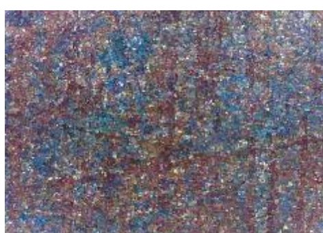
f) uzorak korodiran u otopini HCl, prijelaz
