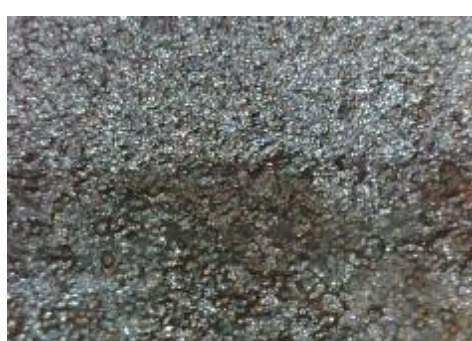
f) uzorak korodiran u otopini HCl, prijelaz
