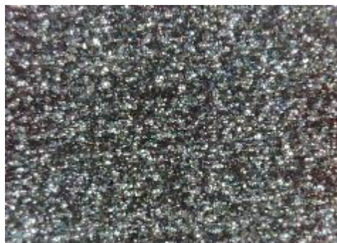
g) uzorak korodiran u otopini \text{Na}_2\text{S}_2\text{O}_5 , sredina
