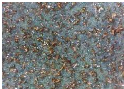
e) uzorak korodiran u otopini HCl, sredina
