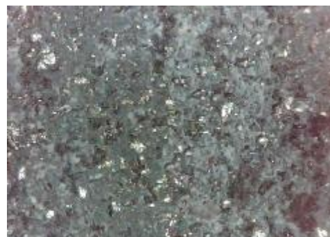
e) uzorak korodiran u otopini HCl, sredina
