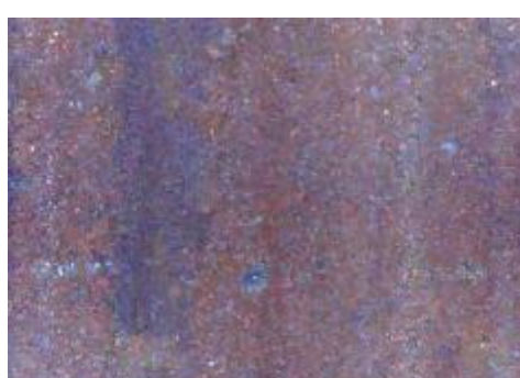
f) uzorak korodiran u otopini HCl, prijelaz
