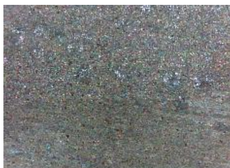
d) uzorak korodiran u otopini NaCl, prijelaz
