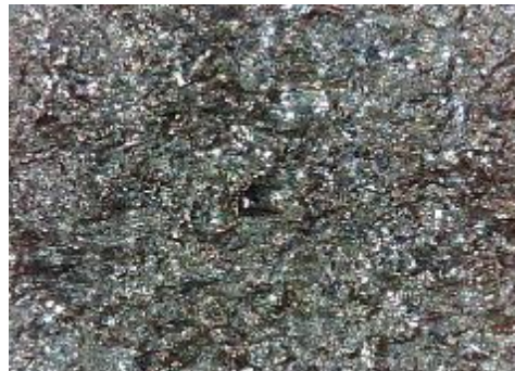
e) uzorak korodiran u otopini HCl, sredina
