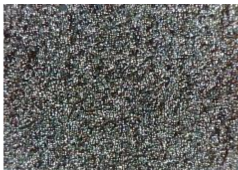
e) uzorak korodiran u otopini HCl, sredina
