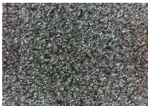
c) uzorak korodiran u otopini NaCl sredina
