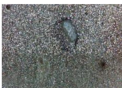
f) uzorak korodiran u otopini HCl, prijelaz
