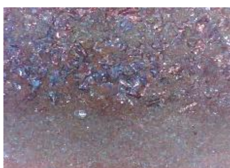
f) uzorak korodiran u otopini HCl, prijelaz
