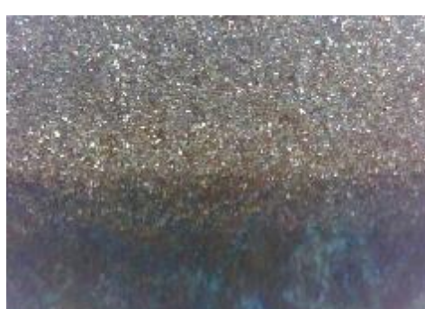
f) uzorak korodiran u otopini HCl, prijelaz
