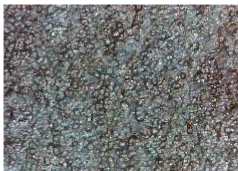
e) uzorak korodiran u otopini HCl, sredina
