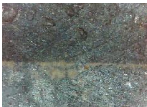
d) uzorak korodiran u otopini NaCl, prijelaz
