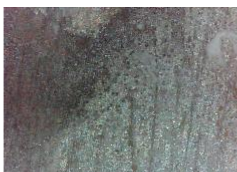
f) uzorak korodiran u otopini HCl, prijelaz
