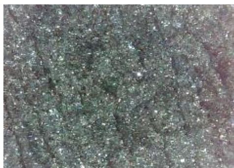
c) uzorak korodiran u otopini NaCl sredina
