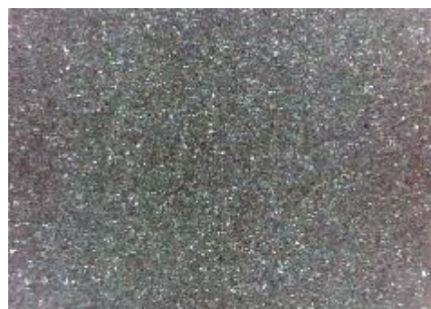
e) uzorak korodiran u otopini HCl, sredina
