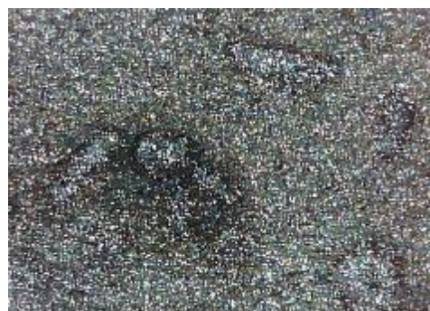
e) uzorak korodiran u otopini HCl, sredina
