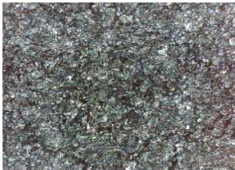
e) uzorak korodiran u otopini HCl, sredina
