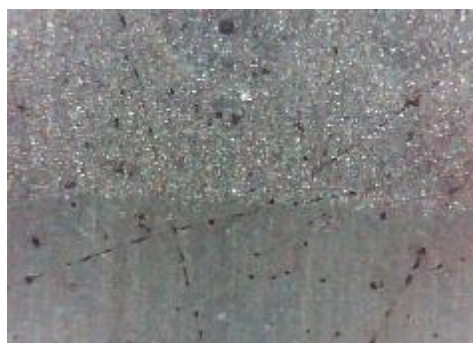
d) uzorak korodiran u otopini NaCl, prijelaz
