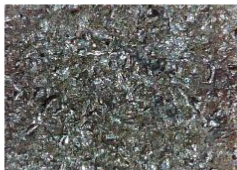
e) uzorak korodiran u otopini HCl, sredina
