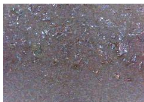
f) uzorak korodiran u otopini HCl, prijelaz
