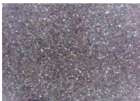
c) uzorak korodiran u otopini NaCl sredina
