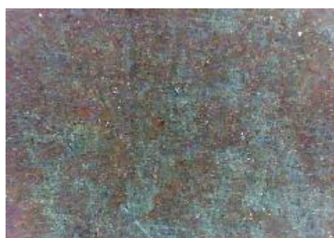
f) uzorak korodiran u otopini HCl, prijelaz
