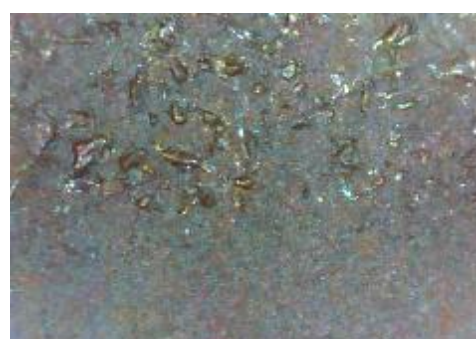
f) uzorak korodiran u otopini HCl, prijelaz
