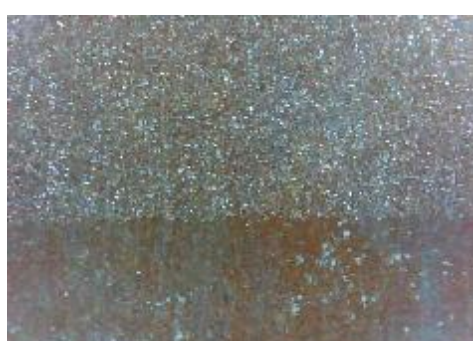
f) uzorak korodiran u otopini HCl, prijelaz
