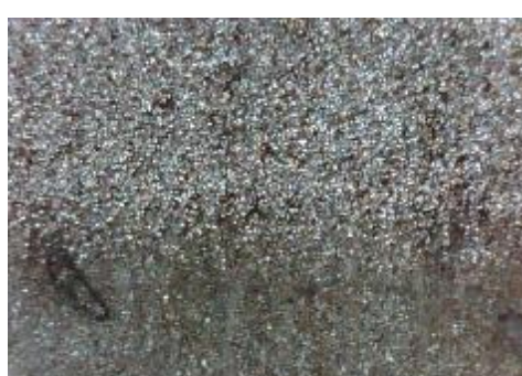
f) uzorak korodiran u otopini HCl, prijelaz
