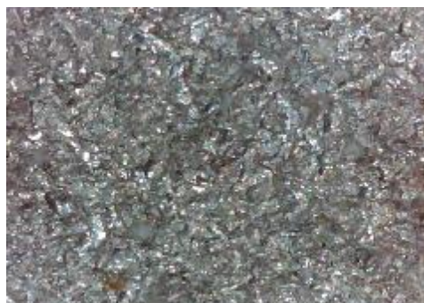
e) uzorak korodiran u otopini HCl, sredina
