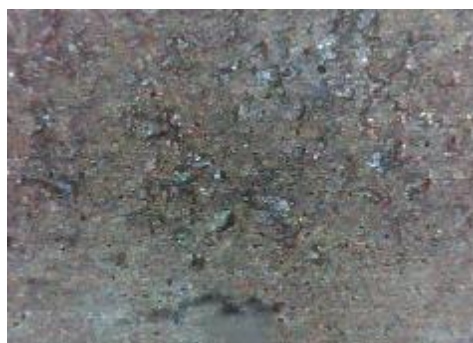
d) uzorak korodiran u otopini NaCl, prijelaz
