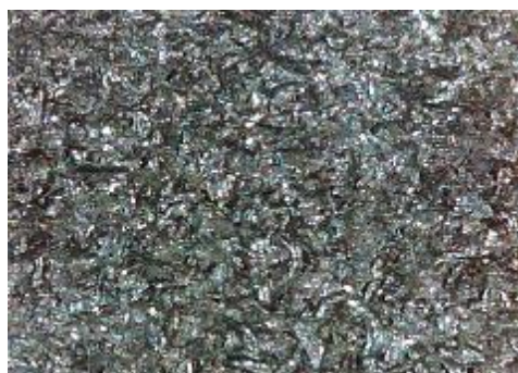
c) uzorak korodiran u otopini NaCl sredina
