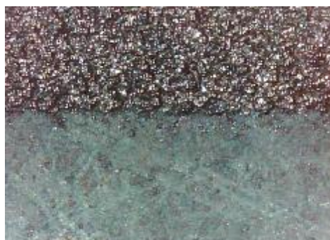
d) uzorak korodiran u otopini NaCl, prijelaz
