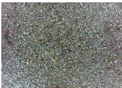
c) uzorak korodiran u otopini NaCl sredina
