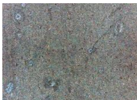
d) uzorak korodiran u otopini NaCl, prijelaz
