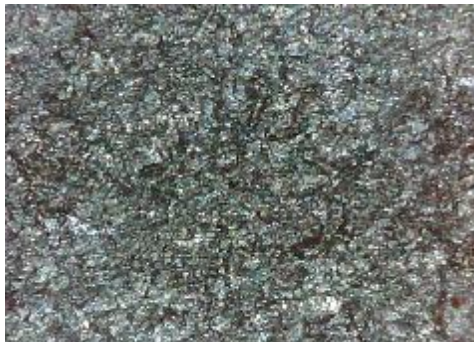
c) uzorak korodiran u otopini NaCl sredina
