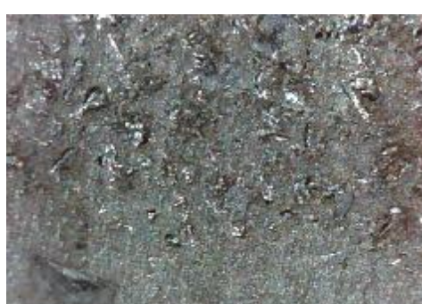
f) uzorak korodiran u otopini HCl, prijelaz
