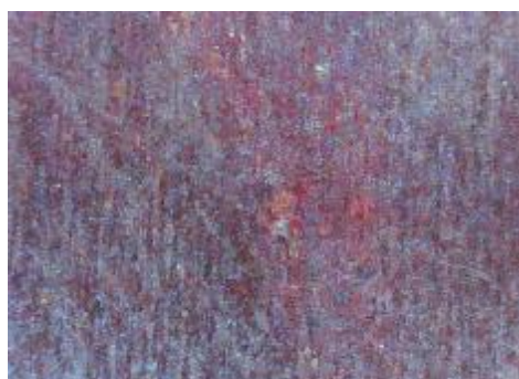
d) uzorak korodiran u otopini NaCl, prijelaz
