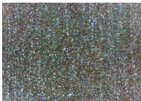
e) uzorak korodiran u otopini HCl, sredina
