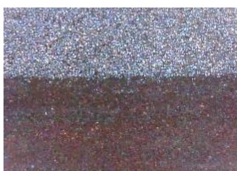
f) uzorak korodiran u otopini HCl, prijelaz
