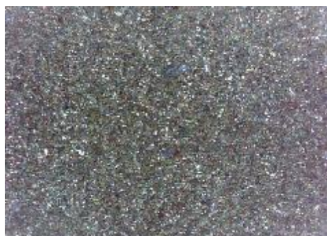
c) uzorak korodiran u otopini NaCl sredina
