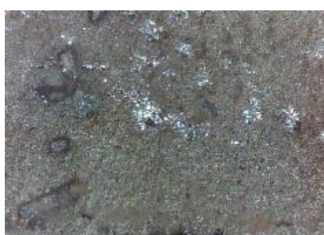
f) uzorak korodiran u otopini HCl, prijelaz
