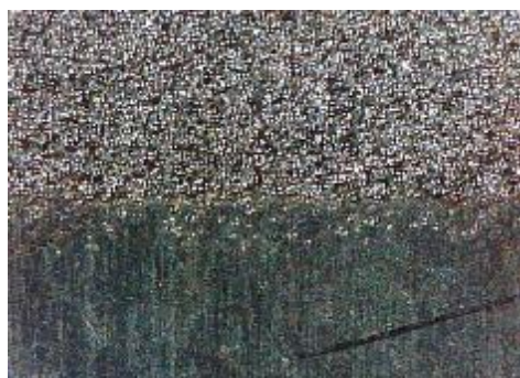
d) uzorak korodiran u otopini NaCl, prijelaz
