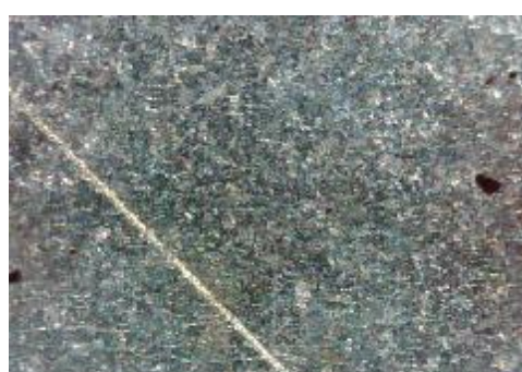
f) uzorak korodiran u otopini HCl, prijelaz
