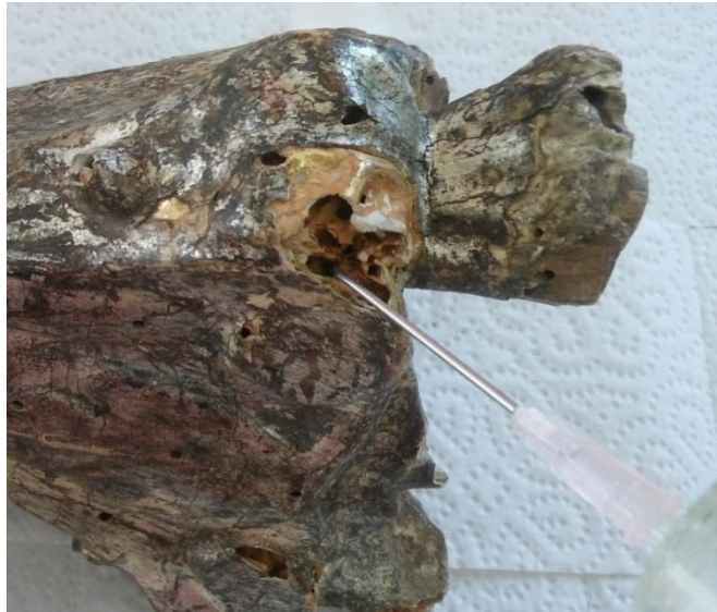
Slika 77. Konsolidacija drvenog nosioca
