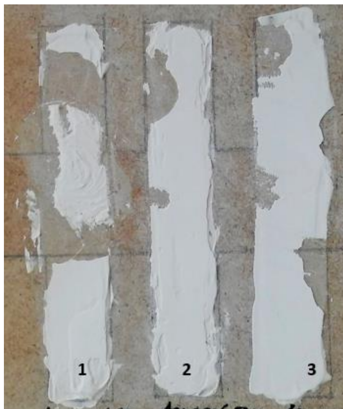
Slika 29. Kitovi s koncentracijom od 7%
