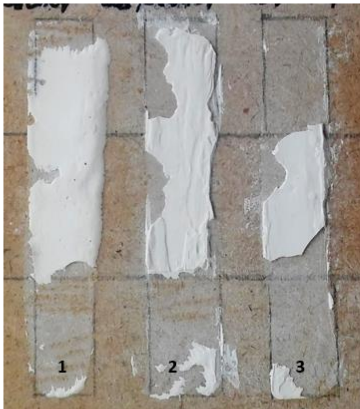
Slika 28. Kitovi s koncentracijom od 6%
