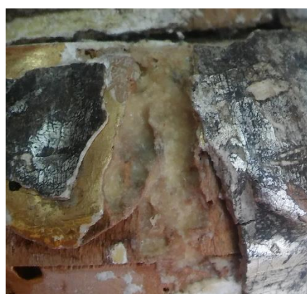
Slika 86. Kit na bazi Paraloida B72
