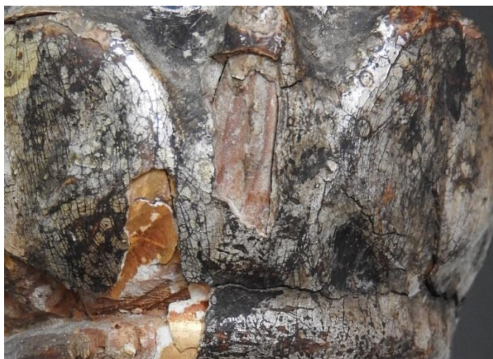
Slika 33. Vidljiv sloj bolusa ispod srebrnih listića
