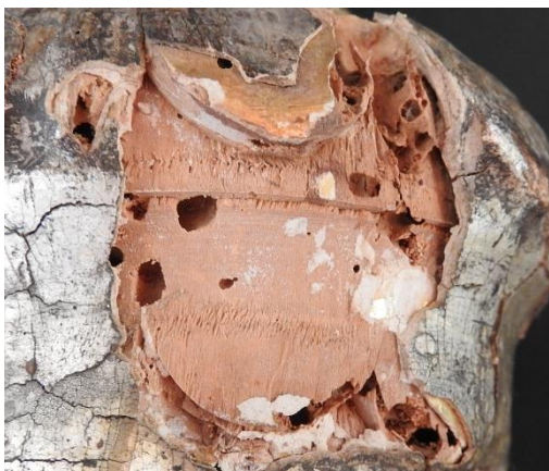
Slika 13. Različiti promjeri izlaznih rupica
