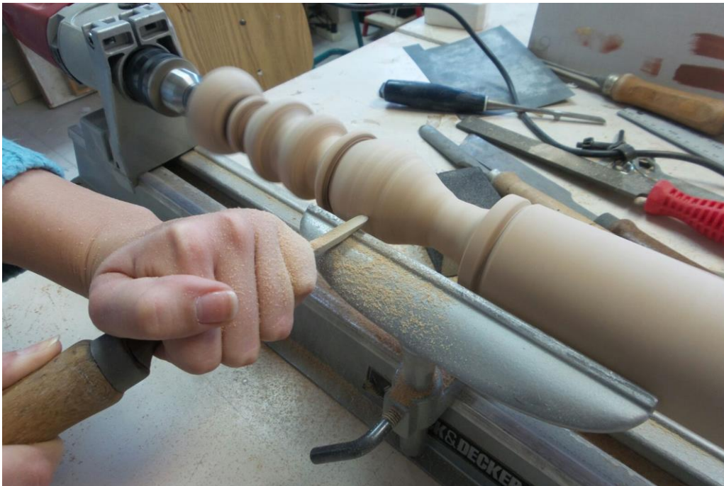
Slika 18. Tokarenje drvenog valjka
