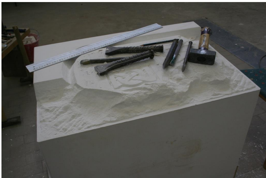
Slika 141. V urez, masa odbijena odbijačem, fotografija: Josipa Krolo
