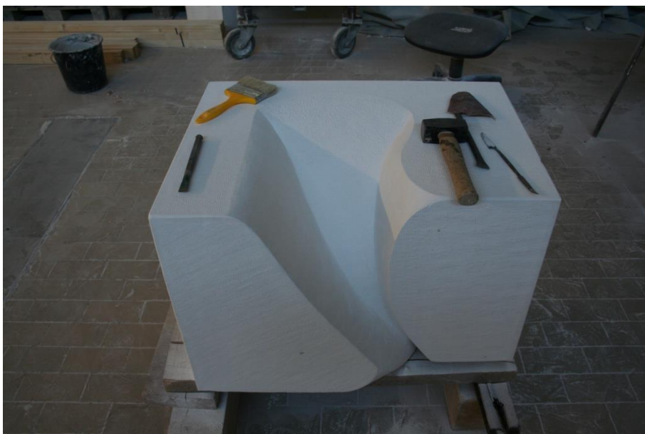
Slika 168. Obrada četvrte strane zupčastim dlijetom, fotografija: Josipa Krolo
