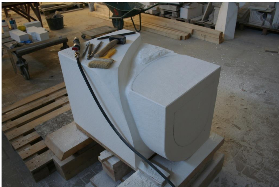
Slika 161. Tragovi ravnog dlijeta na obrubu, tragovi zupčastog dlijeta, tragovi šiljastog dlijeta, fotografija: Josipa Krolo
