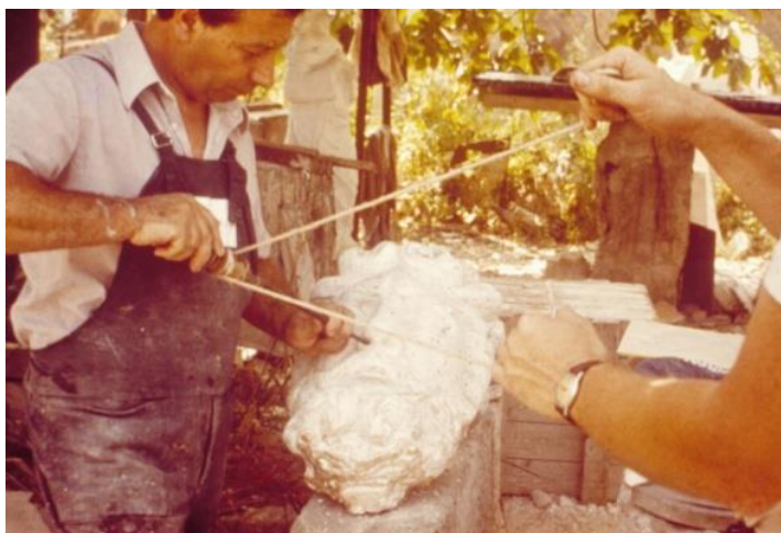
Sl. 70. Uporaba ručne bušilice s užadi, radiona De Tomassi , Rim
