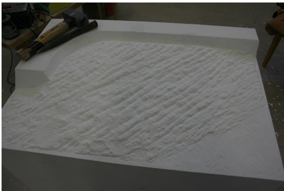
Slika 144. Nastavak skidanja kamene mase šiljastim dlijetom, fotografija: Josipa Krolo
