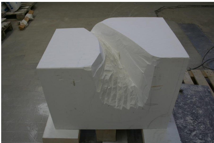
Slika 164. Zapilana kamena masa odlomljena odbijačem, fotografija: Josipa Krolo
