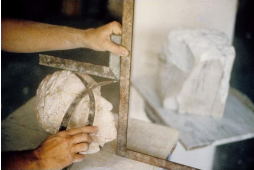
Sl. 83. Šestar za razmjerno povećavanje
