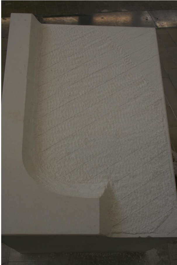
Slika 151. Označavanje olovkom smjerova tragova marteline, fotografija: Josipa Krolo
