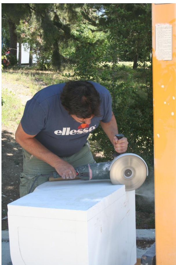
Slika 160. Zapilavanje treće strane kamenog bloka, fotografija: Josipa Krolo
