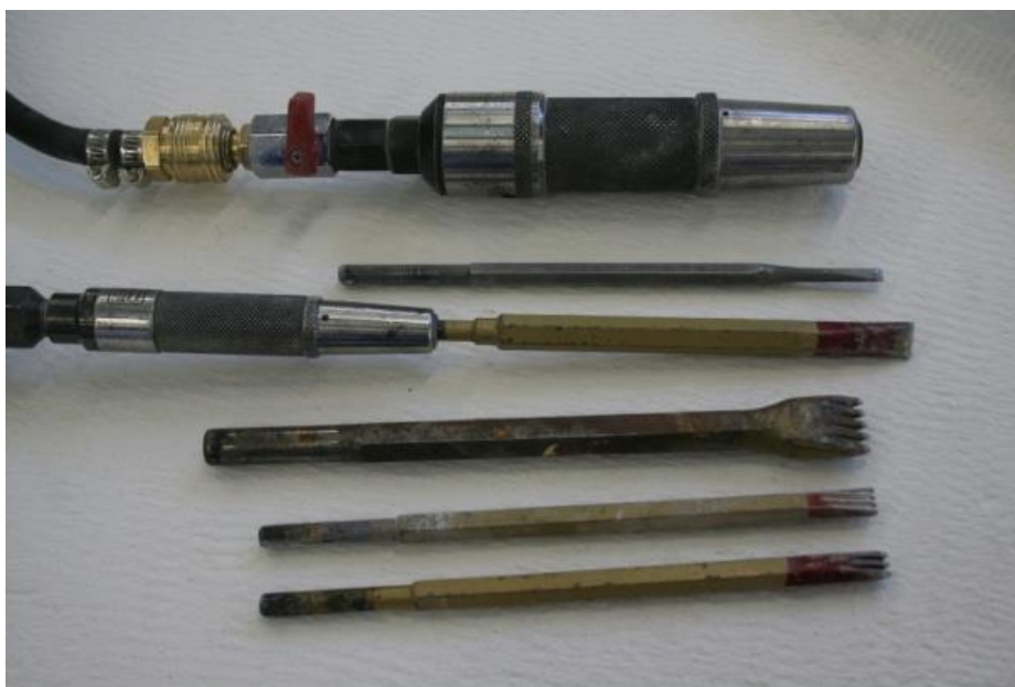
Sl. 80. Zračni čekić i dlijeta za zračni čekić, fotografija: Josipa Krolo
