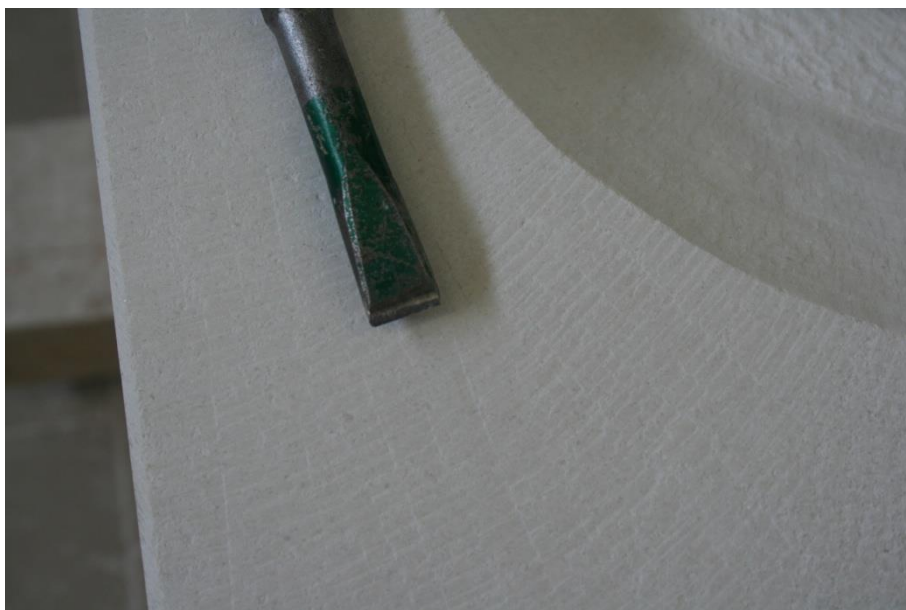
Slika 153. Tragovi ravnog dlijeta, fotografija: Josipa Krolo
