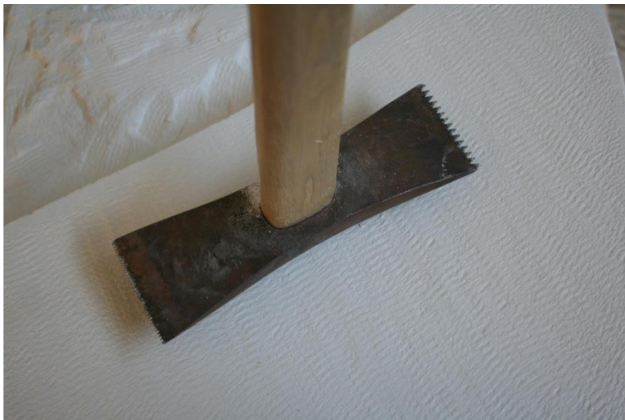
Slika 163. Martelina i tragovi marteline, fotografija: Josipa Krolo
