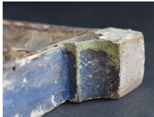
Slika 31 Desni okvir, zatečeno stanje, detalj, kit
