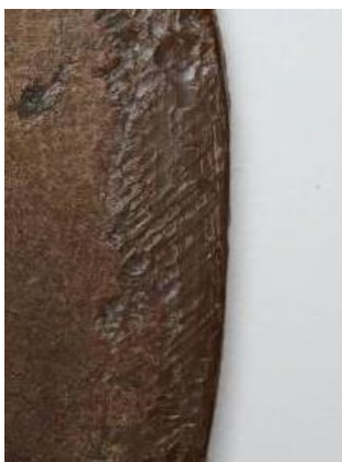
Slika 118 Površina prije uklanjanja voštanog kita skalpelom (detalj)
