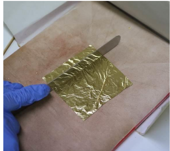
Slika 269 Rezanje zlatnog listića nožem za rezanje pozlate
