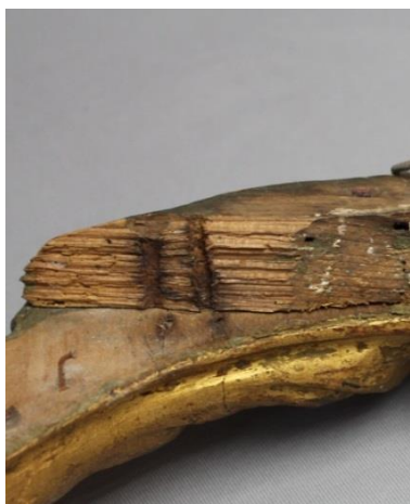
Slika 62 Gornja konstruktivna letvica kojoj nedostaje komad s lijeve strane, detalj
