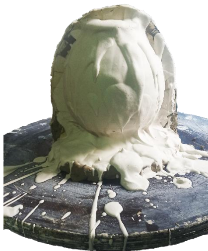
Slika 26. Izrada gipsanog kalupa (foto: M. Marković)
