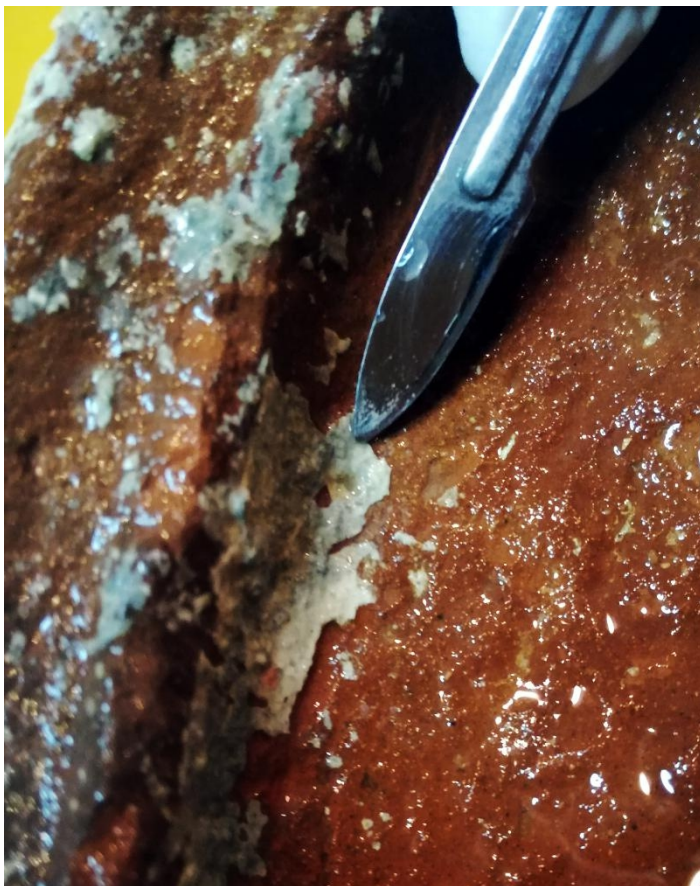
Slika 46. Uklanjanje inkrustacija pomoću skalpela (autor: Tamara Kaličanin, 2020. )
