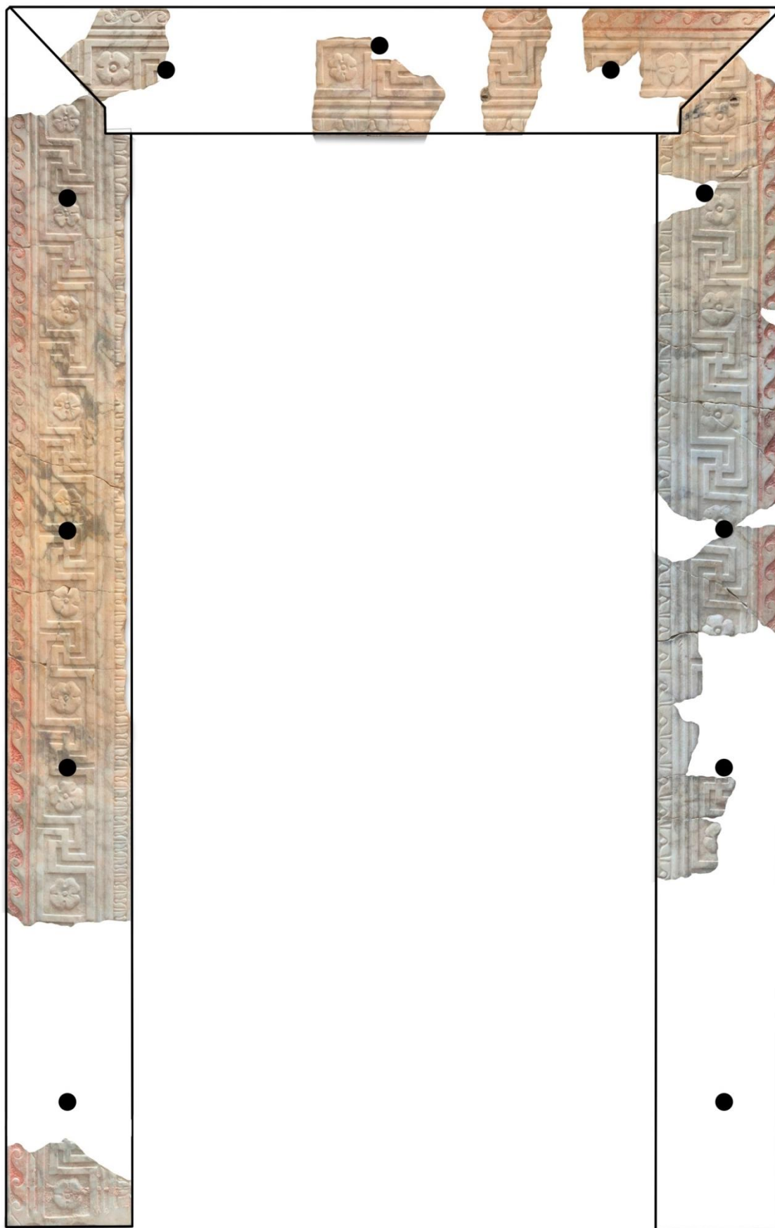
Slika 59: Grafički prikaz točaka spajanja oplata s nosačem (grafički prikaz: A. M. Lučić)
