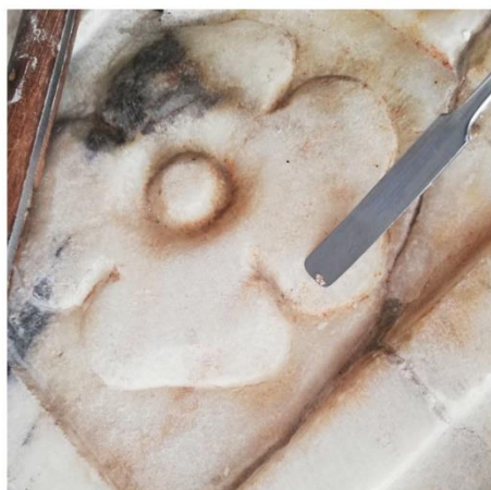
Slika 38: Uzimanje uzoraka bijelog sloja i zona uzorkovanja (foto: A. M. Lučić)
