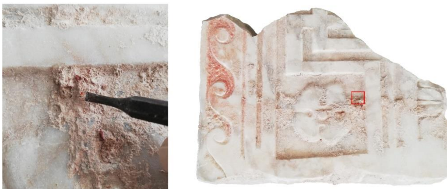
Slika 36: Uzimanje uzoraka žbuke i zona uzorkovanja (foto: A. M. Lučić)
