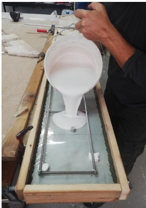
Slika 61: Lijevanje Acrystala (foto: A. M. Lučić)
