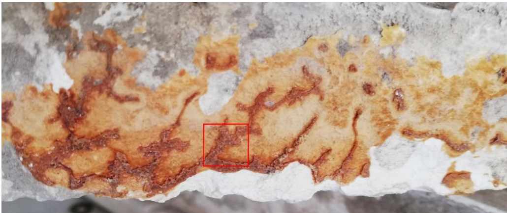
Slika 37: Zona uzorkovanja ljepila s gipsanih rekonstrukcija (foto: A. M. Lučić)
