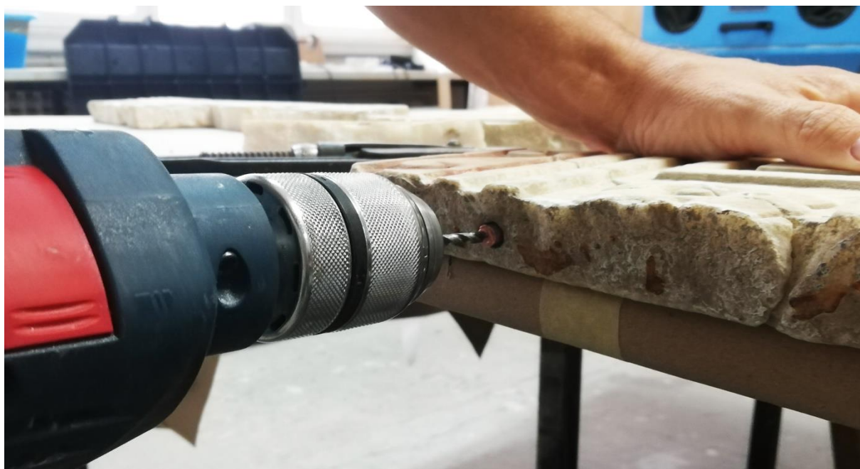
Slika 21: Vađenje brončanog trna (foto: A. M. Lučić)
