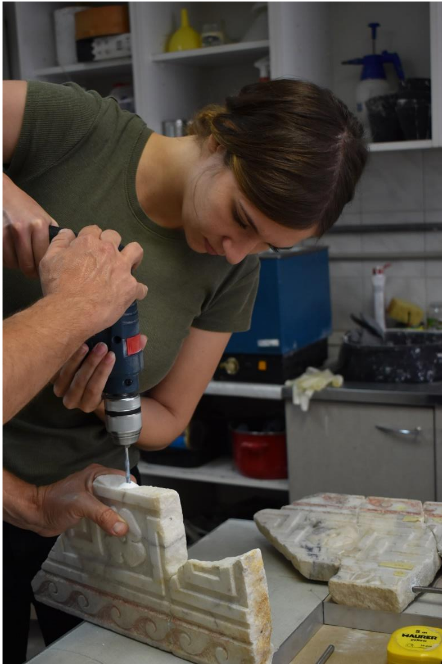
Slika 53: Bušenje mramora (foto: B. Pulić)
