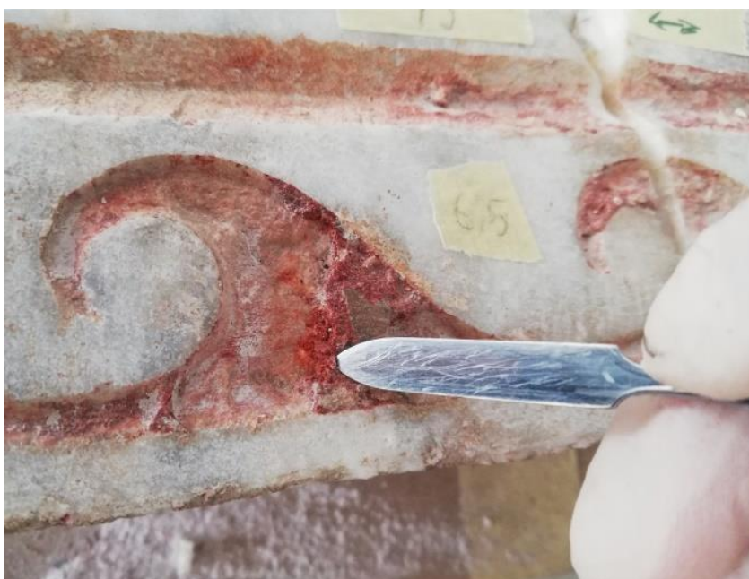
Slika 39: Uzimanje uzorka crvenog pigmenta a) (foto: A. M. Lučić)
