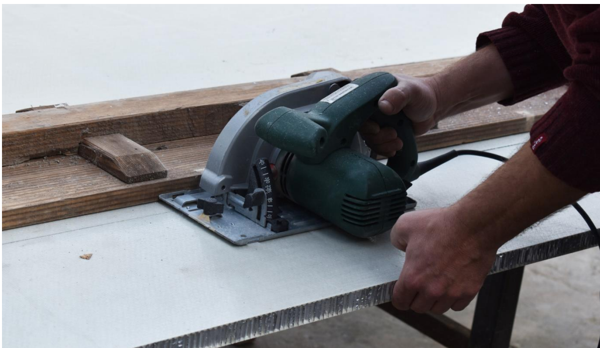
Slika 50: Piljenje aerolama (foto: A. M. Lučić)
