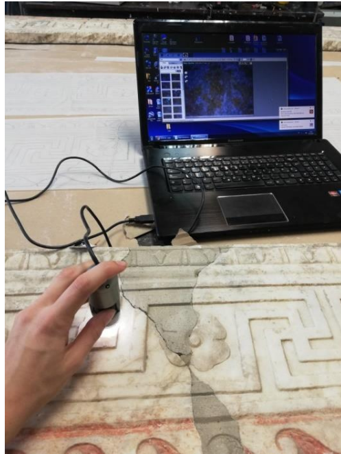
Slika 31: Snimanje Dino-lite mikroskopom (foto: A. M. Lučić)
