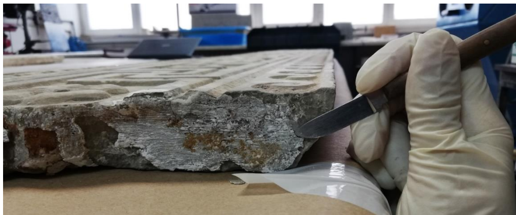
Slika 22: Mehaničko čišćenje ostataka gipsa i ljepljiva (foto: A. M. Lučić)
