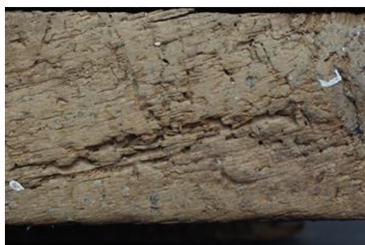
Slika 26: Tragovi djelovanja crvotočine na donjem dijelu većeg postamenta, detalj
