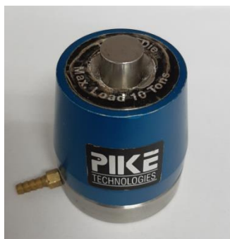
Slika 118: Smjesa uzorka i kalijevog bromida u kalupu
