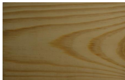
Slika 22: Tangencijalni presjek bora (izvor: diplomski rad, A. Šapina)
