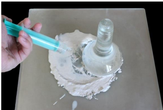
Slika 62: Trvenje kruščića gašenog gipsa uz dodavanje vode
