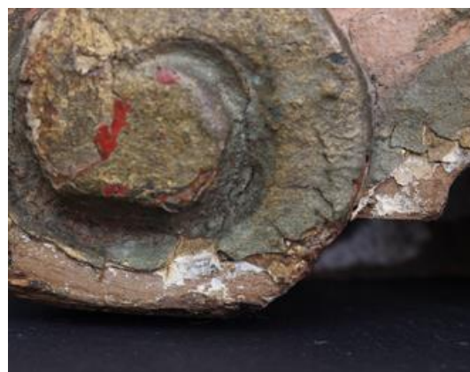
Slika 35: Praškasto osipanje izvorne preparacije, detalj s lica
