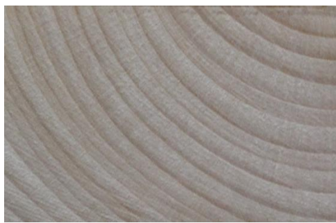
Slika 26: Poprečni presjek drva lipe (snimila K. Strinić)
