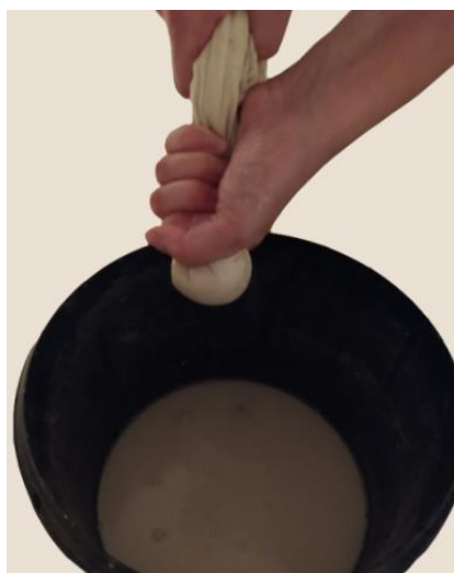
Slika 58: Cijeđenje viška vode iz gašenog gipsa pomoću pamučne krpe
