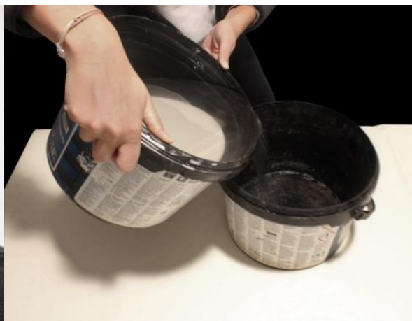
Slika 57: Dekantiranje viška vode iz nataloženog gipsa
