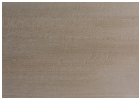
Slika 25: Radijalni presjek drva lipe (snimila K.Strinić)
