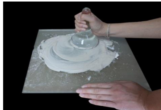
Slika 63: Trvenje gašenog gipsa na staklenoj ploči
