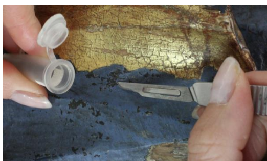
Slika 115: Uzimanje uzorka, struganjem pomoću skalpela
