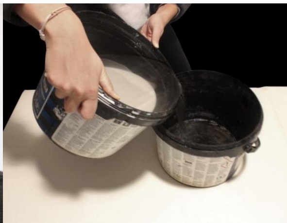
Slika 57: Dekantiranje viška vode iz nataloženog gipsa
