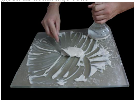
Slika 64: Sakupljanje gašenog gipsa špatulicom
