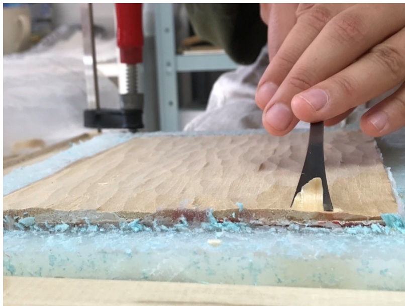
Slika 92 Uklanjanje drva dlijetom s probne daščice A
