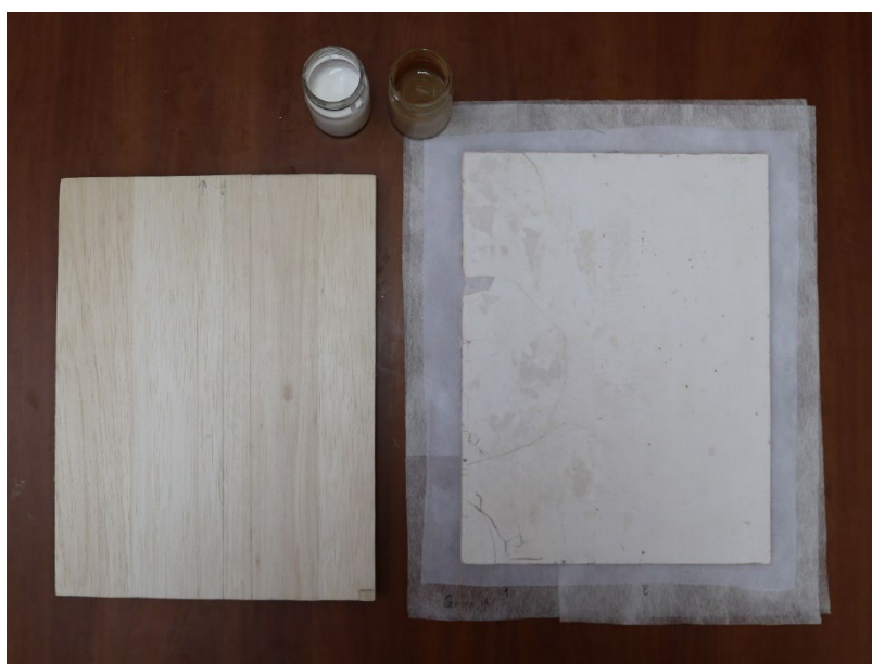
Slika 59 Novi nositelj (lijevo) i slikani sloj (desno) prije lijepljenja
