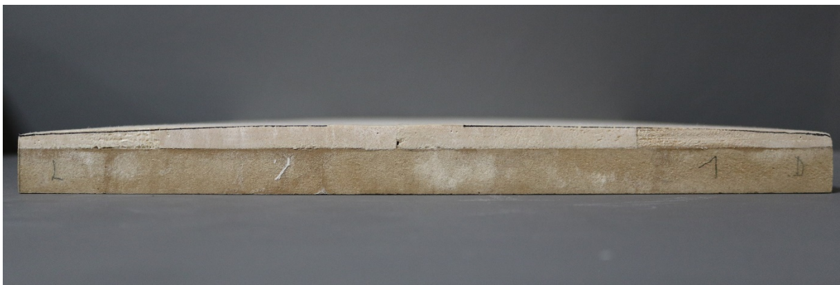
Slika 57 Novi nositelj nakon brušenja koje je provedeno kako bi se dobila konveksna forma karakteristična za slike na drvu
