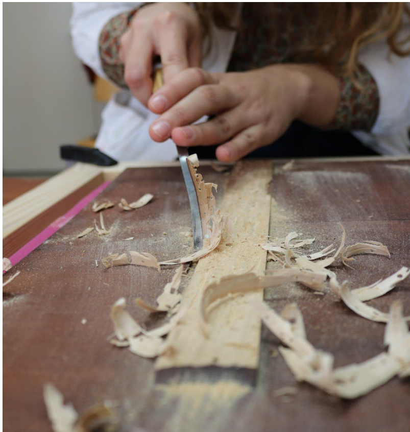
Slika 17 Uklanjanje poprečnih letvi s dlijetom
