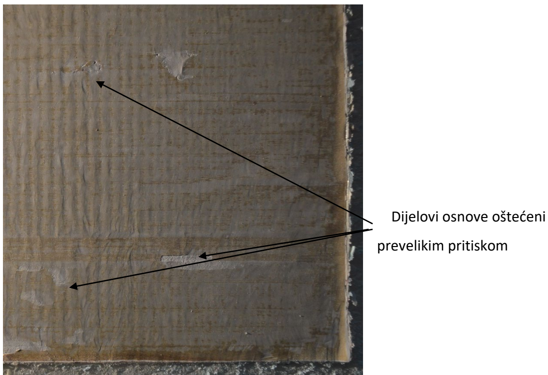
Slika 101 Dijelovi osnove oštećeni prevelikim pritiskom alata na osnovu
