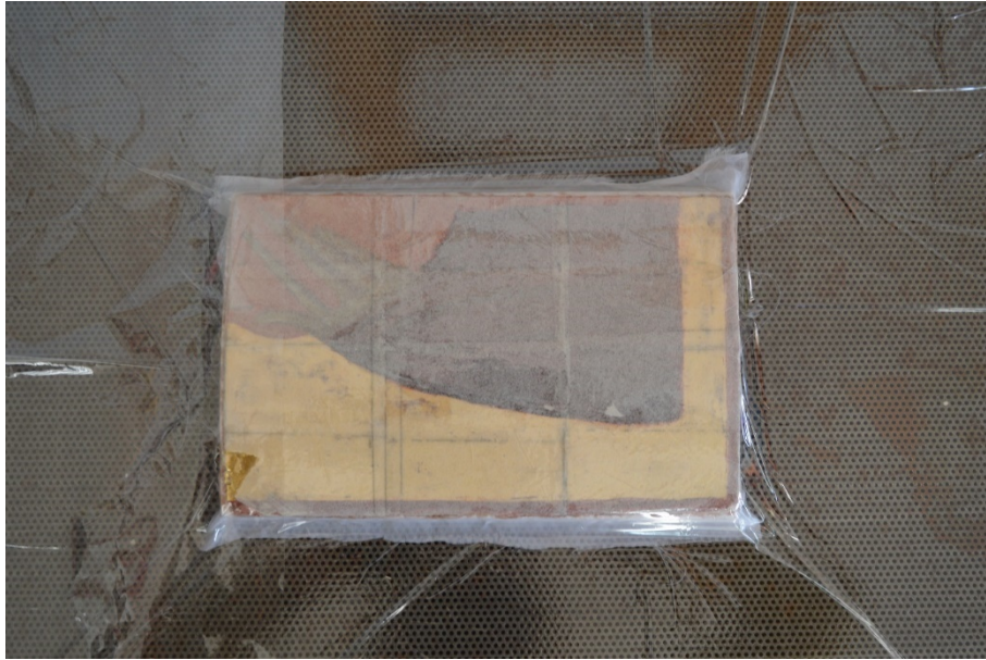
Slika 112 Sušenje probe A na niskotlačnom stolu
