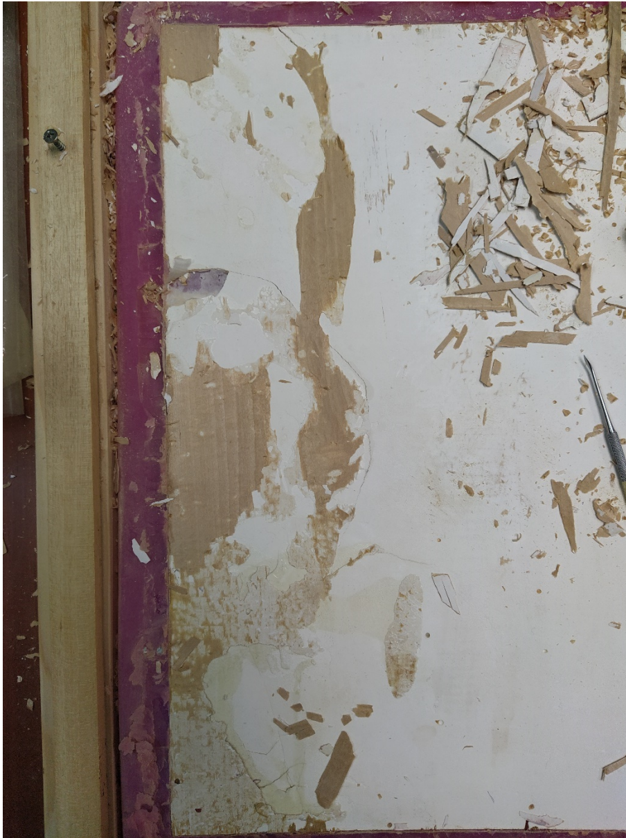
Slika 25 dijelovi koji su bili teže uklonjivi zbog PVA ljepila
