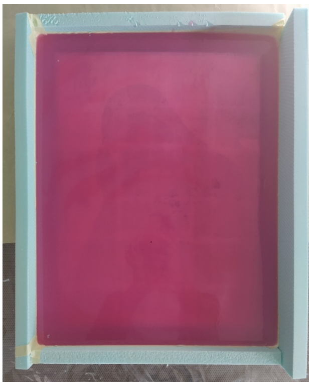
Slika 13 Izgled slike nakon izljevanja silikona
