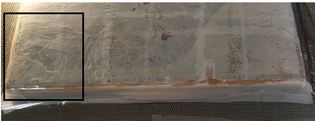
Slika 67 Potklobučenje nakon sušenja
