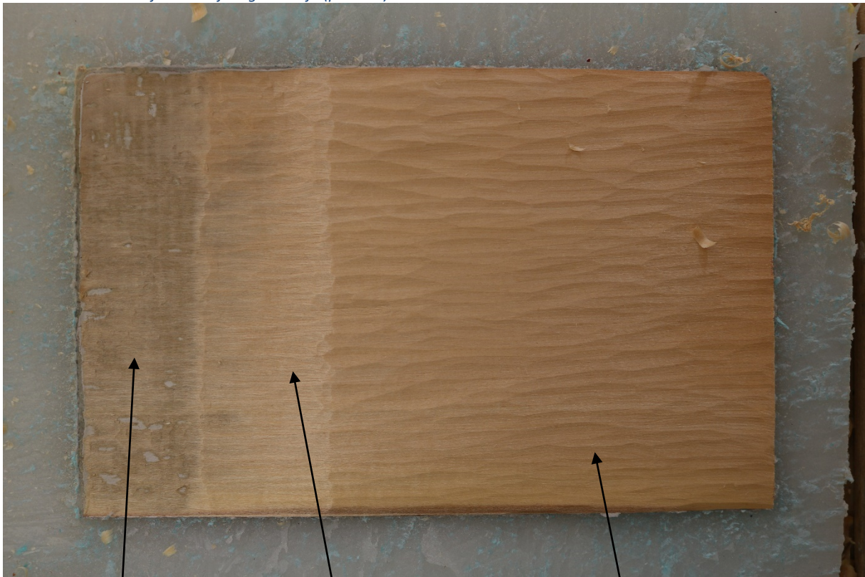
Slika 93 Različite debljine uklonjenog nositelja (proba A)
