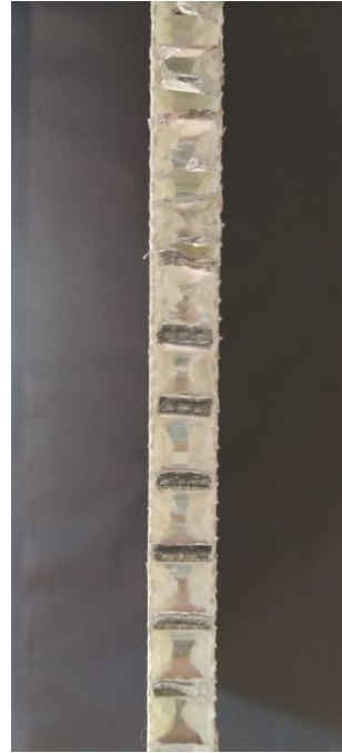
Slika 108 Presjek aluminijskih saća
