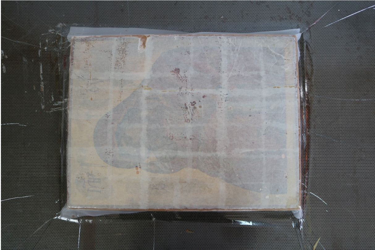
Slika 63 Sušenje na niskotlačnom stolu
