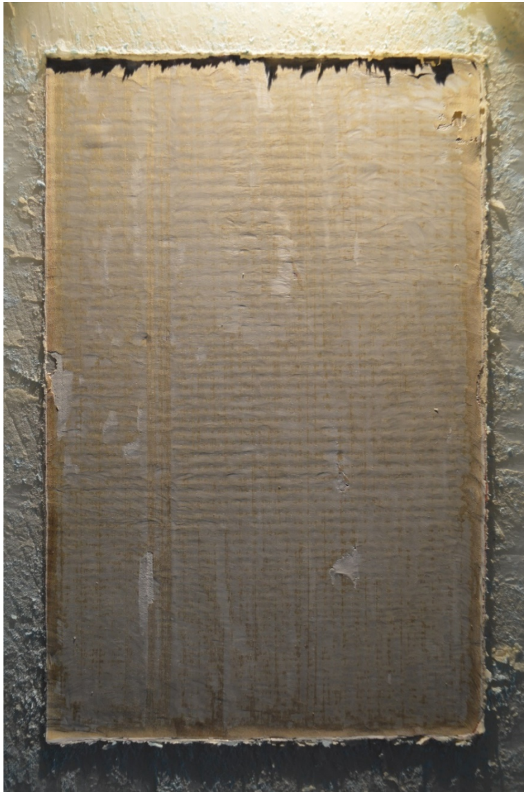
Slika 103 Poleđina osnove na probi A nakon uklanjanja drvenog nositelja
