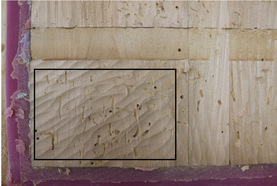
Slika 20 Dio nositelja na kojem se drvo uklanjalo pod kutom od 45° u odnosu na smjer vlakana
