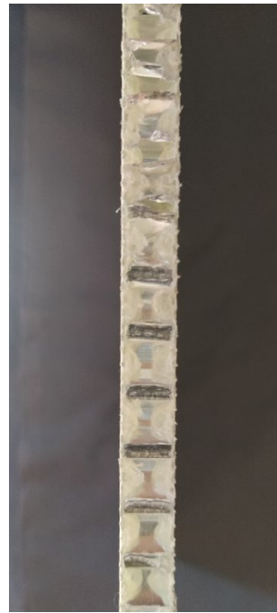
Slika 108 Presjek aluminijskih saća
