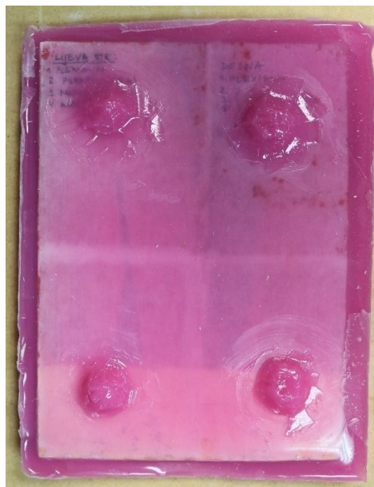
Slika 91 Izbočenja na probi B
