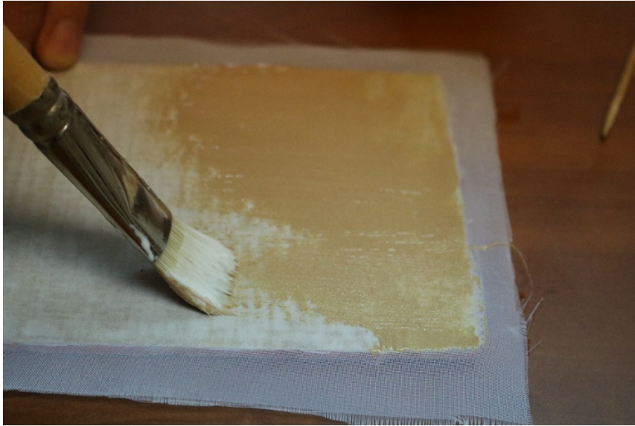
Slika 117 Nanošenje PVA ljepila razrijeđenog vodom i s dodatkom mikrobalona (utvrđeni dobri omjeri) na poleđinu probe C
