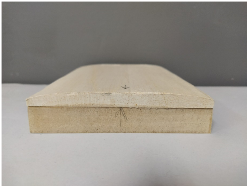
Slika 106 Novi nositelj za probu A izrađen od medijapana i balze koja je potom izbrušena kako bi se dobila zakrivljenost karakteristična za slike na drvu
