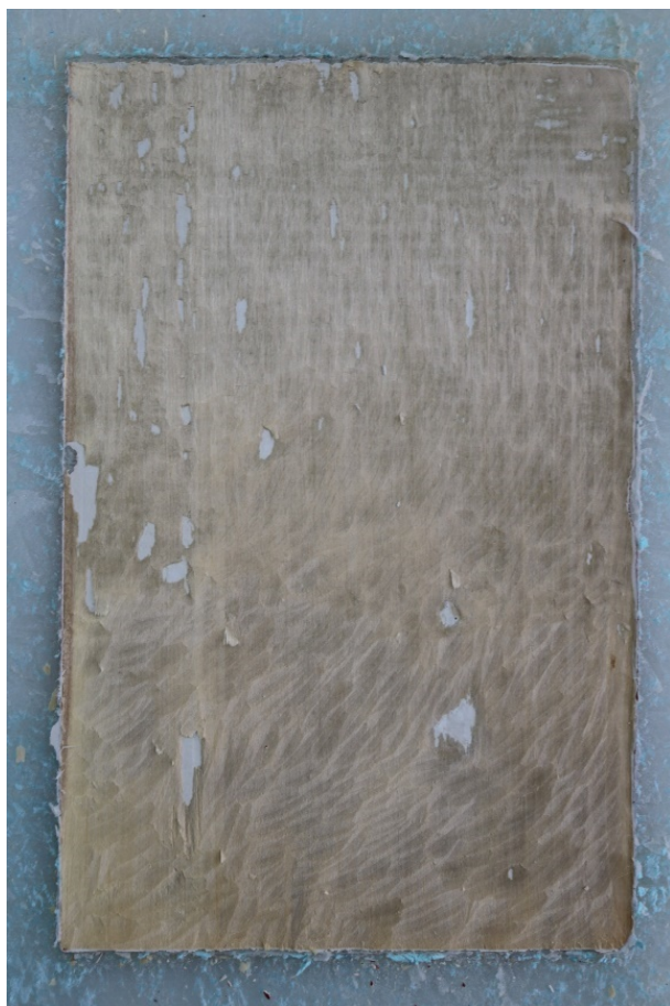
Slika 94 Nositelj stanjen na debljinu manju od pola milimetra
