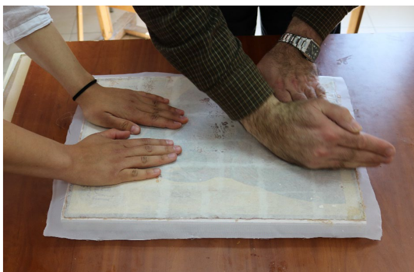
Slika 62 Istiskivanje viška ljepljive prema rubovima
