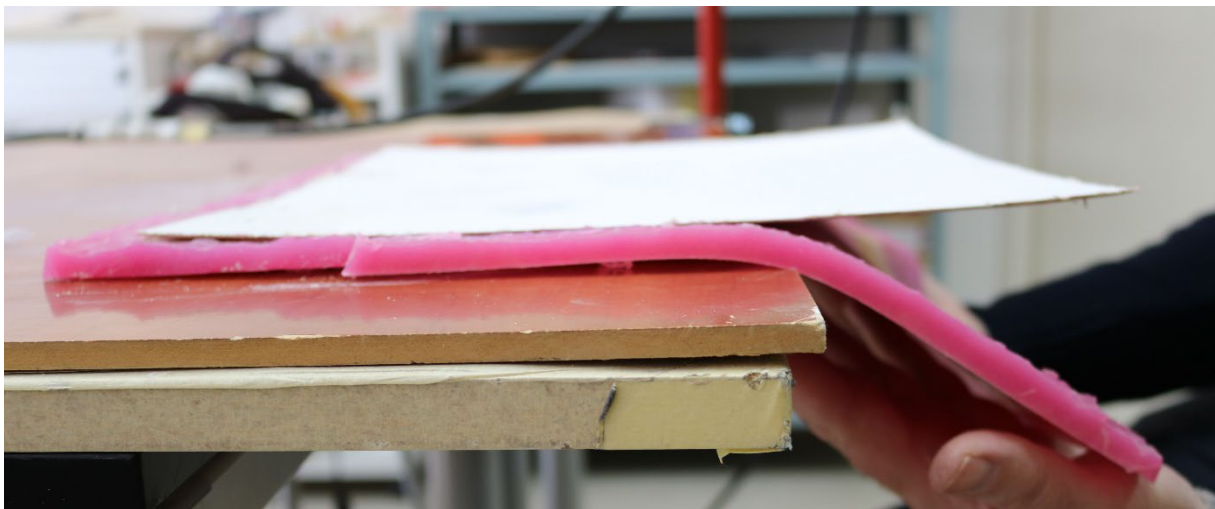
Slika 44 Odvajanje slikanog sloja od silikonskog kalupa
