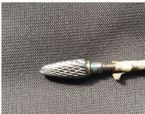
Slika 95 Nastavak stožastog oblika
