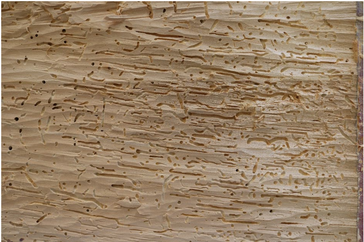
Slika 34 Detalj kanalića crvotočine
