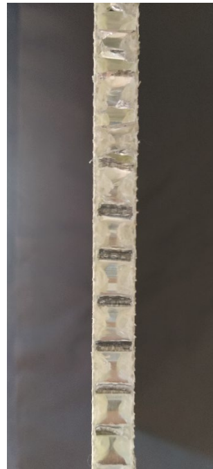
Slika 108 Presjek aluminijskih saća
