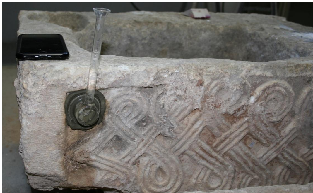
Slika 103. Mjerenje vodoupojnosti, fotografija: Martin Zohil
