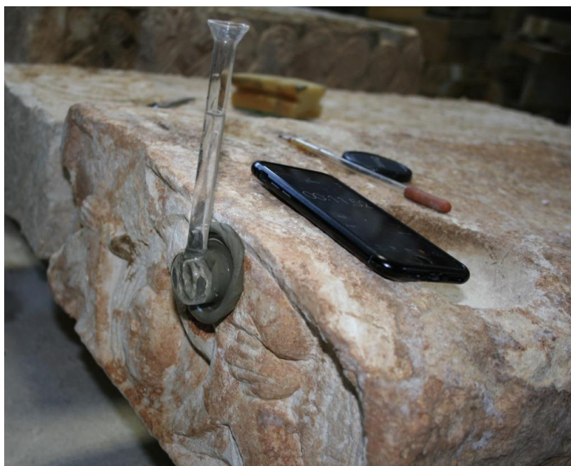
Slika 80. Mjerenje vodoupojnosti, fotografija: Martin Zohil
