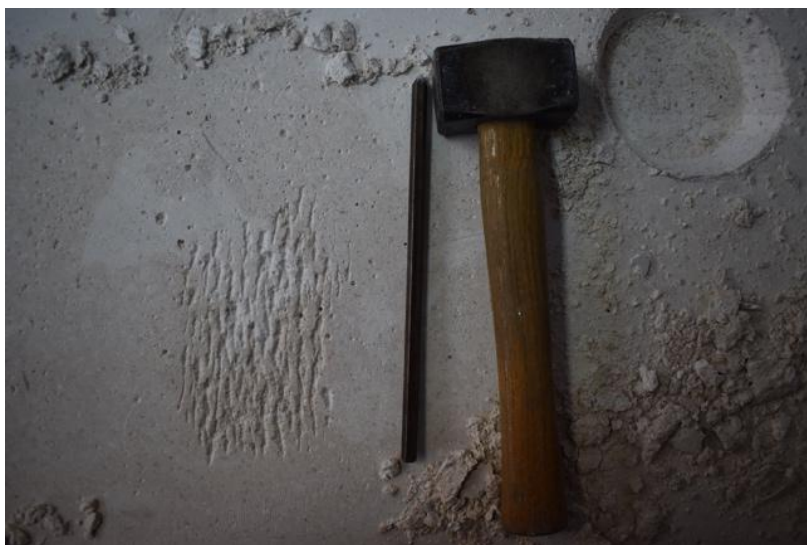
Slika 120. Klesanje poledine, fotografija: Martin Zohil
