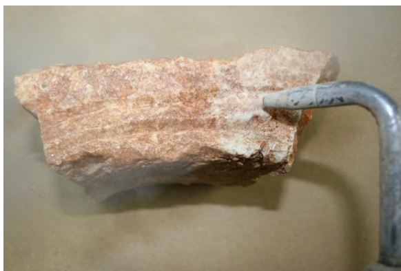
Slika 20. Proba čišćenja vodenom parom, fotografija: Martin Zohil
