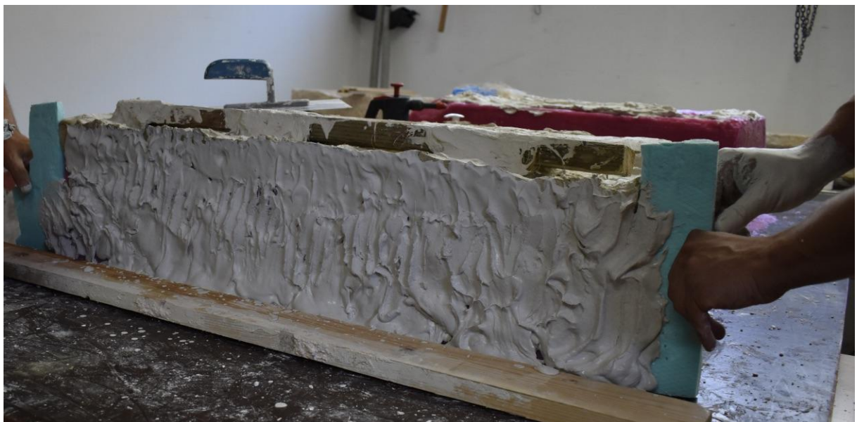
Slika 113. Izrada gipsane kape, fotografija: Martin Zohil
