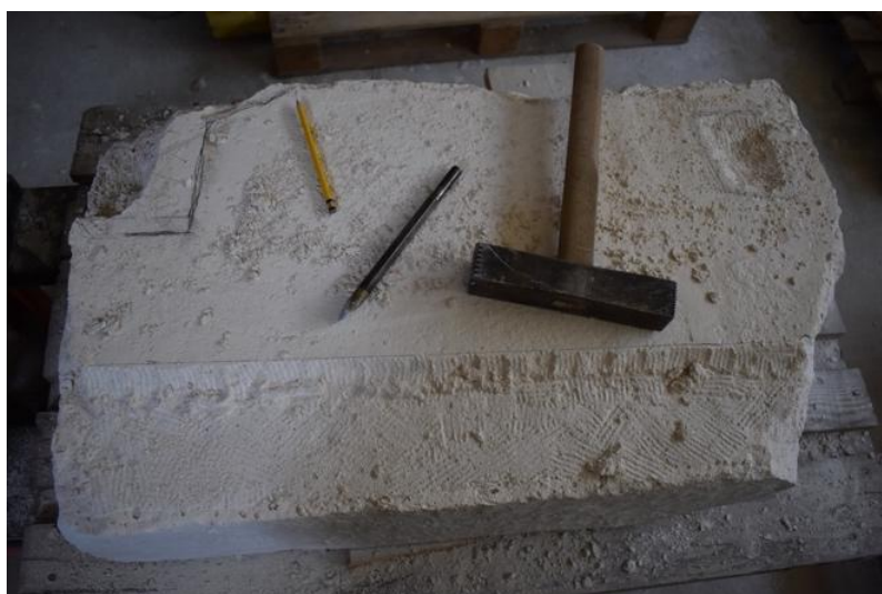
Slika 121. Klesanje poledine, fotografija: Martin Zohi
