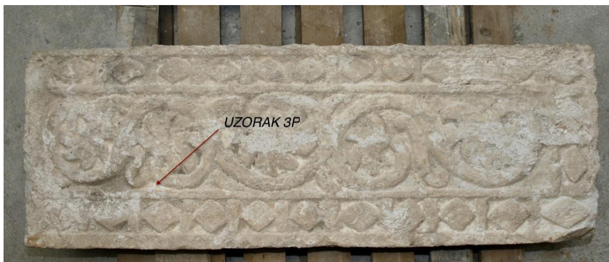
Slika 55. Uzorkovanje uzorka za ftir, fotografija: Martin Zohil
