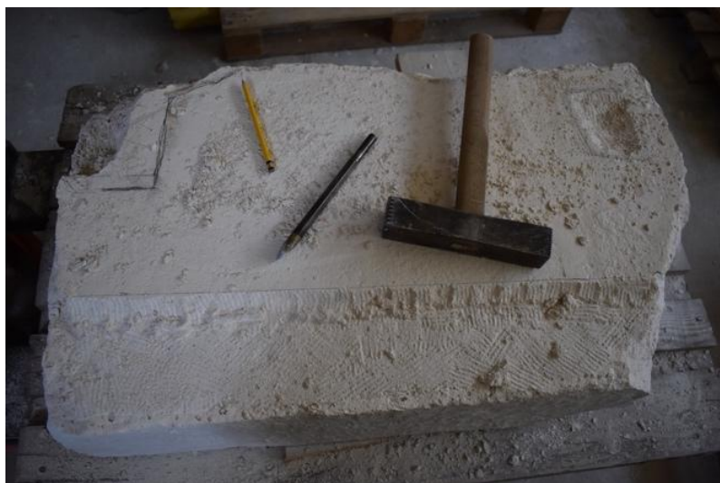
Slika 121. Klesanje poledine, fotografija: Martin Zohi
