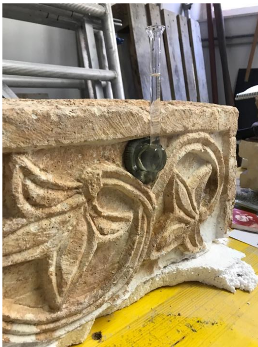
Slika 41. Mjerenje vodoupojnosti, fotografija: Martin Zohil
