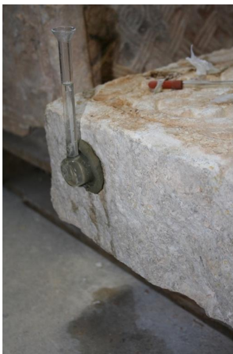
Slika 61. Mjerenje vodoupojnosti, fotografija: Martin Zohil
