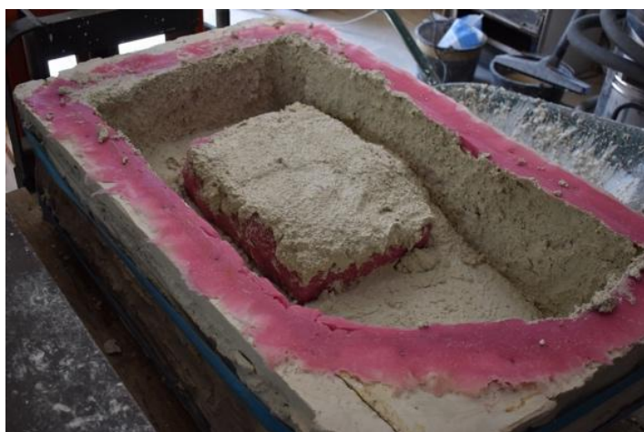
Slika 116. Izrada replike ulomka nepoznate nemajene
