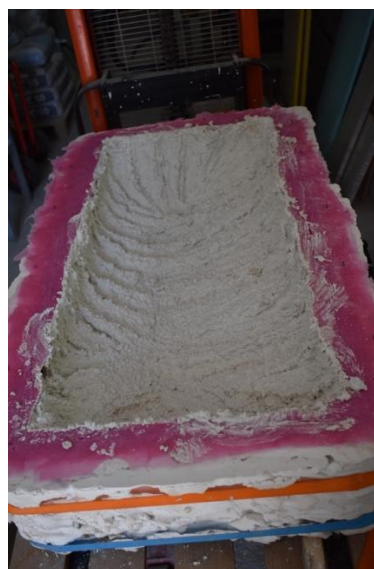
Slika 117. Izrada replike imposta s prikazom sirene
