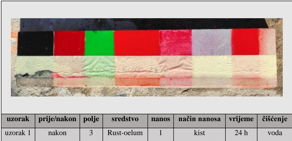
Tablica 9. Uzorak 1. Nakon čišćenja prvog nanosa sredstva Rust-oleum.
