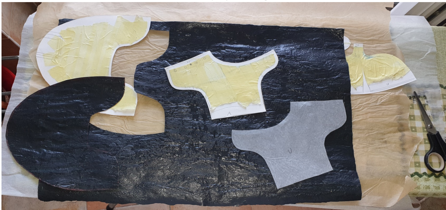
Slika 29. Rezanje segmenata za cipelu
