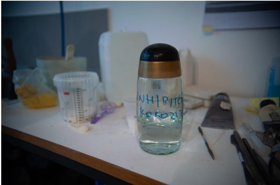
Slika 47 Inhibitor za koroziju (autor: Rina Dubravec)
