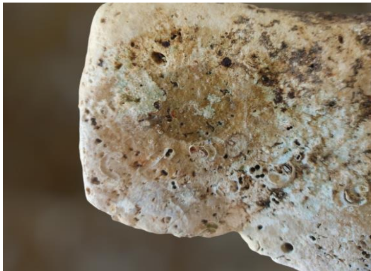
Slika 15. Otisak mjerenja vodoupojnosti kamena pomoću karstenovog cilindra
