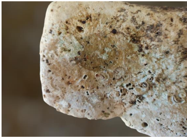
Slika 15. Otisak mjerenja vodoupojnosti kamena pomoću karstenovog cilindra
