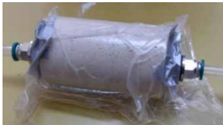
Slika 9. Uzorci konsolidirani u plastičnoj foliji (Ante Jureškin, svibanj 2011.)
