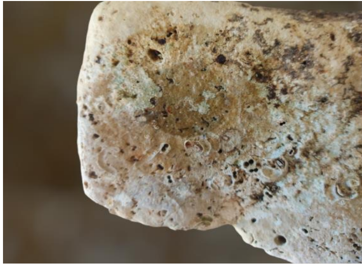
Slika 15. Otisak mjerenja vodoupojnosti kamena pomoću karstenovog cilindra
