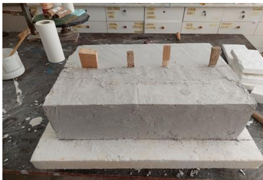
Slika 40, Odvajanje gipsane kape uz pomoć drvenih klinova
