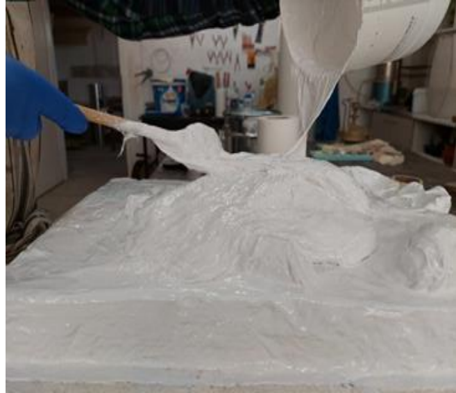
Slika 36, Nanošenje drugog sloja gume
