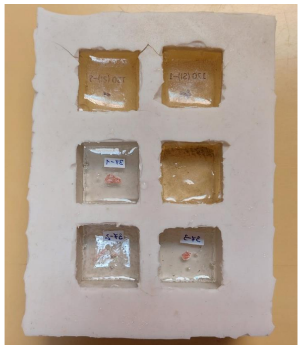
Slika 14, Uzorci u poliesterskoj smoli
