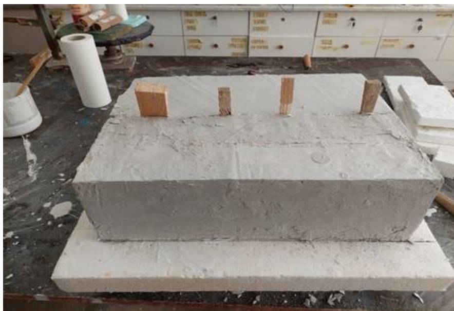
Slika 40, Odvajanje gipsane kape uz pomoć drvenih klinova
